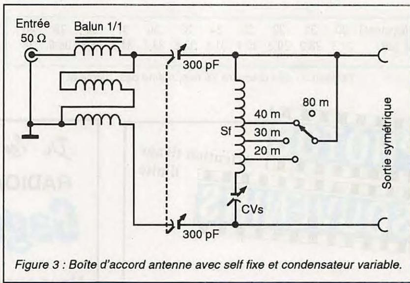
Figure 3 : Boîte d'accord antenne avec self fixe et condensateur variable.
