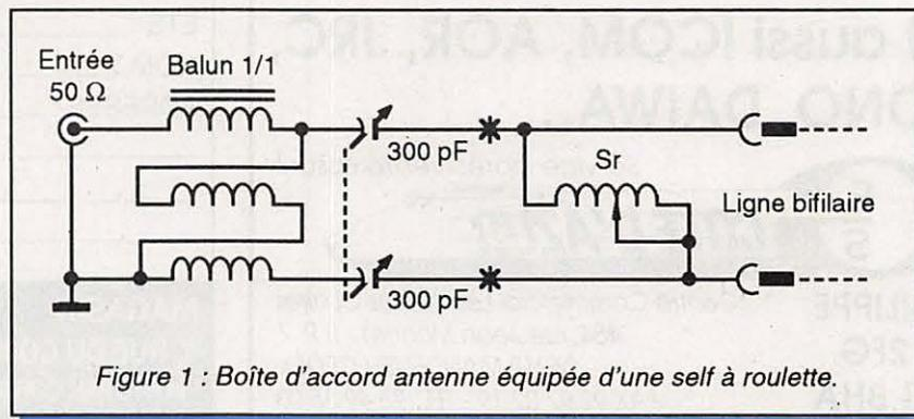
Figure 1 : Boîte d'accord antenne équipée d'une self à roulette.
