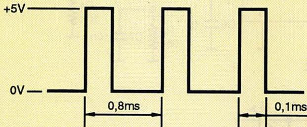
Figure 10 : Signal sur la broche 28 du MC145151.
