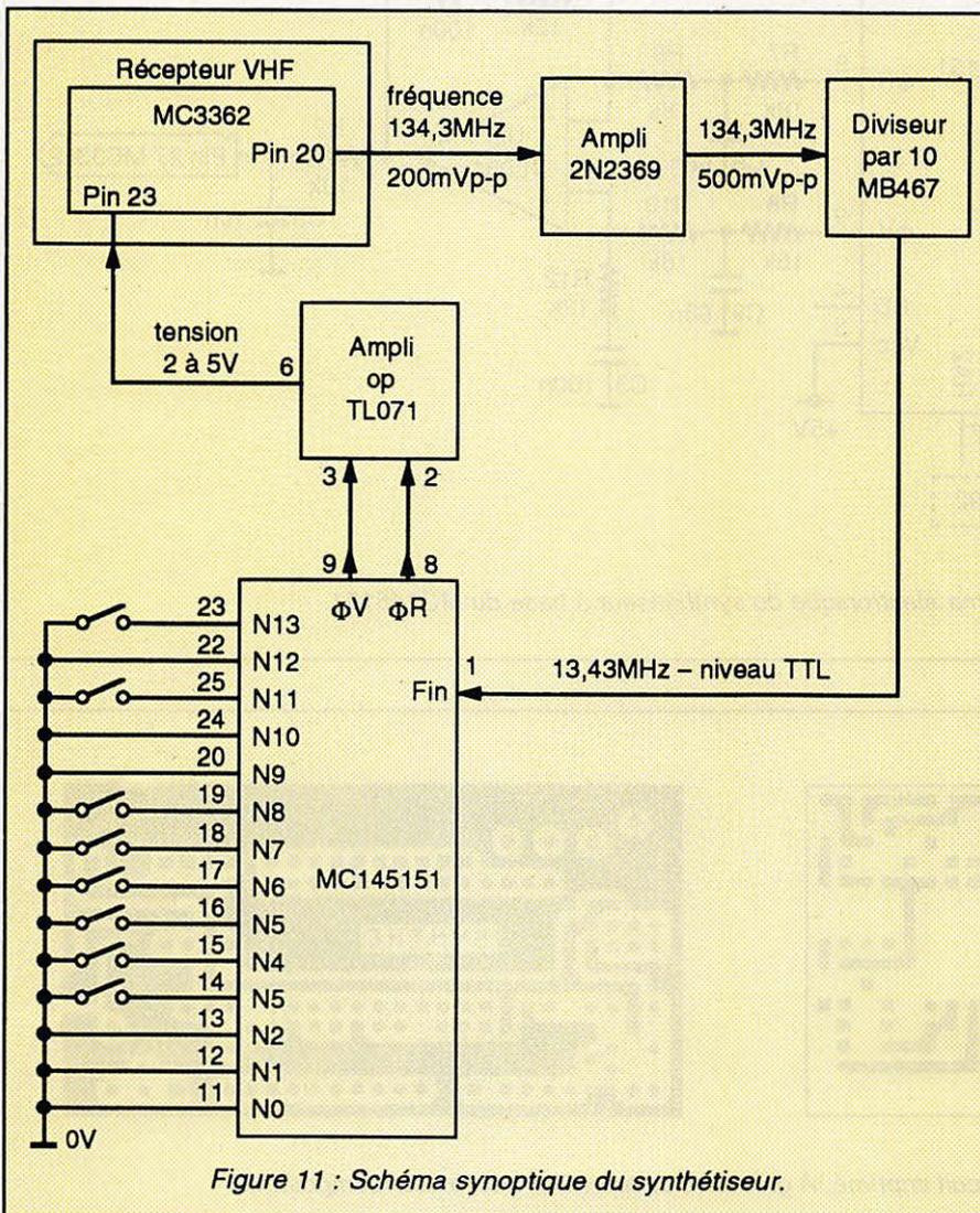
Figure 11 : Schéma synoptique du synthétiseur.
