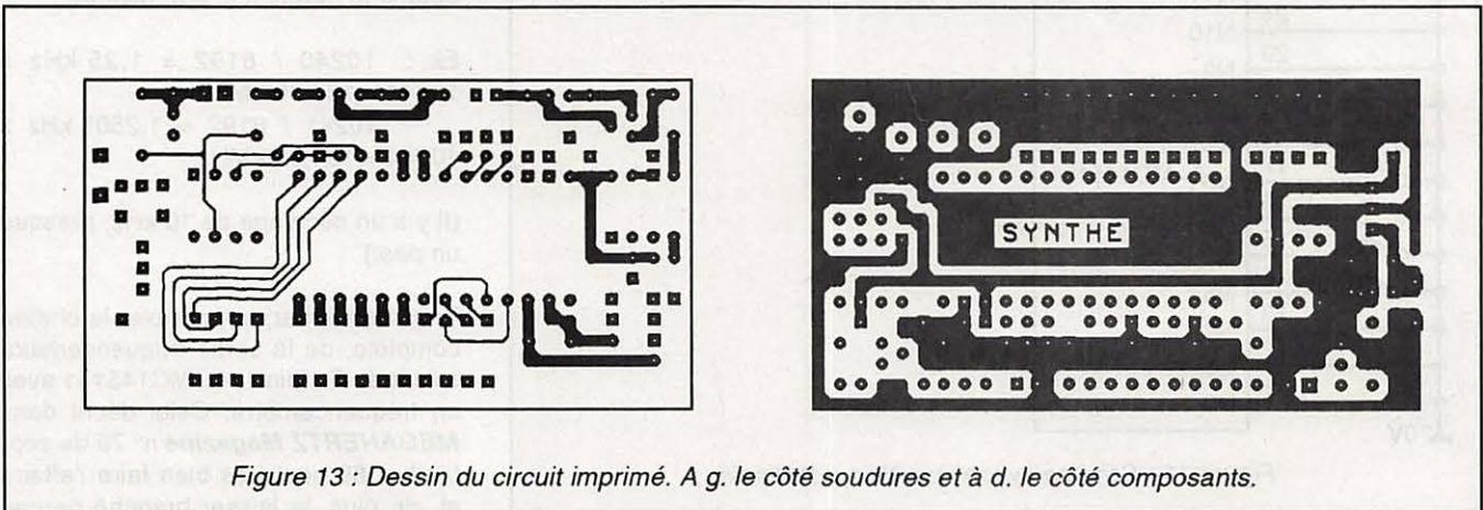
Figure 13 : Dessin du circuit imprimé. A g. le côté soudures et à d. le côté composants.
