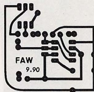
Figure 4 : Le CI, côté soudures, du module d'adaptation.
