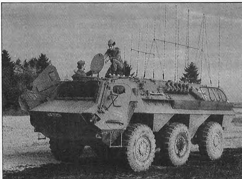
*Brouilleur VHF installé sur un véhicule blindé.*
