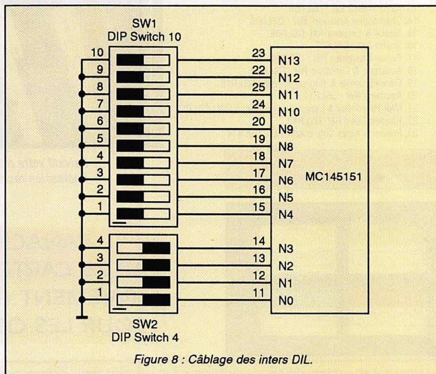
Figure 8 : Câblage des inter-DIL.
