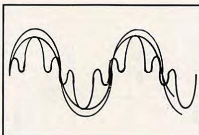
Le potentiomètre d'équilibrage doit être placé au milieu de sa course. On connecte l'alimentation et on branche un oscilloscope à la sortie.
