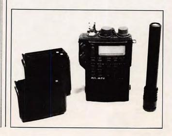
La puissance émission est de 1 W, avec une position 0,35 W. Muni d'un pack batterie optionnel de forte puissance, ou alimenté sous 12 V, il délivre alors 5 W.
