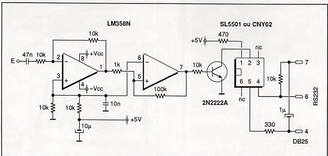
pour améliorer les résultats obtenus avec ICS FAX sur PC, la sortie du signal vers l'ordinateur se fait sur le point 6 de la RS-232 (DSR), le point 4 étant le RTS et le 7 la masse (connecteur DB 25).
