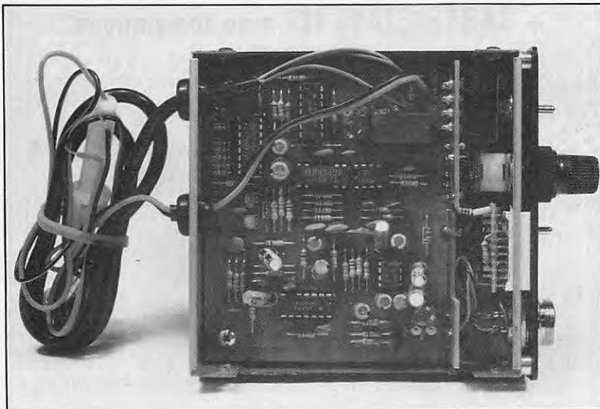
(écouteur) assure un réglage correct de l'écho, en durée comme en niveau. Lorsque le l'interrupteur est sur OFF, le circuit microphonique est direct.
