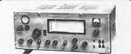
**RÉCEPTEUR DE TRAFIC AME 7G-1680.** Superhétérodyne à double changement de fréquence, couvre de 1,7 à 40 MHz en 7 gammes, sensibilité 1 µV - BFO puissant et très stable pour recevoir la BLU - S/mètre et HP incorporés. Alim. secteur 110/220 V. Dimensions : 400 x 800 x 300 mm. Poids : 65 kg. Livré en parfait état de fonctionnement avec sa notice technique. Prix .....2500,00 F
