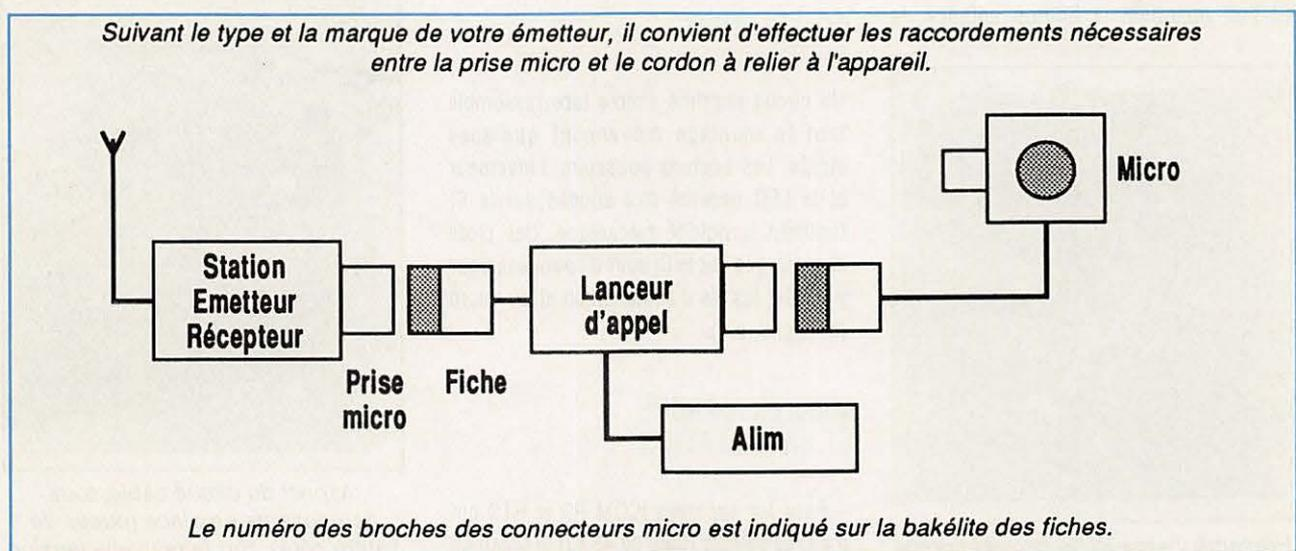
Raccordement à l'émetteur-récepteur.
