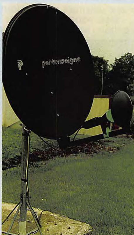
Parabole dite "grégorienne". Le rendement
