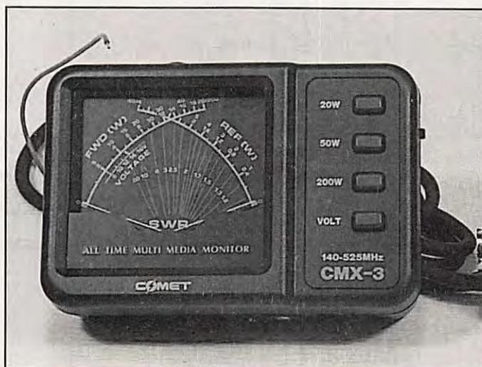
terminé par un couple fiche et prise DIN. La mesure est assurée par un large galvanomètre à aiguilles croisées. L'échelle de gauche indique la puissance directe (FWD), celle de droite la puissance réfléchie (REF). L'échelle de mesure de tension est un arc de cercle placé sous l'échelle FWD. Au centre du galva, des lignes rouges et vertes servent de repères pour la mesure du TOS.
