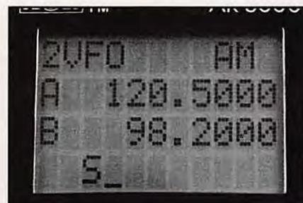
fréquence affichée, 5 pas au dessus et 5 pas en dessous. Mais ce "band-scope" ne fonctionne qu'en mode VFO et ne peut être utilisé en mode mémoire. L'intérêt est évident : on peut déceler, dans ce mode, la présence d'émissions non repérées auparavant. Vous écoutez 77.300 MHz et vous remarquez, tout à coup, une raie deux segments plus bas. Il ne vous restera plus qu'à vous régler et à veiller sur cette fréquence (à calculer en fonction du pas sélectionné) pour identifier la station...
