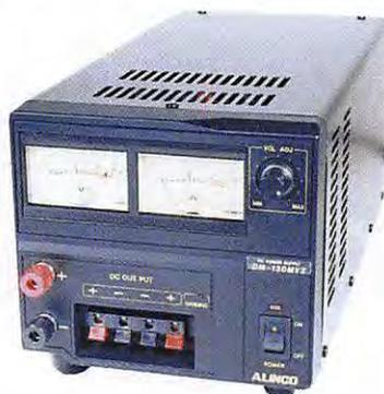
contrôles sont confiés à un volt-mètre et un ampèremètre. Les sorties sont prélevées sur un double bornier ou des douilles. Une LED "Warning" signale toute anomalie de fonctionnement, quand la tension atteint 18 V. Il faut alors songer à débrancher les appareils qui lui sont reliés ! La ventilation mécanique est déclenchée automatiquement (vu chez Euro Communication Equipements).
