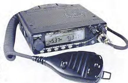
sée de l'appareil et placée à portée de main (prévoir le kit optionnel). Il couvre de 144 à 146 MHz et de 430 à 440 MHz. Les réglages de volume et de squelch sont séparés pour les deux bandes. La puissance de sortie, réglable en trois niveaux, atteint 50 W en 145 MHz et 35 W en 435 MHz. La sortie antenne est unique (duplexeur interne). Livré avec son micro, il n'attend plus qu'une alimentation capable de fournir 12 A pour fonctionner... (vu chez Euro Communication Equipements).
