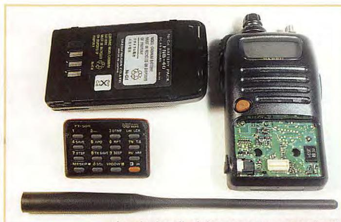
Le clavier d'origine peut être remplacé par l'option FTT-12.
