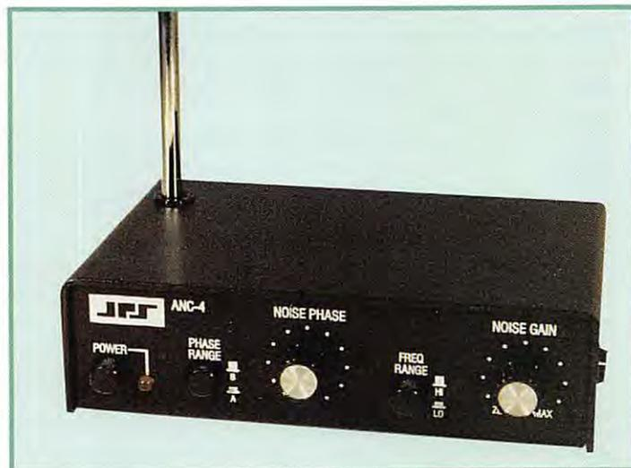
**Comment supprimer (ou réduire fortement) le bruit d'une ligne haute tension, ou toute autre source locale de parasites ? Avec un circuit HF qui compare le signal reçu par l'antenne principale de la station à celui d'une petite antenne annexe. Ensuite, on déphase de 180° et le tour est joué !**
