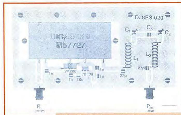
**Fig. 7 : Emplacement des composants de l'ampli hybride.**
