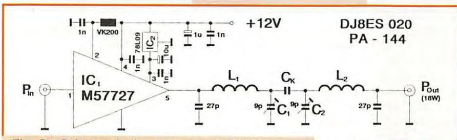
Fig. 2 : Schéma de l'amplificateur hybride pour le 144 MHz.
