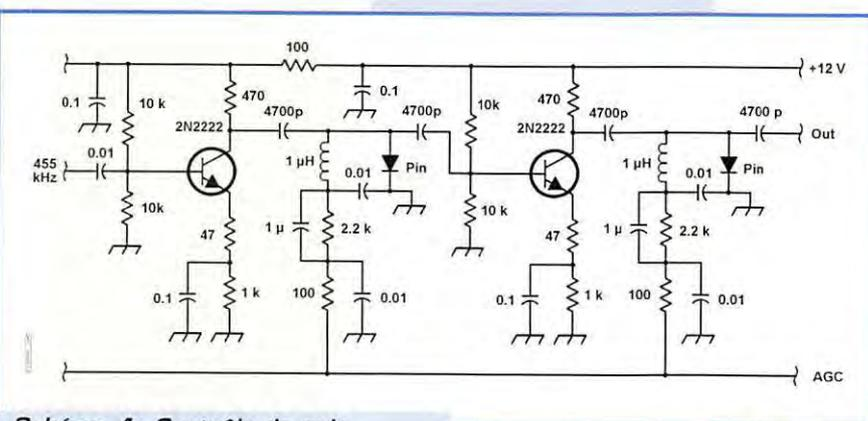
**Schéma 4 :** Contrôle de gain par diodes PIN.
