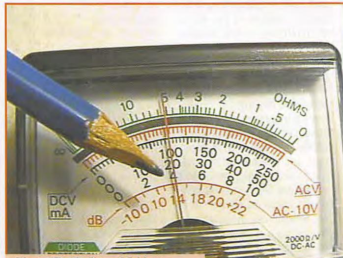
Photo 5 - Calibre 10 V on mesure 4 V.
