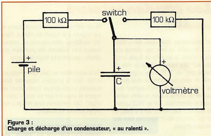
Figure 3 : Charge et décharge d'un condensateur, « au ralenti ».
