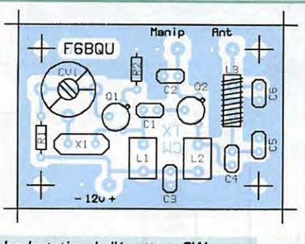
Implantation de l'émetteur CW décamétrique simple 0,5 W.
