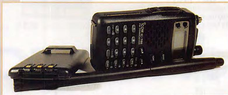
**ICOM présente l'IC-T8E, un portatif FM original, permettant d'émettre et recevoir sur 144 et 430 MHz, d'écouter le 50 MHz et la bande FM radiodiffusion entre 88 et 108 MHz.**
