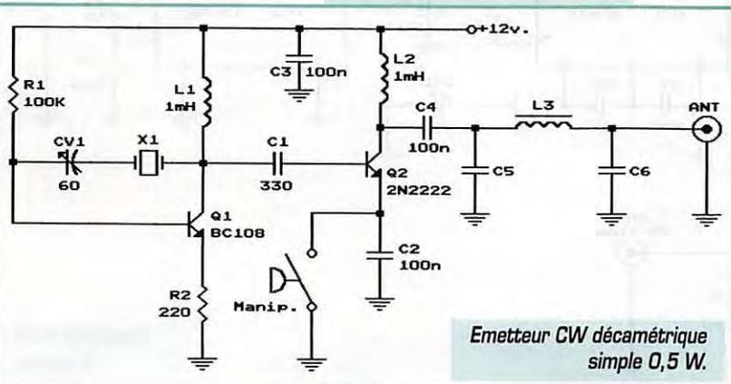
Emetteur CW décamétrique simple 0,5 W.
