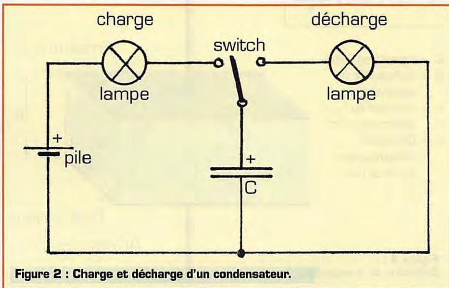
Figure 2 : Charge et décharge d'un condensateur.
