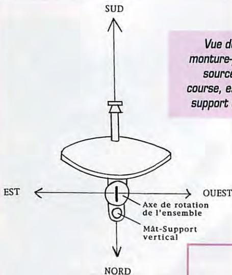
*Vue de dessus, l'ensemble montage-parabole (ici offset à source décalée) bloqué mi-course, est monté sur le mât-support dans l'axe Nord-Sud.*
