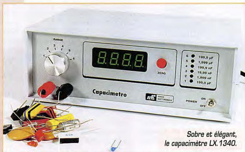
Sobre et élégant, le capacimètre LX. 1340.
