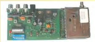
Caractéristiques communes : platines montées et testées, alimentation 13,8V, sorties audio (6,0 et 6,5 MHz modifiables en 5,0 ou 5,5 MHz) et vidéo sur RCA, sortie HF sur SMA femelle, fréquences fixes (1255, 1250, 1285, 1286,5, 1247, 1282,5, 1279,5 MHz).
