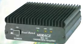
**BD-35 Mirage** Amplificateur linéaire VHF/UHF. Sortie 30 à 45 W (VHF) et 16 à 35 W (UHF) pour 1 à 7 W d'excitation (conçu pour utilisation avec TX portatifs). Sélection automatique de bande. Commutation automatique émission/réception. Fonction full-duplex. Connecteurs uniques en entrée et en sortie pour raccordement d'émetteurs et d'antennes bi-bandes. Protection contre les inversions de polarité.
