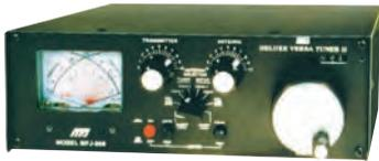
**MFJ 969** Coupleur 1,8 à 54 MHz, 300 W PEP. Watt/ROS-mètre à aiguilles croisées. Self à roulette. Balun interne 4:1. Commutateur antenne à 8 positions. Charge incorporée.
