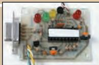
**APRS-MICRO** : L'APRS sans TNC, module autonome géré par PIC, sortie 1200 Bauds AFSK, livré en kit, dimensions réduites (52x40 mm), configuration intégrale via PC (Win 98). APRS-MICRO est livré avec sa documentation française et un CD contenant 70 Mo de logiciels APRS récents :
