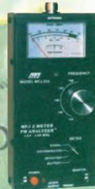
**MFJ 224** Analyseur de signal HF bande VHF. Mesure la force du signal, l'excursion FM, les antennes (gain, largeur du lobe, rapport Av/Ar, suppression lobes latéraux), la perte dans les lignes. Sorties pour oscilloscope et casque. Alimentation par pile avec témoin de décharge.
