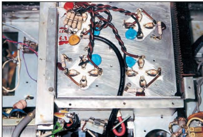
1250V, c'est au minimum 450 W HF toutes bandes et avec 1500 V, c'est au minimum 600 W HF. Les tubes d'émission peuvent brunir... pour autant qu'ils soient à l'accord, sinon ils vieilliront prématurément ! Vous constaterez que le réglage est pointu.... à l'époque on a fait l'économie de démultiplieurs à bille. Il est peut être bon de rappeler qu'un bon réglage se termine avec la puissance maximum et en mettant un peu plus de load, soit une perte d'environ 5 %.
