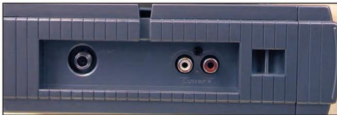
Prise antenne et sorties RCA sur le flanc gauche.
