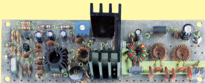
Le projet décrit est en mesure de délivrer une puissance de 8 à 20 watts avec une alimentation de 12 à 18 volts. En changeant le quartz et en modifiant le nombre de spires des différentes bobines, vous pourrez le faire fonctionner sur la gamme des 40 mètres (7 MHz).
