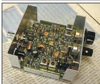
sateur ici pour améliorer la stabilité, une diode varicap et un potentiomètre là pour ajouter un RIT malheureusement absent d'origine, un changement de transistor au PA pour gagner 1 W HF supplémentaire, par exemple.
