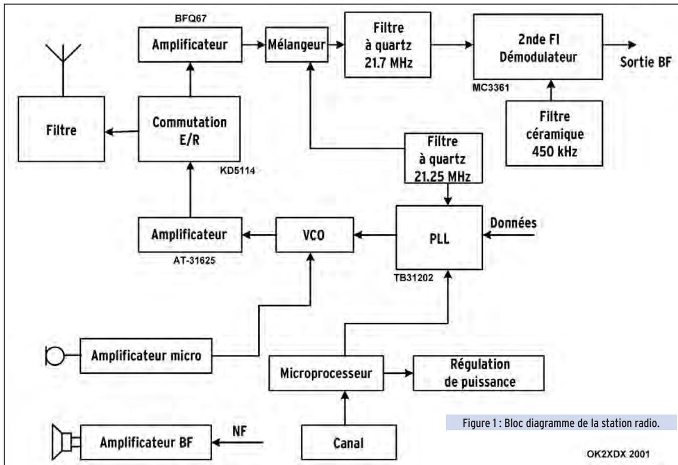
Figure 1 : Bloc diagramme de la station radio.
