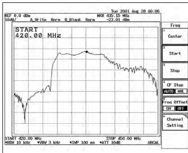
Figure 3 : Caractéristique en fréquence du filtre SAW.
