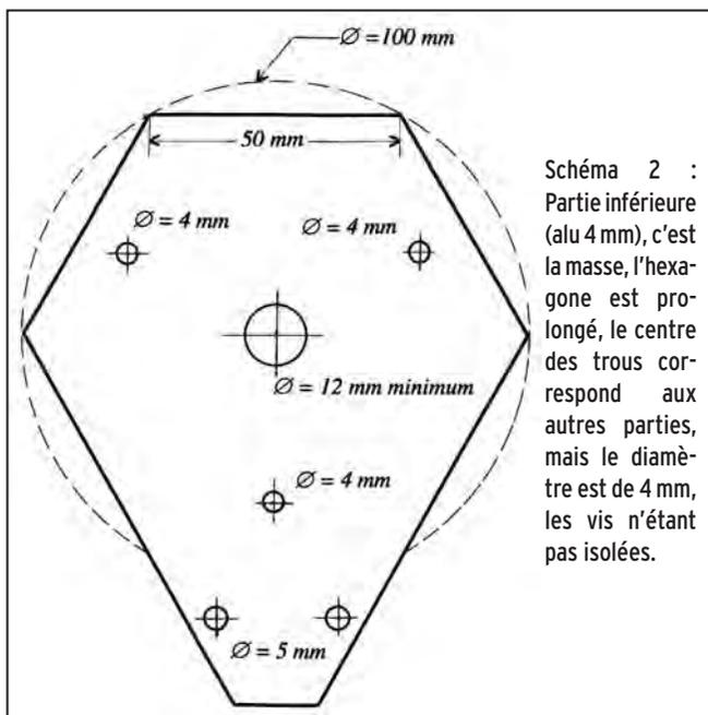
Schéma 2 : Partie inférieure (alu 4 mm), c'est la masse, l'hexagone est prolongé, le centre des trous correspond aux autres parties, mais le diamètre est de 4 mm, les vis n'étant pas isolées.
