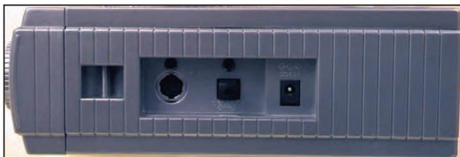
Mini DIN, sortie optique et alimentation sur le flanc droit.
