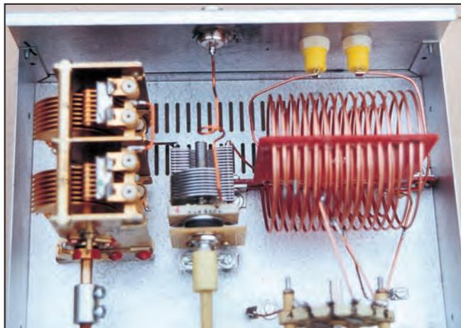
CV1 = 170 pF. Isolé de la masse du châssis.
