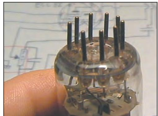
Photo 3 : Les broches de sortie d'un tube noval.
