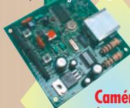
Émetteur COMTX24MINI, 2,4 GHz 20 mW, dimensions 45 x 45 x 20 mm, poids 9 g ..... 39,00 €
