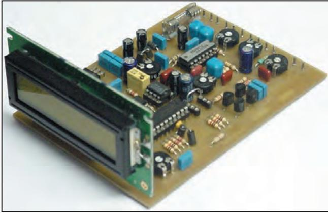
que l'afficheur fonctionne, (la première ligne doit être remplie de carrés noirs). Au besoin ajuster le contraste avec R23.
