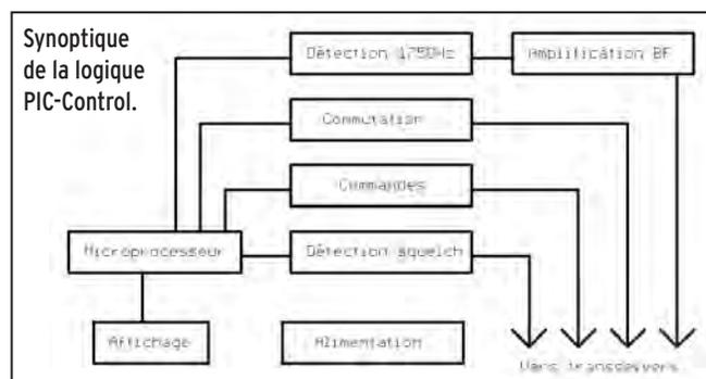
cœur du montage. Son rôle est de gérer les différents modes du relais en fonction du bloc "Commandes" qui sélectionne les options possibles. Conformément à cette sélection, le microcontrôleur gère la détection des squelch, du détecteur de 1750 Hz, de la commutation des PTT issue du ou des transceivers. Pour finir il gère également l'affichage des paramètres de la logique.
