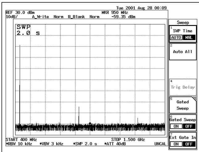
Figure 8 : Le spectre de sortie de l'émetteur.
