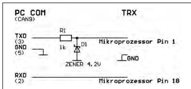
Figure 11 : Schéma de l'interface entre PC et E/R.
