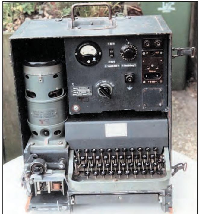
La machine Feldfern-schreiber ci-dessus (Modèle A2, Numéro de Série 15672) a été construite en 1944 et est encore en état de marche. Plusieurs de ces machines bien faites sont précieusement conservées ou même toujours en usage chez des radioamateurs. (Photographie gracieusement fournie par Dick PAOSE).
