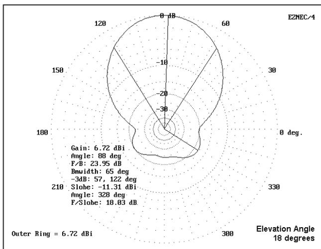
Fig. 36 : Diagramme azimuthal d'une 2 él. demi-carré.
