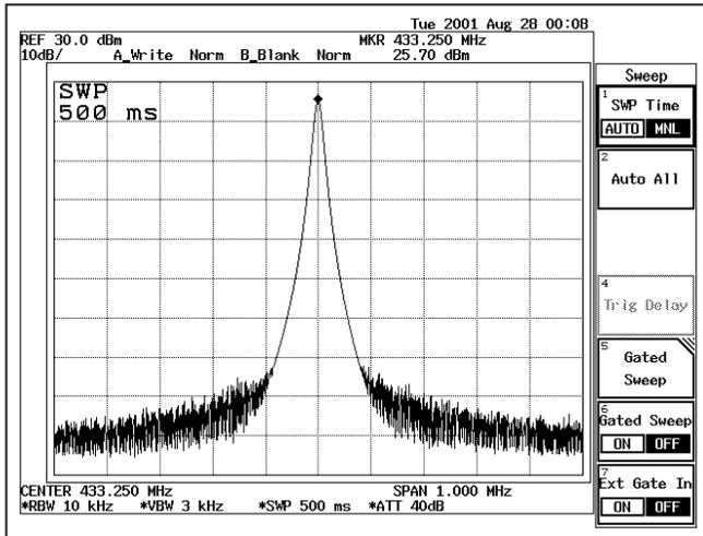
Figure 7 : Le signal de sortie de l'émetteur.
