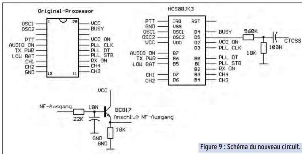
Figure 9 : Schéma du nouveau circuit.
