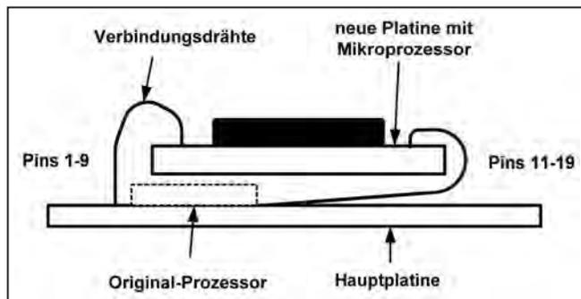
Figure 12 : Dessin mécanique du montage du nouveau circuit.
