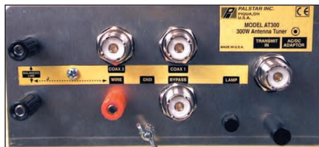
Prises pour antennes filaire, bifilaire ou coaxiale.
