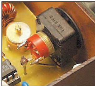
avec un foret de 2,5 mm de diamètre, sur une longueur de 3mm. Régler le potentiomètre et le condensateur ajustable à mi-course (très important). Déposer une goutte de colle "Cyanolyt" sur l'axe du condensateur ajustable, emmancher le tout en prenant soin de faire regarder la patte
