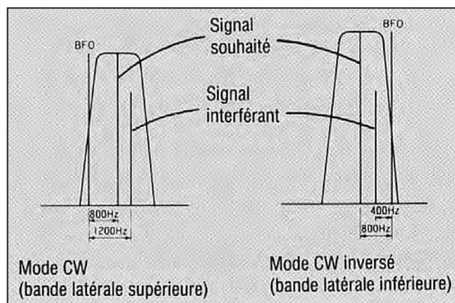
du récepteur de telle sorte que le signal écouté fournisse exactement la même tonalité, normalement égale au pitch choisi, quelle que soit la position utilisée CW ou CW-R. Bien entendu, les heureux utilisateurs d'un filtre à quartz IF de 250 Hz en réception sont très près du compte puisque leur marge d'erreur en matière de calage est relativement faible.
