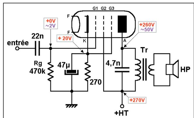
Figure 1 : Le schéma avec les valeurs mesurées.
