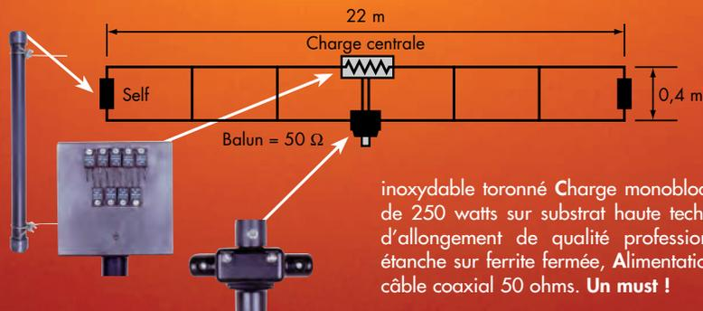
inoxydable toronné Charge monobloc non selfique de 250 watts sur substrat haute technologie, Selfs d'allongement de qualité professionnelle, Balun étanche sur ferrite fermée, Alimentation directe par câble coaxial 50 ohms. **Un must !**
