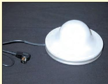
Le proto de l'antenne omnidirectionnelle.
