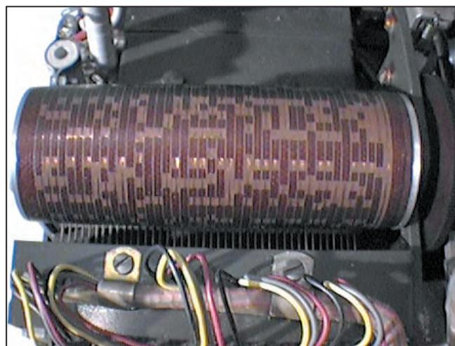
Figure 12 : Photo du tambour d'une machine Feld-Hell ancienne.
