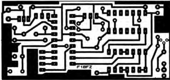
Circuit imprimé du fréquencemètre.
