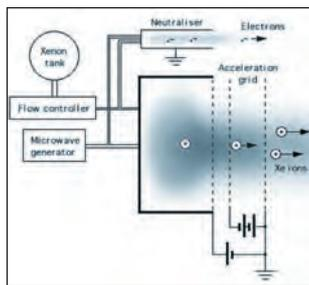
F02 : Principe du propulseur ionique de MUSES C.
