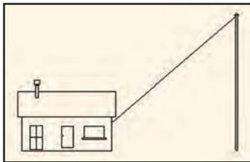
Figure 1: L'antenne long fil ou simple fil.
