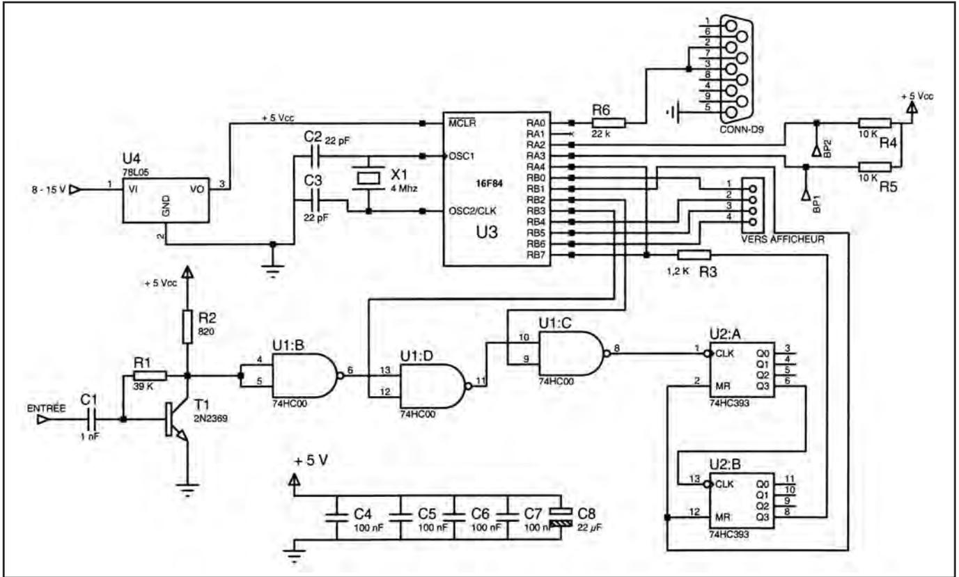
Schéma de principe du fréquencemètre.
