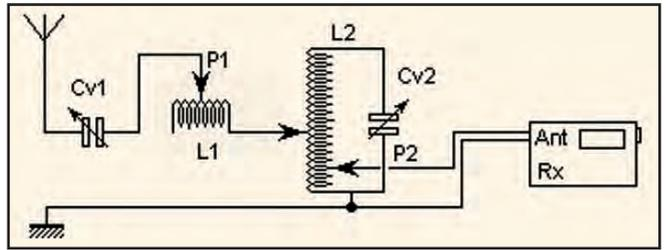
Figure 4: Coupleur d'antenne variante.
