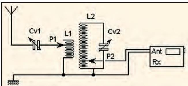
Figure 2: Coupleur d'antenne.
