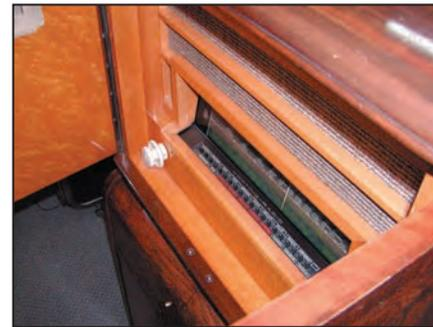
Le cadran de la Korting. Il suffit d'appuyer sur un des 20 boutons correspondant au nom de la station désirée. A l'aide d'électromoteurs, le choix de la fréquence se fait automatiquement.
