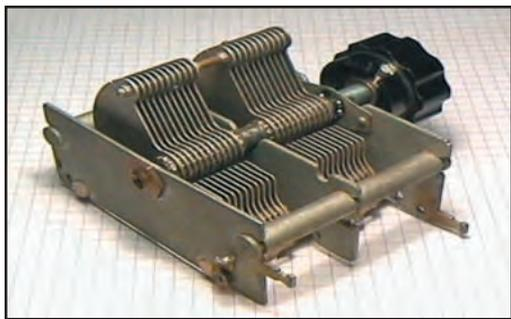
Figure 4 : Un CV antique à double cage
