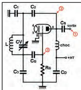
Figure 6 : Le schéma de notre oscillateur Colpitts.
