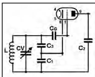
Figure 7 : Une autre façon de représenter notre oscillateur.
