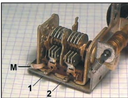
Figure 3: Un CV miniature à double cage.
