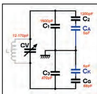
Figure 8 : Le circuit oscillant d'un Colpitts avec toutes les capas du montage.
