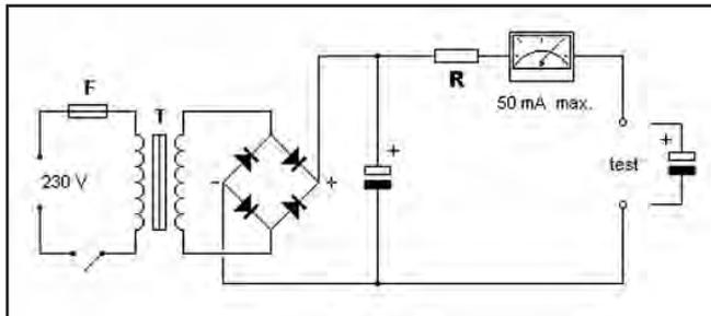
valeur de quelques milliampères au bout d'environ un quart d'heure et un seuil minimum généralement au bout d'une demi-heure à une heure. En ce qui concerne la régénération du condensateur, l'important n'est pas la valeur absolue de l'intensité du courant de fuite mesurée mais la décroissance de celui-ci pendant une période
