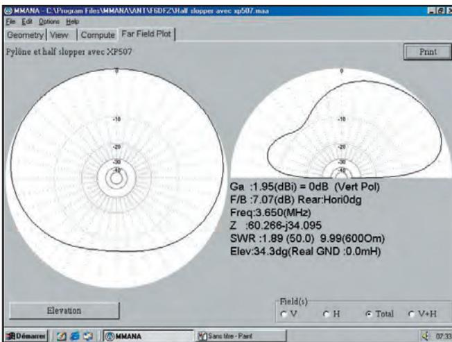
Figure 3 : Vue des diagrammes de rayonnement sur 80 m.
