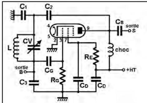
Figure 1: Oscillateur Colpitts à pentode.
