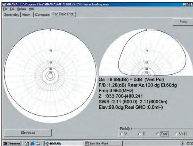
Figure 9 : Diagrammes de rayonnement de la L2T2FD.
