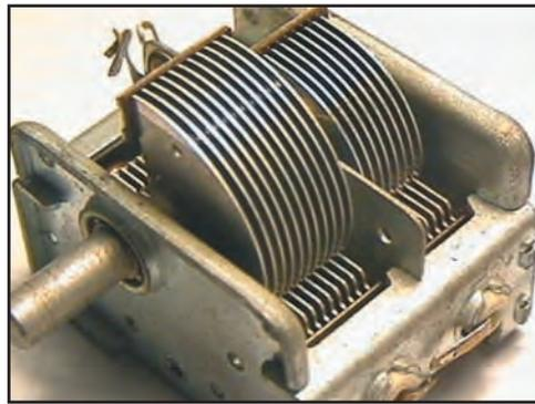
Photo 5: CV à deux cages à faible isolement.
