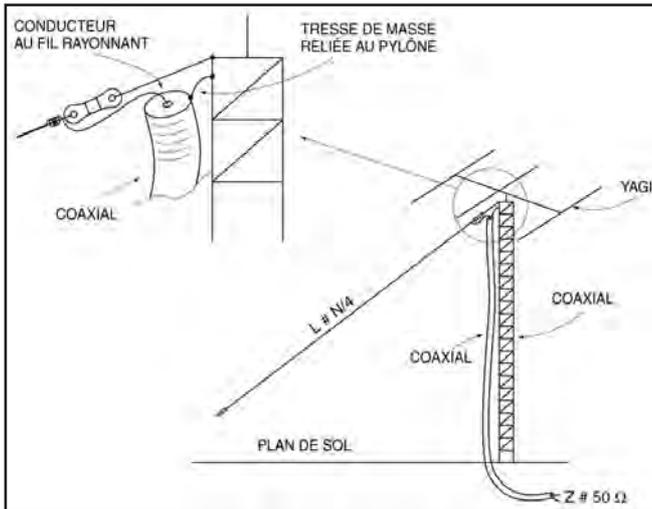
Figure 1 : Schéma de l'antenne Half Sloppler.
