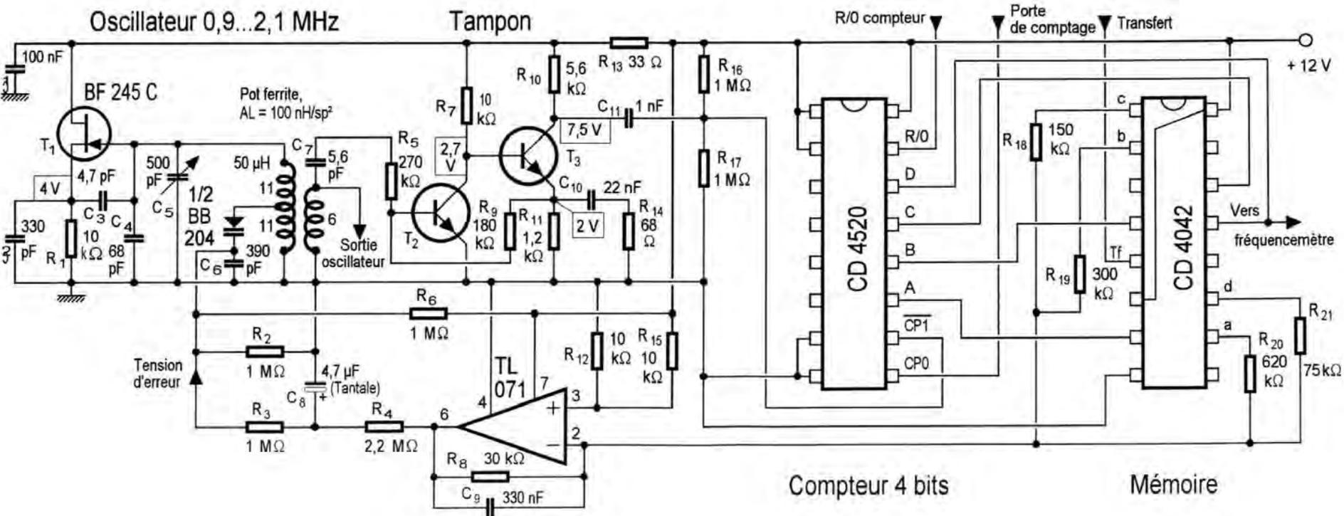
Figure 3 : Le circuit de régulation réunit l'oscillateur LC avec un compteur 4 bits, la mémoire qui retient le résultat de comptage et la conversion D/A par laquelle on corrige la fréquence au moyen d'une diode varicap.
