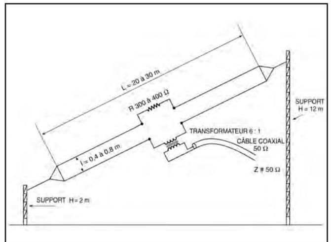
Figure 6 : Schéma classique de la T2FD.
