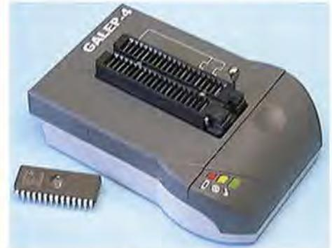
Programmeur autonome permettant de programmer tous les principaux composants en boîtier DIP (plus de 1800 à ce jour) tels que :
