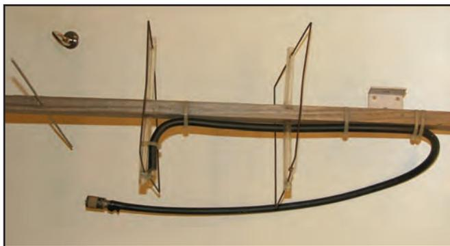
aux intempéries). Spécialement en Suisse où on a l'habitude de construire "pour 100 ans"... Mais si l'on tient compte du fait qu'une antenne de radioamateur, même de construction pro, ne restera pas sur le toit pendant un siècle (on est des expérimentateurs, pas vrai?), alors le bois fait parfaitement l'affaire. On peut aussi utiliser un autre matériau que le bois, par exemple de la fibre de verre, pourvu qu'il soit isolant.
