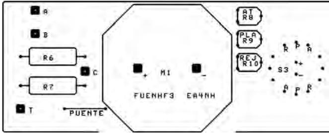
Figure 14: Circuit du contrôleur. Disposition des composants.
