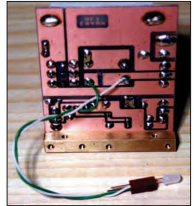
Figure 12 : Circuit du relais. Côté des soudures.
