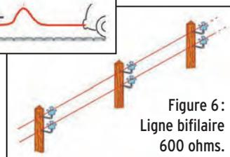
Figure 6: Ligne bifilaire 600 ohms.
