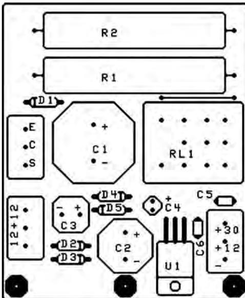
Figure 10 : Circuit du relais. Disposition des composants.
