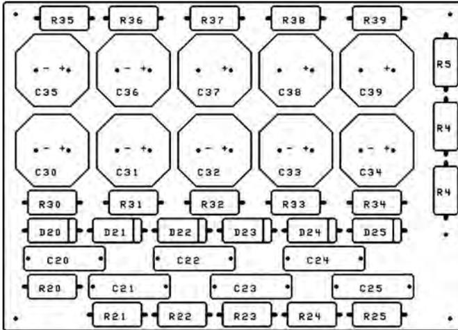
Figure 7 : Circuit doubleur. Disposition des composants.
