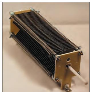
L'un d'eux est présenté ici, il s'agit du CV papillon à faibles pertes 18 à 136 pF, tenant 4 200 V. Il est doté d'un axe en nylon (donc isolé) de 6 cm et mesure environ 25 cm de long, 7,5 de large, 9 de haut.
