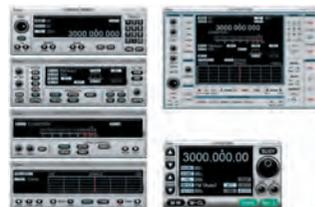
Le récepteur couvre de 0 à 3,3 GHz, en AM/FM/WFM/SSB/CW (seulement deux modes au-dessus de 1,3 GHz : FM et WFM). Il se présente, comme ses prédécesseurs (PCR1000), sous la forme d'une boîte noire de 146 x 206 x 41 mm, alimentée sous 12 V. Le panneau de commande mesure 111 x 40 x 27 mm. La liaison vers le PC s'effectue en USB. Bien entendu, le logiciel de pilotage du récepteur est fourni avec celui-ci.
