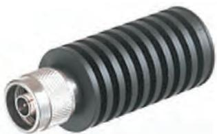
La charge Diamond DL30 (ou DL30N avec connecteur de type N) est un bon choix. Elle couvre de 0 à 500 MHz, peut dissiper 15 W en permanence ou 100 W en crête pendant quelques instants. Le ROS maxi sur la gamme couverte est de 1,5:1. Ses dimensions sont diamètre 30 mm et longueur 75 mm.
