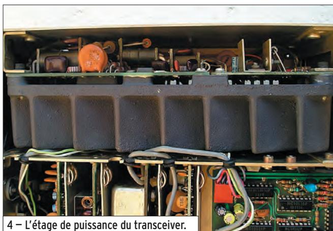
4 - L'étage de puissance du transceiver.
