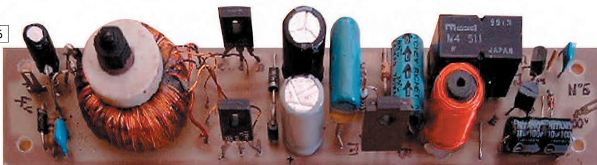
BUT11 est un bobinage réalisé sur une petite ferrite de 8 x 18 avec 200 spires environ de fil émaillé en 3/10.
