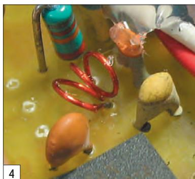
L1, L2 et C28 apporte un minimum de sélectivité et suffit pour adapter l'impédance 50 ohms de l'antenne au mélangeur NE602, NE612 ou mieux SA612 (version récente).
