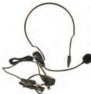
de 20 à 20 000Hz. Le micro électret est omnidirectionnel, il est dissimulé sous une petite bonnette en mousse. Le câble de liaison mesure 1,5 m. Testé avec un E/R portatif de marque Standard, ce petit casque-micro a montré des résultats satisfaisants, tant en restitution sonore qu'en qualité de modulation...
