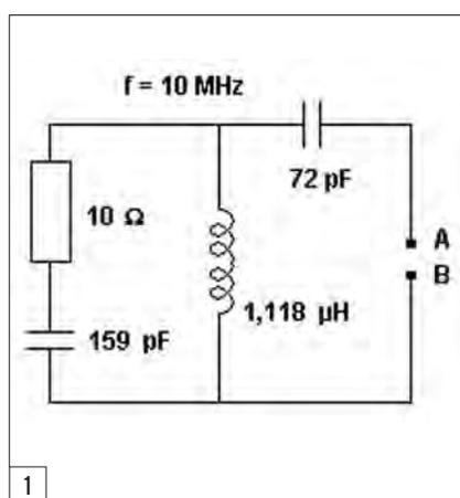
Voici, **figure 1**, le schéma. On désire déterminer l'impédance résultante aux points A et B sachant que la fréquence d'utilisation est de 10 MHz. On pourrait imaginer que la résistance de 10  $\Omega$ , en série avec le condensateur de 159 pF, représente une antenne et que la self et le condensateur constituent un système d'adaptation d'impédance, les points A et B étant les points de raccordement de l'émetteur.
