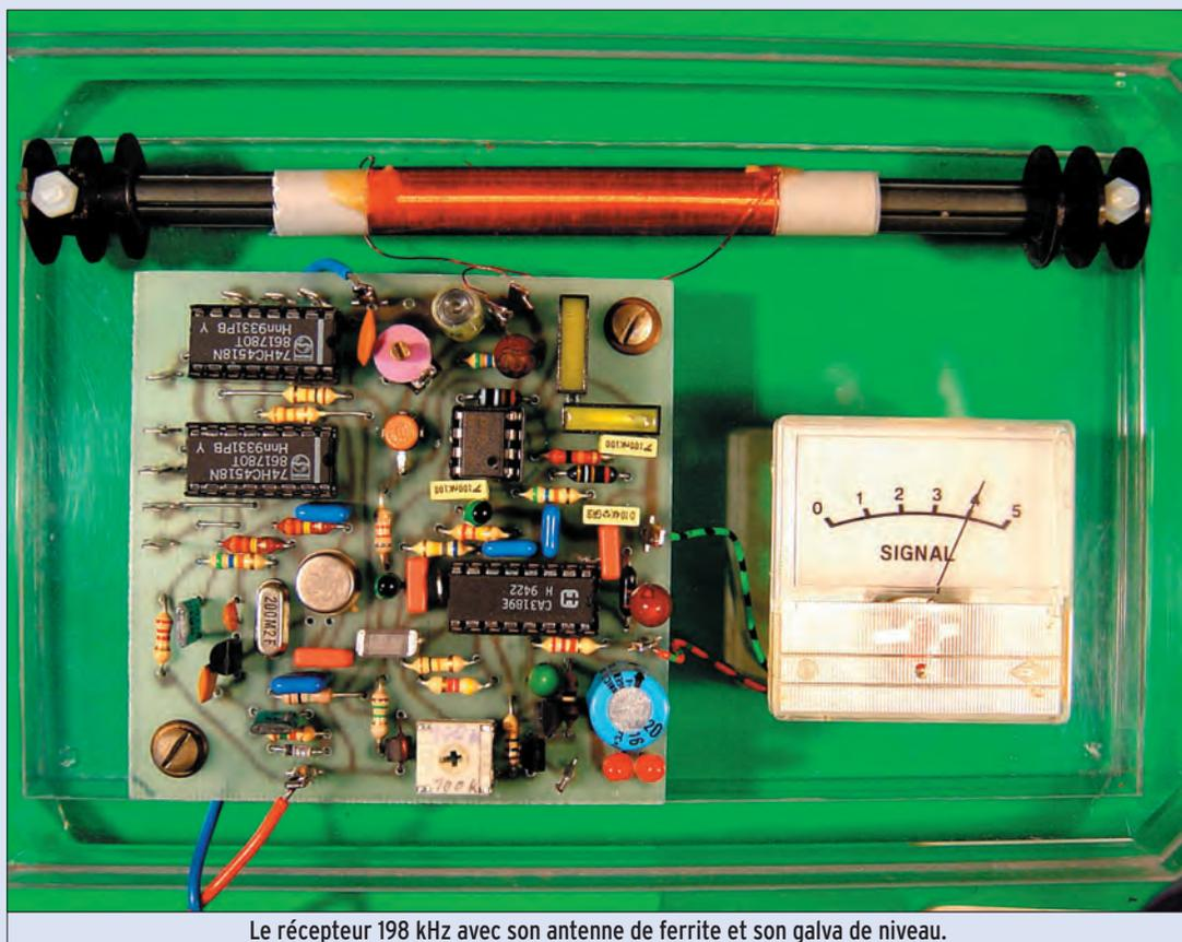
Le récepteur 198 kHz avec son antenne de ferrite et son galva de niveau.
