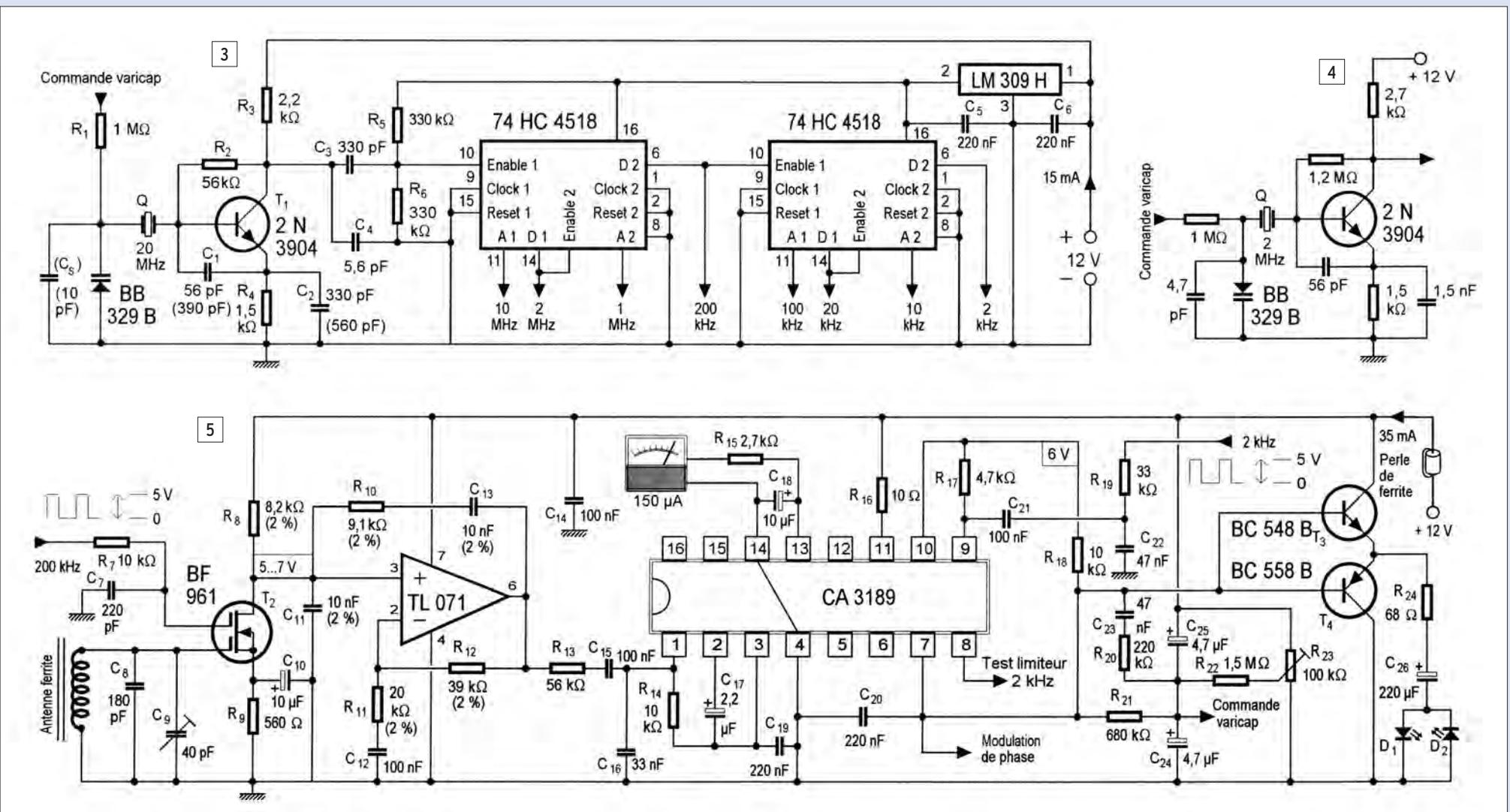
capté par l'antenne ne subit aucun amortissement par le circuit d'utilisation. R7 et C7 transforment la rectangulaire de 200 kHz, issue du diviseur de fréquence, en une quasi triangulaire d'amplitude convenable. La composante continue qui subsiste, avec cette méthode, convient parfaitement pour la fonction de conversion.
