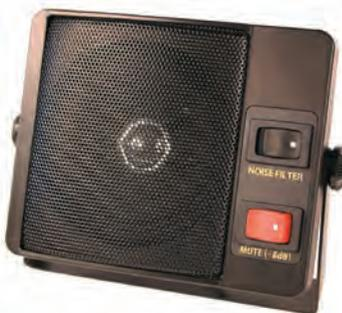
simplement en "shuntant" les fréquences élevées et d'un circuit "Mute" qui atténue le son de 8dB permettant, par exemple, de prendre une conversation téléphonique... Les essais que nous avons faits montrent une bonne restitution sonore à l'écoute de diverses sources de radiocommunications.
