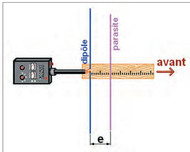
3 – Antenne à deux éléments expérimentale.
