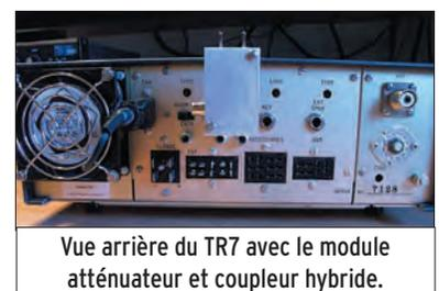
Vue arrière du TR7 avec le module atténuateur et coupleur hybride.
