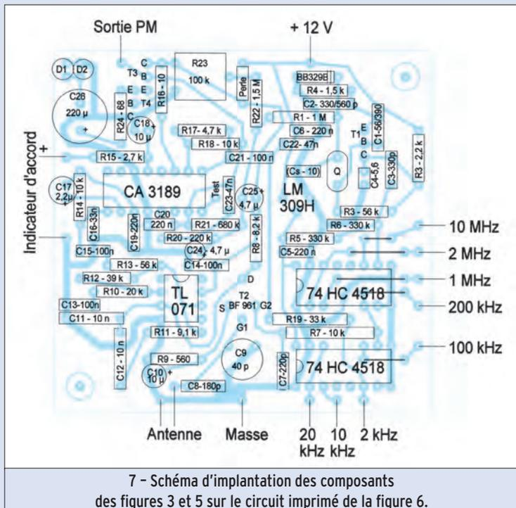
7 - Schéma d'implantation des composants des figures 3 et 5 sur le circuit imprimé de la figure 6.
