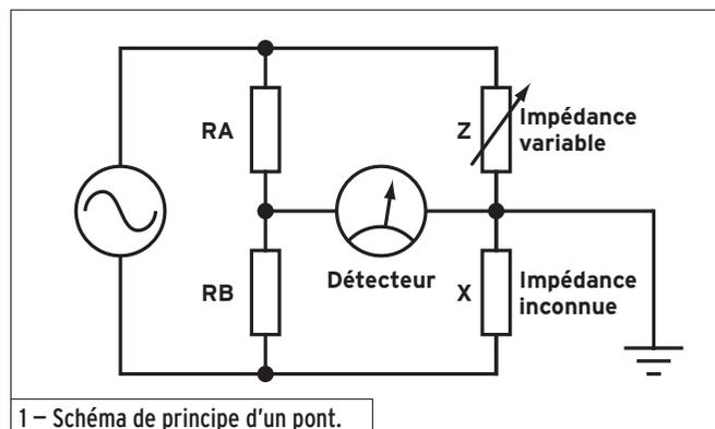
1 - Schéma de principe d'un pont.
