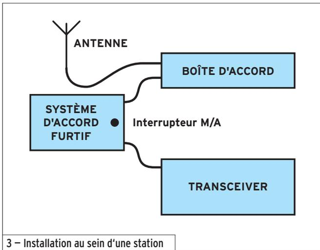
du même nom !). On ne touche pas à la syntonisation du récepteur, on enclenche le circuit d'accord silencieux, on règle le coupleur (associé à l'antenne) et l'on écoute le récepteur (qui hors accord, produit un merveilleux "bruit blanc"). Pour les non informés, le son
