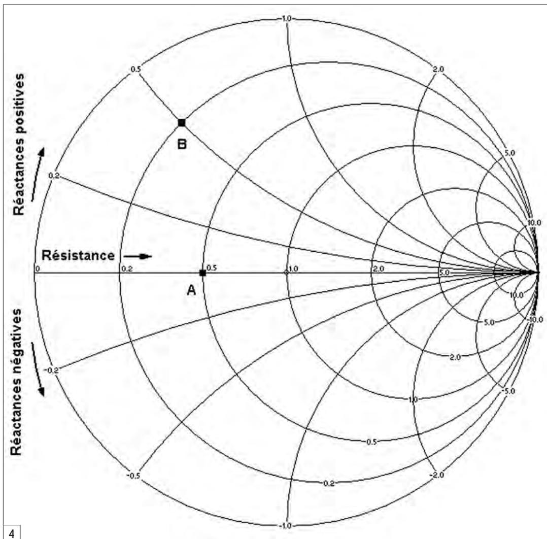
ces, toute la partie supérieure concerne le positionnement des réactances inductives, réciproquement, la partie inférieure est réservée aux réactances capacitives.
