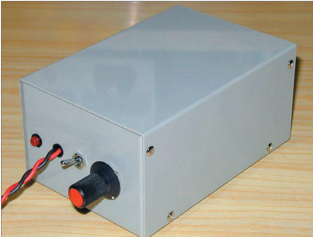
Le laboratoire du radioamateur n'est pas forcément composé d'appareils de mesure sophistiqués et onéreux. Certains matériels utiles peuvent facilement être construits par nos soins. L'article proposé ici décrit la construction et la mise en marche d'un mesureur de diode zener qui nous permettra de contrôler des diodes zener tout en déterminant leur tension de référence. On peut aussi utiliser le mesureur pour contrôler des diodes normales au silicium ou au germanium.
