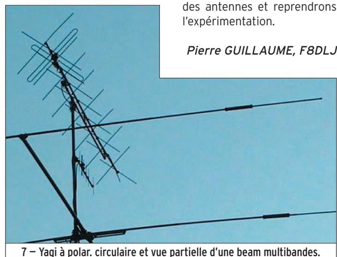
7 – Yagi à polar. circulaire et vue partielle d'une beam multibandes.
