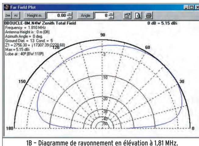
1B - Diagramme de rayonnement en élévation à 1,81 MHz.
