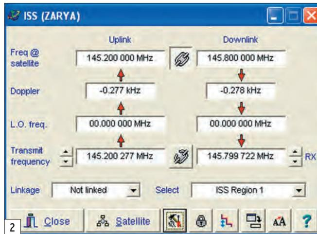
logiciel CAT (lien DDE actif). Le logiciel CAT doit commander le transceiver en fonction des données issues du logiciel de poursuite. Vous pouvez à présent réaliser une liaison.
