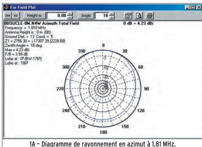
1A - Diagramme de rayonnement en azimut à 1,81 MHz.
