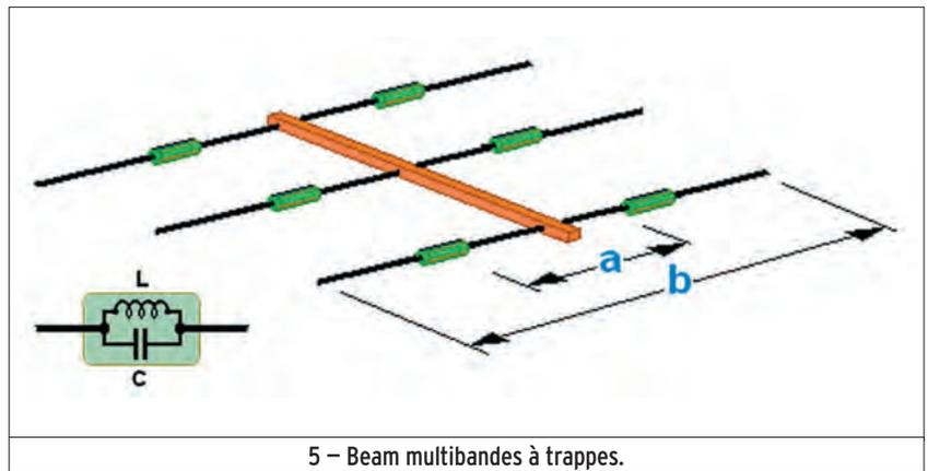
5 – Beam multibandes à trappes.
