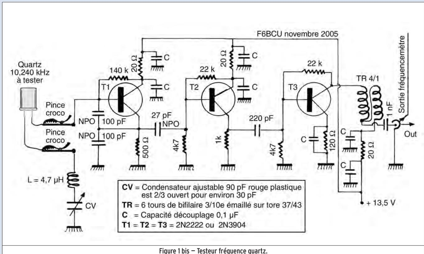
Figure 1 bis – Testeur fréquence quartz.
