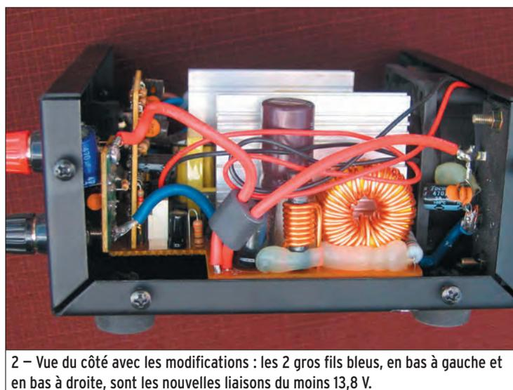
2 – Vue du côté avec les modifications : les 2 gros fils bleus, en bas à gauche et en bas à droite, sont les nouvelles liaisons du moins 13,8 V.
