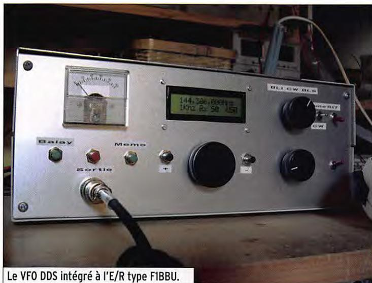
Le VFO DDS intégré à l'E/R type FIBBU.
