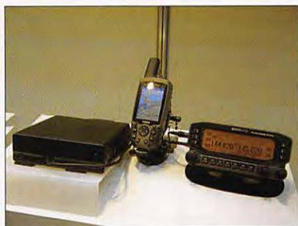
Poursuivant le renouvellement de sa gamme V/UHF, Kenwood propose un successeur au TM-D700, le TM-D710E, un bibande VHF/UHF plus particulièrement dédié au packet radio.
