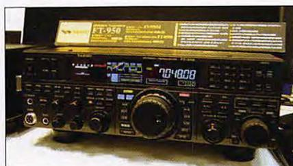
D'allure beaucoup plus conventionnelle, voici le Yaesu FT-950, un transceiver HF (160 à 10 m) et 50 MHz (6 m) de 100 watts, héritier direct des FT-1000 et FTDX-9000. Il a belle allure, il faut le dire...
