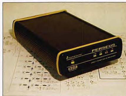
En Italie, la société Microtecom a conçu un récepteur SDR dont les performances s'avèrent intéressantes (IP3 à 31 dBm et dynamique de blocage à 125 dB), couvrant de 10 kHz à 30 MHz et pouvant présenter à l'écran jusqu'à 400 kHz de la bande reçue. Il fonctionne avec n'importe quel
