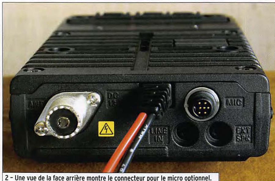
2 - Une vue de la face arrière montre le connecteur pour le micro optionnel.
