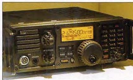
Une allure très militaire (ou professionnelle) pour ce nouvel Icom, l'IC-7200. Poignées rack, HP en façade, assez robuste et tout terrain, le transceiver couvre les bandes HF (160 à 10 m) et le 50 MHz (6 m) avec une puissance de 100 watts.
