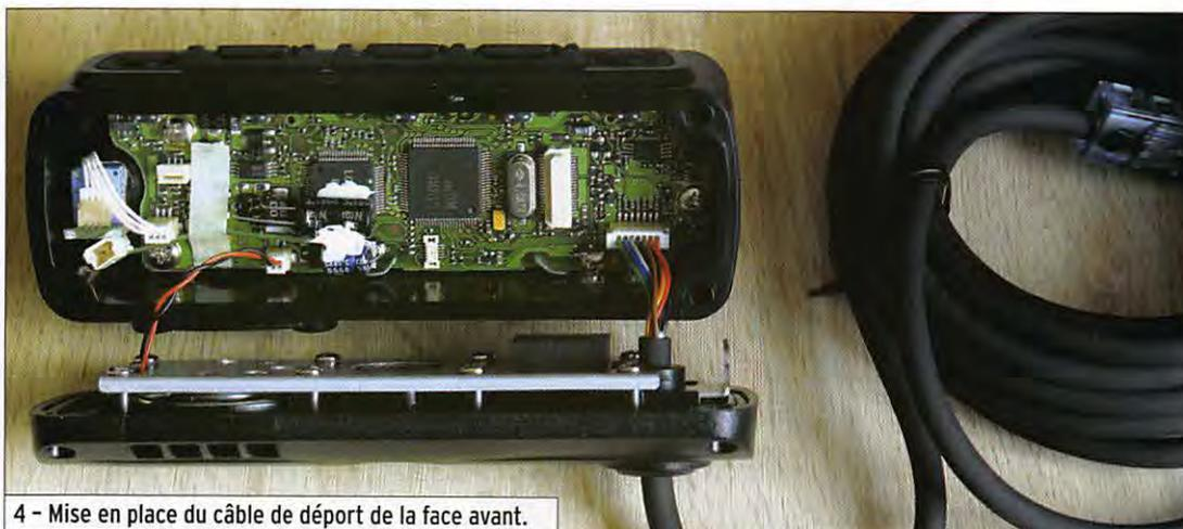
4 - Mise en place du câble de déport de la face avant.
