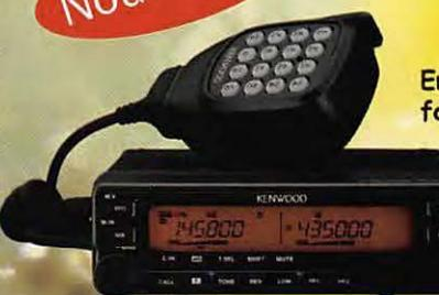
Mode Echolink avec 10 canaux mémoires, permettant le stockage de l'indicatif d'appel (8 caractères maxi), connexions PC et TNC, large bande de réception, MCP-2A logiciel de programmation des mémoires disponible gratuitement sur internet, protection par mot de passe, verrouillage clavier, 3 niveaux de puissance 5/10/50 watts, inversion de la façade, fourni avec micro MC59 DTMF, câble d'alimentation et étrier
