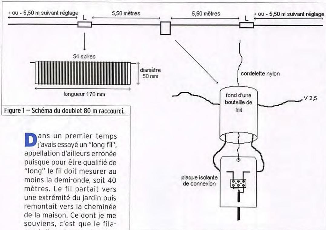
Figure 1 - Schéma du doublet 80 m raccourci.
