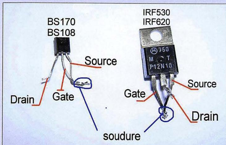
**F**5HD me parla de l'utilisation de MOSFET canal N en remplacement de diodes Varicap, suite à une information trouvée sur Internet qui venait d'Allemagne. Nous utilisons couramment sur nos montages communs, en remplacement des diodes Varicap, des diodes Zener 22, 24, 30 volts, qu'il faut trier car les dispersions sont très grandes. Il fut donc décidé de tester quelques types de MOSFET canal N pour savoir et mesurer !
