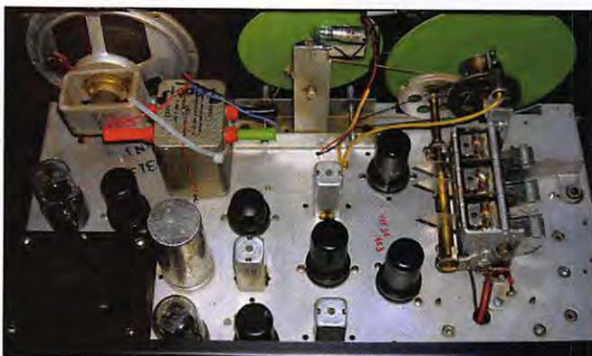
Le principal avantage de ce poste est son étalement de bande, qui est d'une douceur extrême. Il est réalisé à partir du CV principal par une lame rentrant dans chacune des trois cages du CV, ce qui fait qu'aucun désalignement n'est généré en étalement de bande. En fait, cela représente l'équivalent de six condensateurs variables sur deux axes concentriques ; ce qui n'est pas le cas sur d'autres maté-
