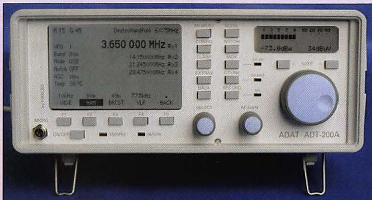
une linéarité et un niveau de bruit idéals. Quant à l'émission, l'étage final est équipé de MOSFET pouvant délivrer 50 W avec un rendement de 70 %. C'est le prototype que l'on peut voir sur la photo, les premiers exemplaires, fabriqués en petites séries, devraient être disponibles d'ici la fin du premier trimestre 2008 à un prix avoisinant les 4 000 euros. À découvrir sur <http://www.adat.ch>
