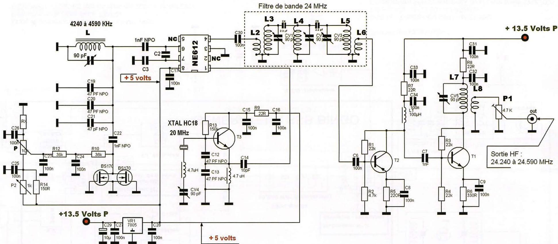
**P** = potentiomètre de façade multi-tours Linéaire commande de fréquence
