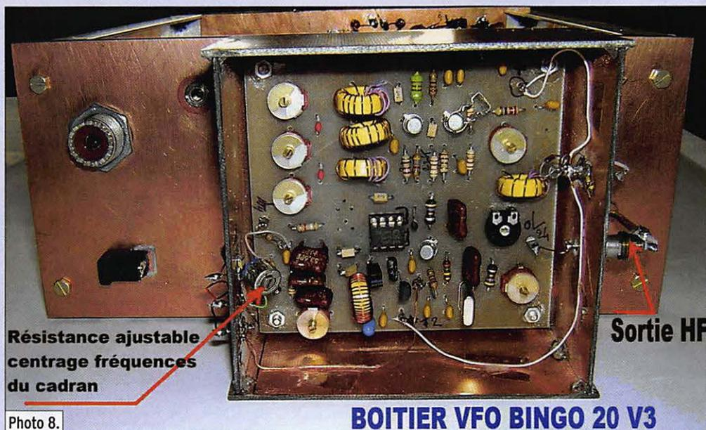
Résistance ajustable centrage fréquences du cadran
