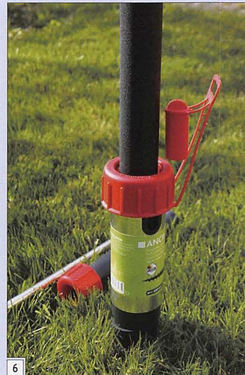
Pour utiliser le support d'ancrage, on dispose d'un tube en aluminium qui servira de bras de levier pendant les opérations de "vissage - dévissage" en terre (photo 4). À enfoncez plus ou moins profondément suivant le poids et la prise au vent de votre mât d'antenne...
