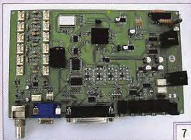
Les performances indiquées par les concepteurs sont élogieuses : IP3 à +28 dBm, MDS à -130 ou -124 dBm (avec ou sans préampli), résolution de 1 Hz, bande couverte 192 kHz (c'est fonction de la carte son utilisée), commande par port parallèle...
