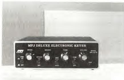
*Le manipulateur électronique : un accessoire utilisé tous les jours et sélectionné avec soin par les amateurs de télégraphie (CW).*
