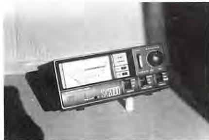
*Un accessoire dont on peut difficilement se passer, le TOS-mètre. En choisissant un modèle qui fait Watt-mètre on dispose de 2 appareils en un.*
