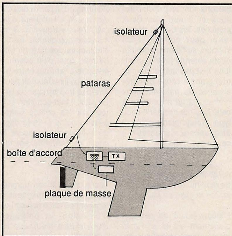
**Plaque de masse : plaque de bronze de faibles dimensions ( $\approx 30\text{ cm} \times 20\text{ cm}$ ) placée sous la flottaison et dont la surface est constituée de fines billes de façon à offrir une grande surface de contact.**
