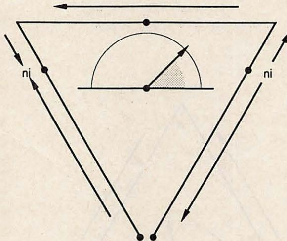
• Figure 4 - La Delta-Loop a sa pointe tournée vers le bas, elle nécessite deux mâts élevés, mais peut être intéressante en cas d'encombrements au voisinage du sol. Ses caractéristiques sont semblables à celles de la figure 1.
