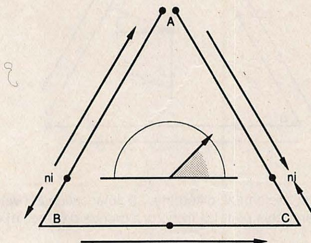
• Figure 1 - L'alimentation se fait au sommet du mât, la polarisation est horizontale avec un angle de tir d'environ 50° (il se mesure par rapport à l'horizontale).
