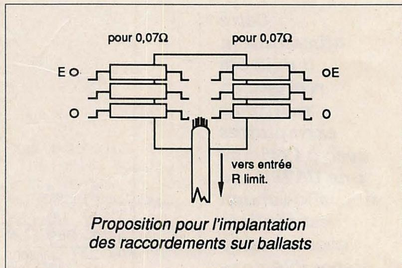
coupler thermiquement le pont aux ballasts.
