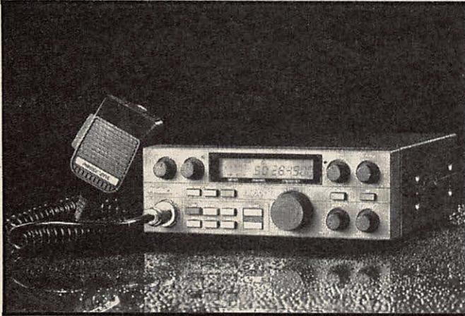
**LINCOLN monobande 28 MHz AM FM BLU CW par 200 canaux Puissance 10 Watts BLU 21 W. crête sensibilité 0,5  $\mu$ V ( 10 d/B S/B ). Il a été présenté dans la revue MEGAHERTZ Magazine.**
