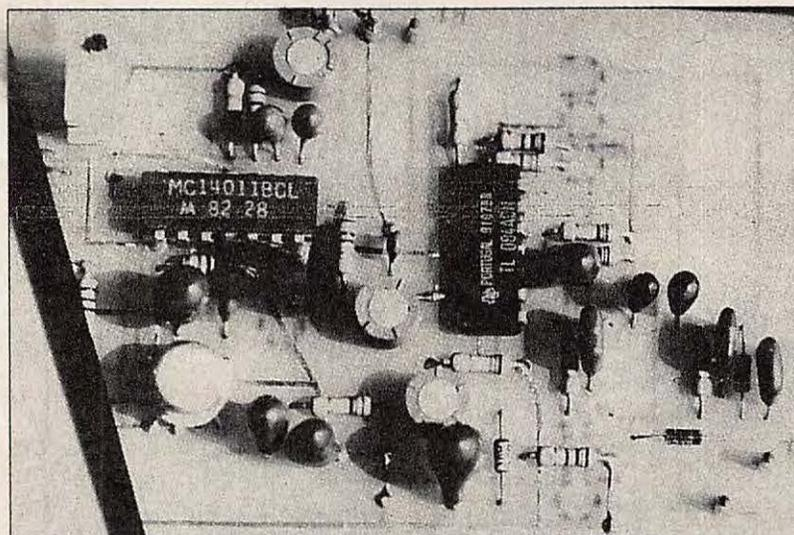
moment du transfert des informations à l'entrée du nand, une cellule de filtrage a été interposée entre la sortie de la porte et l'entrée du NE555.
