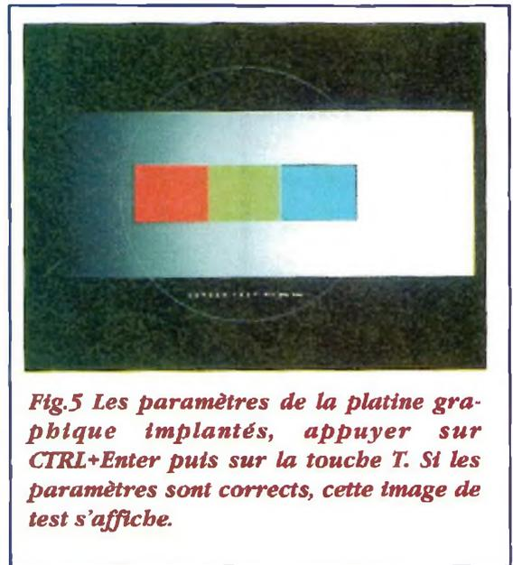
**Fig.5 Les paramètres de la platine graphique implantés, appuyer sur CTRL+Enter puis sur la touche T. Si les paramètres sont corrects, cette image de test s'affiche.**
