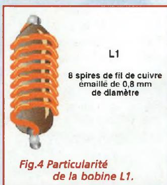
Fig.4 Particularité de la bobine L1.
