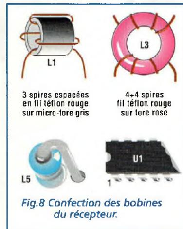
Fig. 8 Confection des bobines du récepteur.
