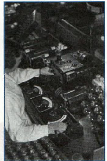
Fig.2 Le montage du filament est effectué après elui des grilles et de la plaque.
