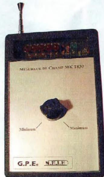
Fig.5 Le mesureur de champ permet de localiser très facilement tout émetteur en service.
