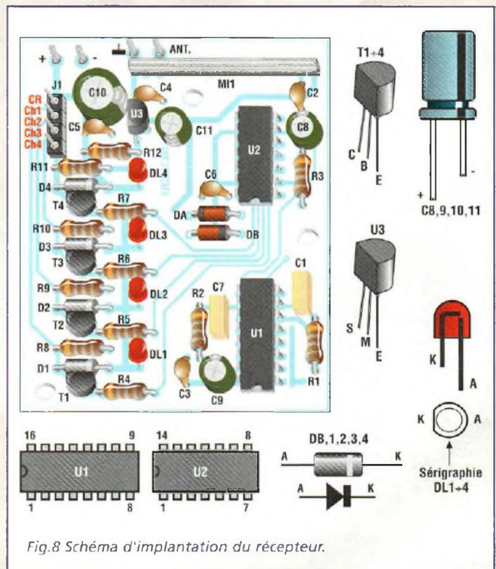
Fig.8 Schéma d'implantation du récepteur.
