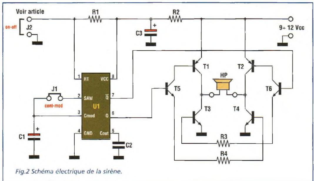
Fig.2 Schéma électrique de la sirène.
