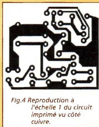
Fig.4 Reproduction à l'échelle 1 du circuit imprimé vu côté cuivre.
