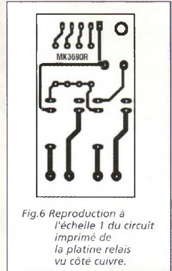
Fig.6 Reproduction à l'échelle 1 du circuit imprimé de la platine relais vu côté cuivre.
