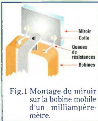
Fig.1 Montage du miroir sur la bobine mobile d'un milliampèremètre.
