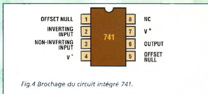
Fig.4 Brochage du circuit intégré 741.
