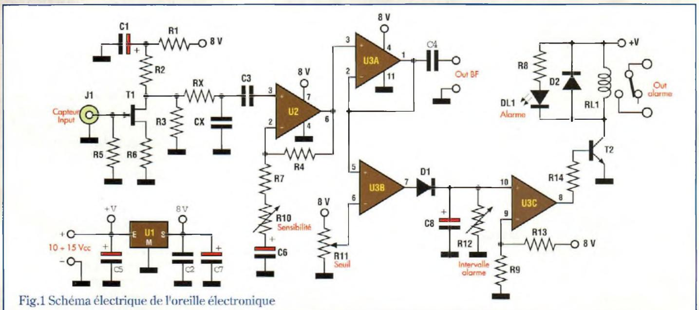
Fig.1 Schéma électrique de l'oreille électronique
