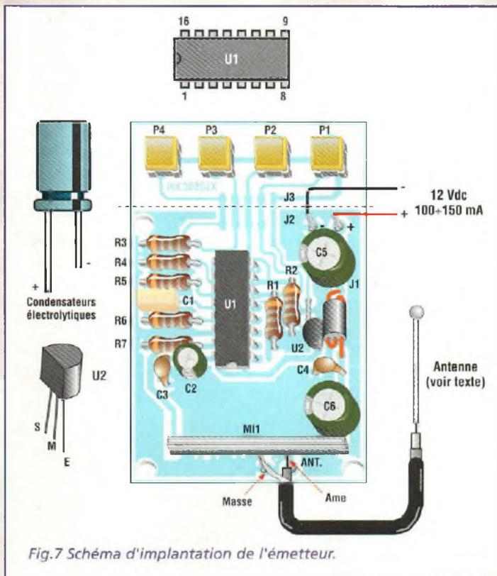
Fig.7 Schéma d'implantation de l'émetteur.
