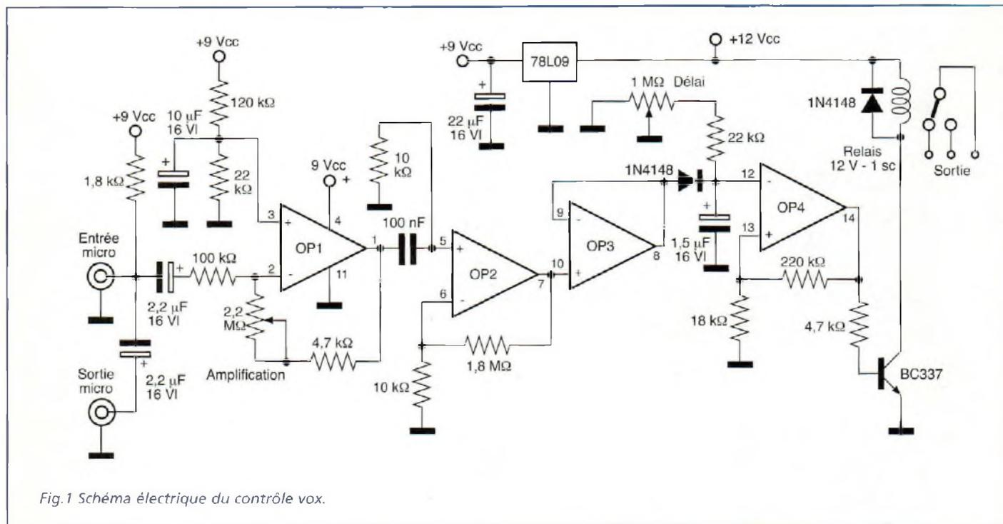
Fig.1 Schéma électrique du contrôle vox.
