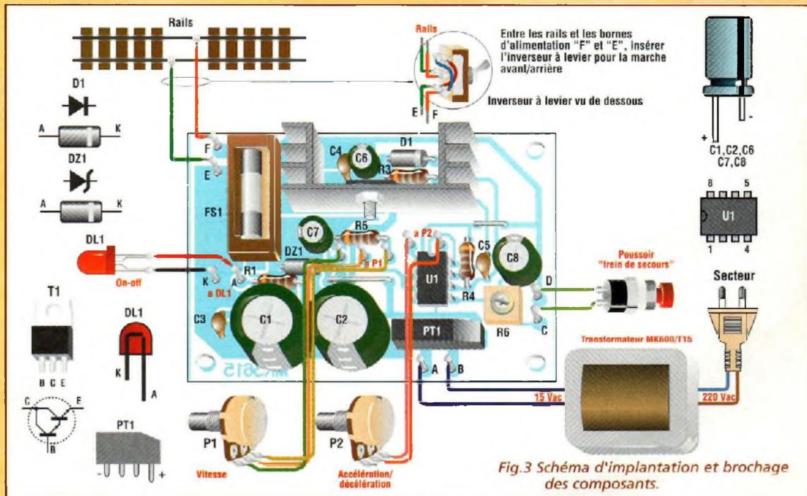
Fig.3 Schéma d'implantation et brochage des composants.
