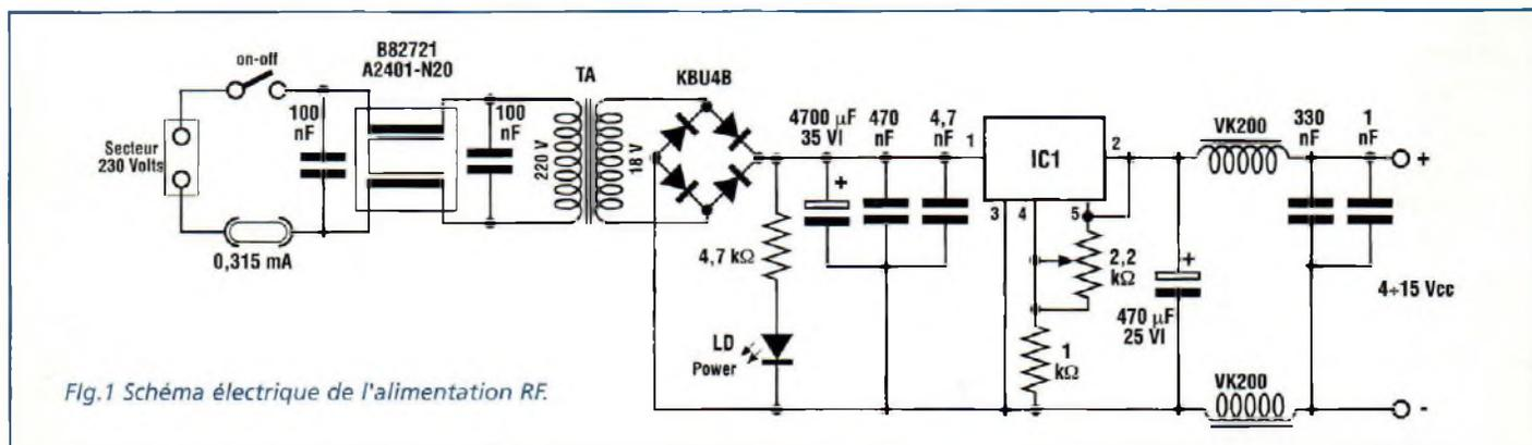
Fig.1 Schéma électrique de l'alimentation RF.
