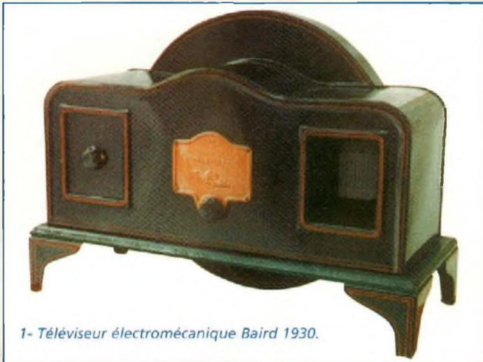
1- Téléviseur électromécanique Baird 1930.
