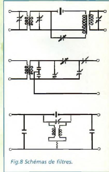
Fig.8 Schémas de filtres.
