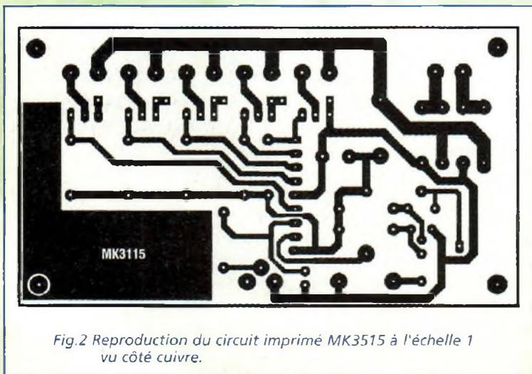
Fig.2 Reproduction du circuit imprimé MK3115 à l'échelle 1 vu côté cuivre.
