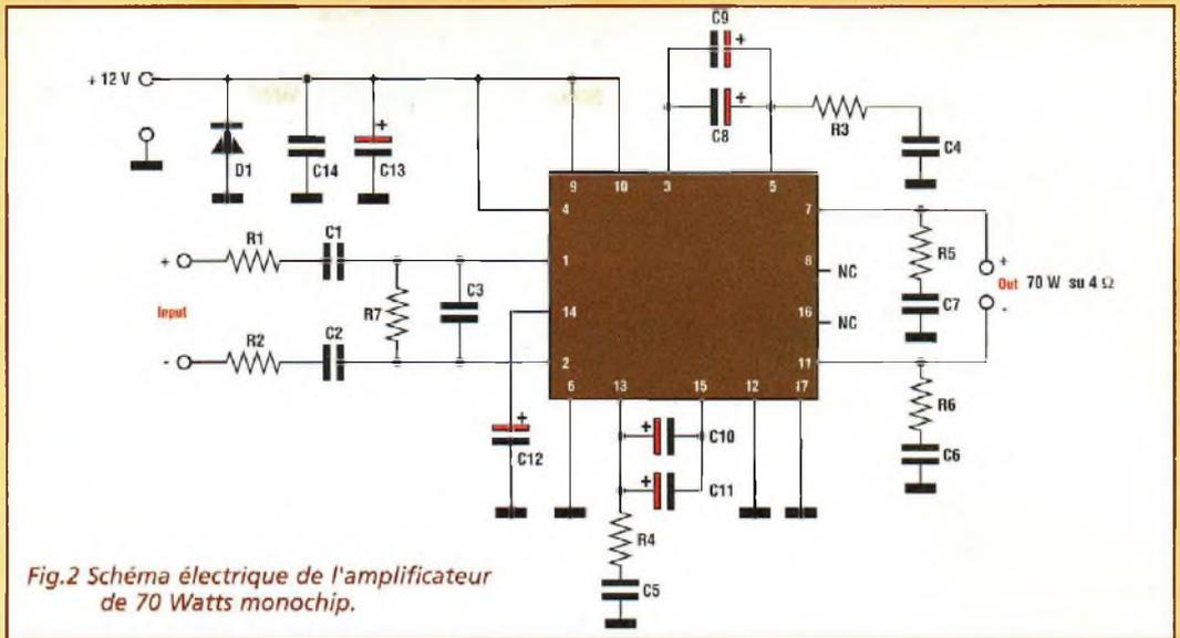
Fig.2 Schéma électrique de l'amplificateur de 70 Watts monochip.
