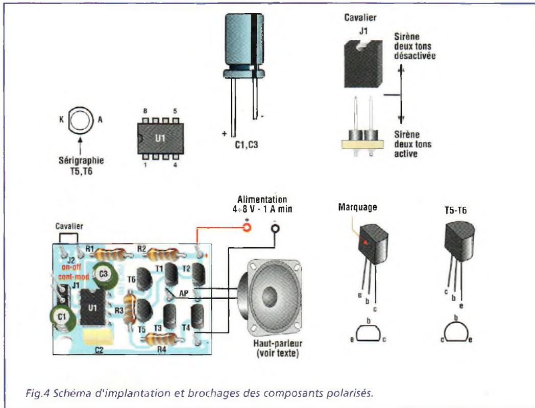
Fig.4 Schéma d'implantation et brochages des composants polarisés.
