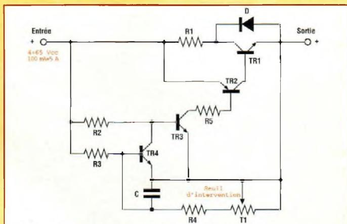
Fig.1 Schéma électrique du fusible électronique.
