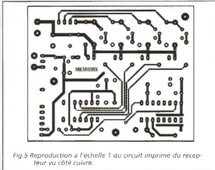
Fig.5 Reproduction à l'échelle 1 du circuit imprimé du récepteur vu côté cuivre.
