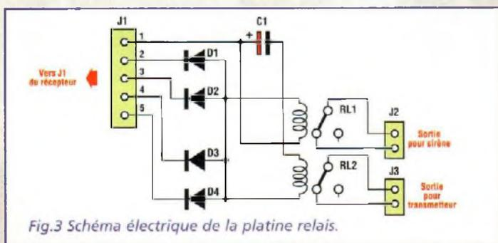
Fig.3 Schéma électrique de la platine relais.
