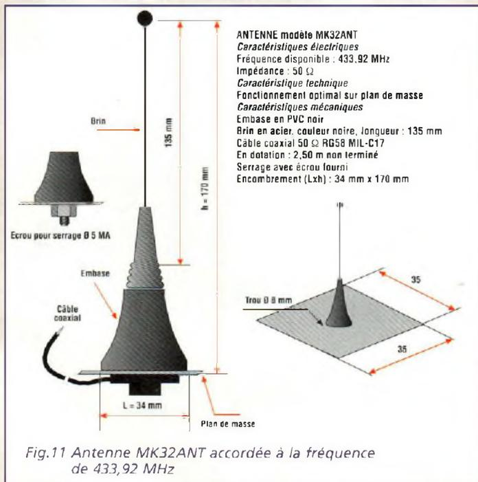
Fig.11 Antenne MK32ANT accordée à la fréquence de 433,92 MHz
