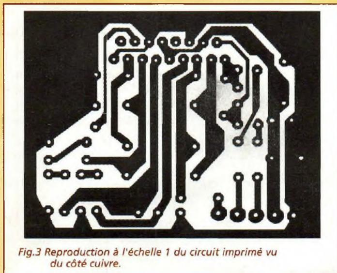
Fig.3 Reproduction à l'échelle 1 du circuit imprimé vu du côté cuivre.
