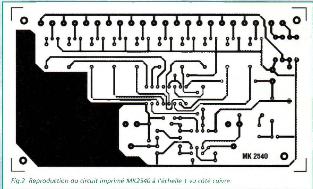
Fig.2 Reproduction du circuit imprimé MK2540 à l'échelle 1 vu côté cuivre.
