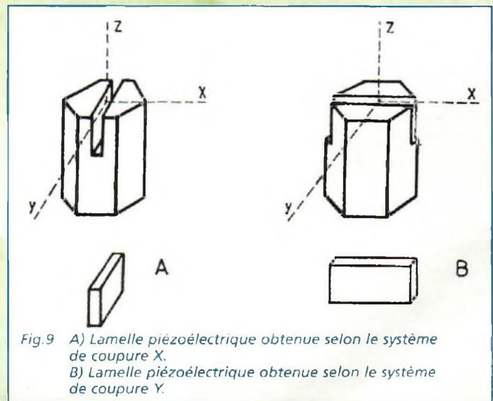
Fig.9 A) Lamelle piézoélectrique obtenue selon le système de coupure X. B) Lamelle piézoélectrique obtenue selon le système de coupure Y.
