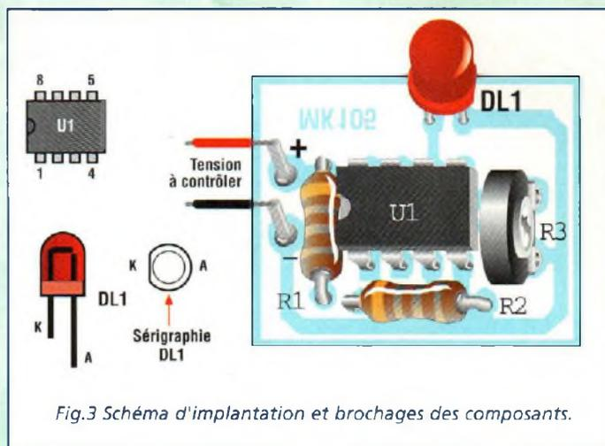
Fig.3 Schéma d'implantation et brochages des composants.
