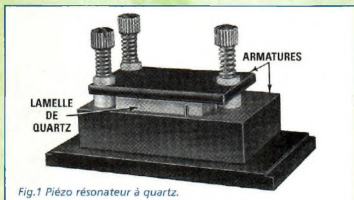
Fig.1 Piézo résonateur à quartz.
