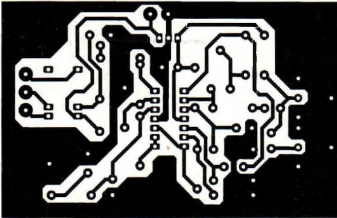
Fig.2 Reproduction du circuit imprimé à l'échelle 1.
