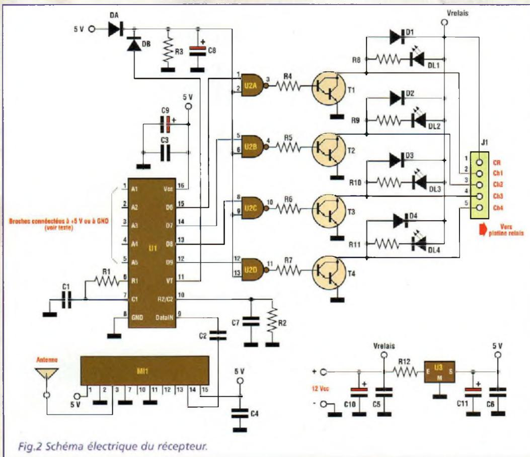
Fig.2 Schéma électrique du récepteur.
