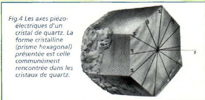
Fig.4 Les axes piézo-électriques d'un cristal de quartz. La forme cristalline (prisme hexagonal) présentée est celle communément rencontrée dans les cristaux de quartz.
