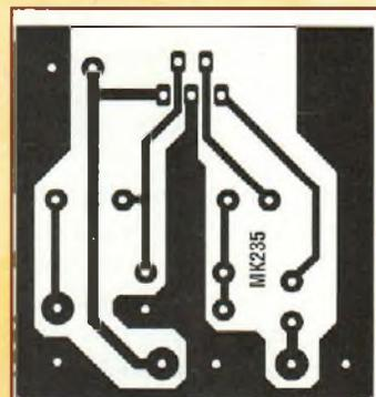
Fig.2 Reproduction du circuit imprimé MK235 à l'échelle 1 vu côté cuivre.
