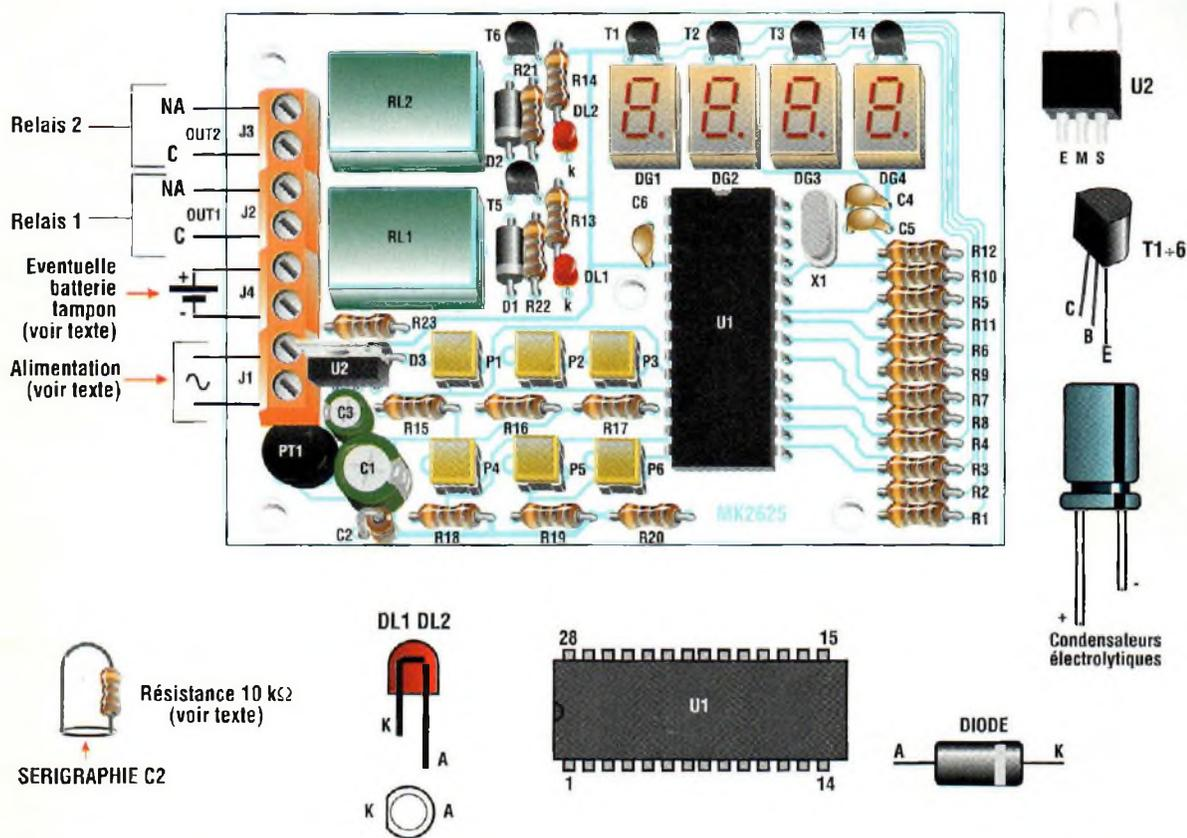
Fig.4 Schéma d'implantation et brochage des composants.
