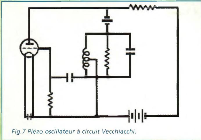
Fig.7 Piézo oscillateur à circuit Vecchiacchi.
