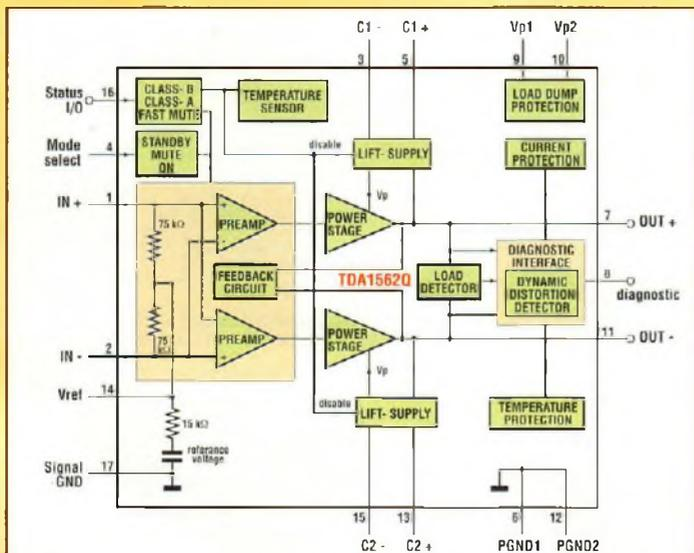
Fig.1 Schéma synoptique du circuit intégré TDA1562Q Philips.
