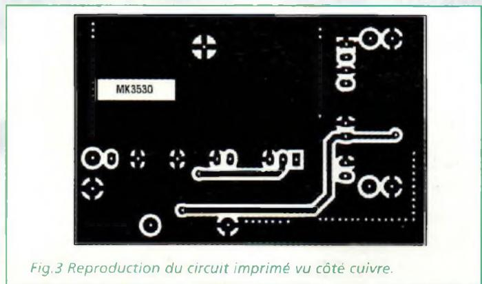
Fig.3 Reproduction du circuit imprimé vu côté cuivre.
