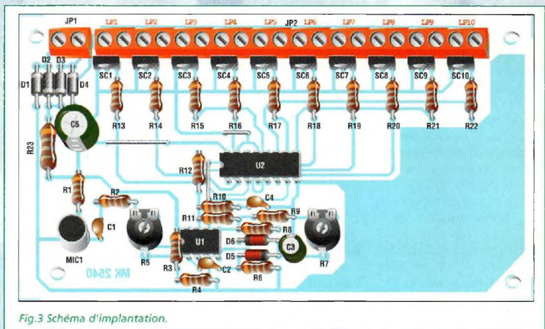
Fig.3 Schéma d'implantation.
