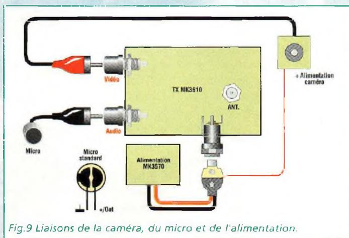
Fig.9 Liaisons de la caméra, du micro et de l'alimentation.
