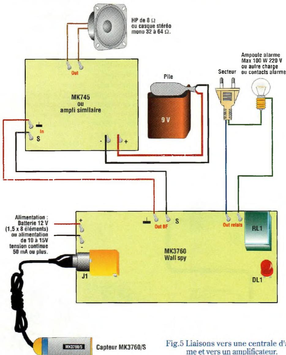
Fig.5 Liaisons vers une centrale d'alarme et vers un amplificateur.
