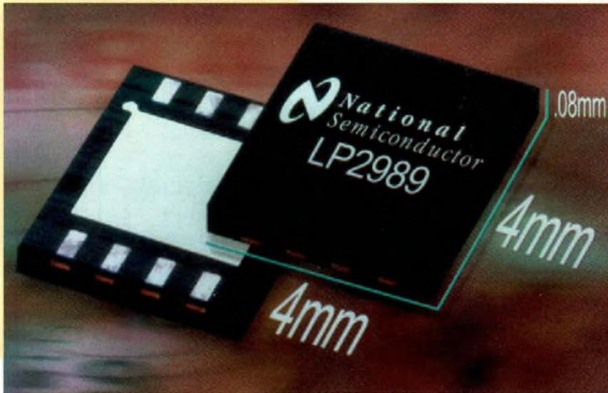
National Semiconductor annonce un régulateur de tension 500 mA complet à faible chute de tension (LDO) pour les applications de moyenne intensité dans les appareils informatiques et les portables nécessitant une alimentation à faible bruit. Le LP2989, encapsulé en boîtier LLP de la taille de la puce, a été
