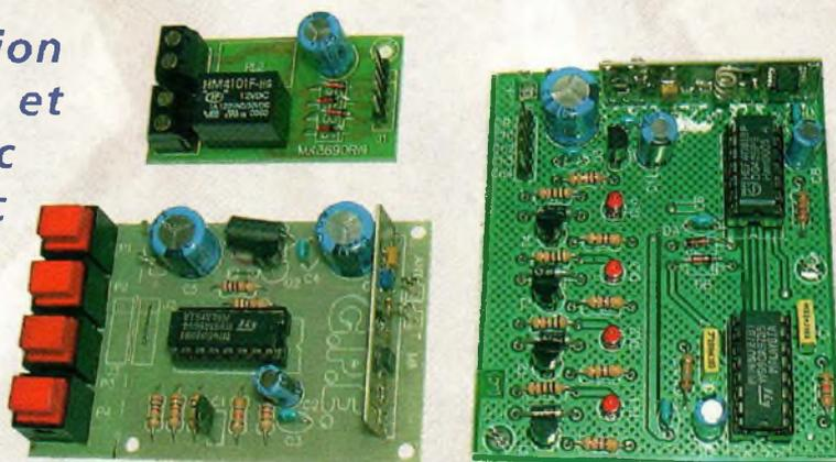
Le dispositif MK3690 est composé de trois étages bien différenciés. Les liaisons par radio sont assurées par l'utilisation d'une antenne adéquate qui permet de couvrir des distances de l'ordre d'un kilomètre. Les trois parties qui composent le dispositif sont :
