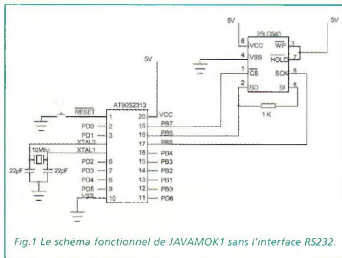
Fig.1 Le schéma fonctionnel de JAVAMOK1 sans l'interface RS232.
