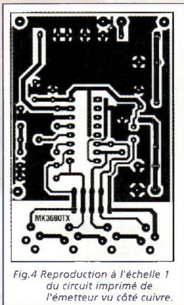
Fig.4 Reproduction à l'échelle 1 du circuit imprimé de l'émetteur vu côté cuivre.
