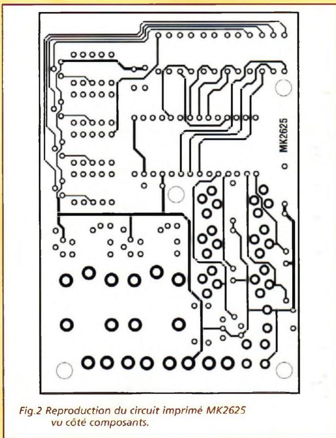
Fig.2 Reproduction du circuit imprimé MK2625 vu côté composants.
