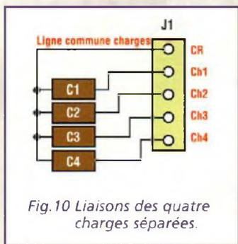
Fig.10 Liaisons des quatre charges séparées.
