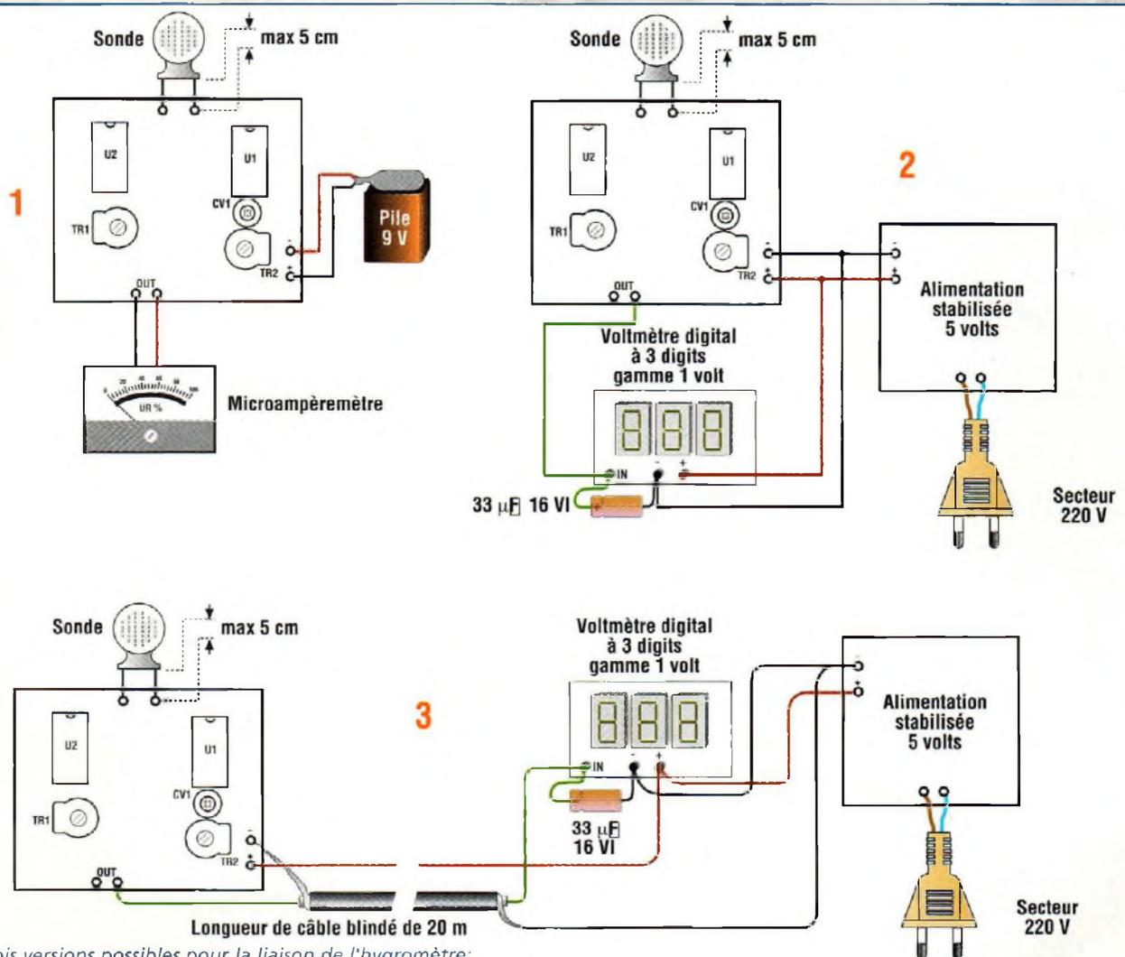
Fig.4 Les trois versions possibles pour la liaison de l'hygromètre:
