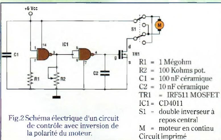
Fig.2 Schéma électrique d'un circuit de contrôle avec inversion de la polarité du moteur.
