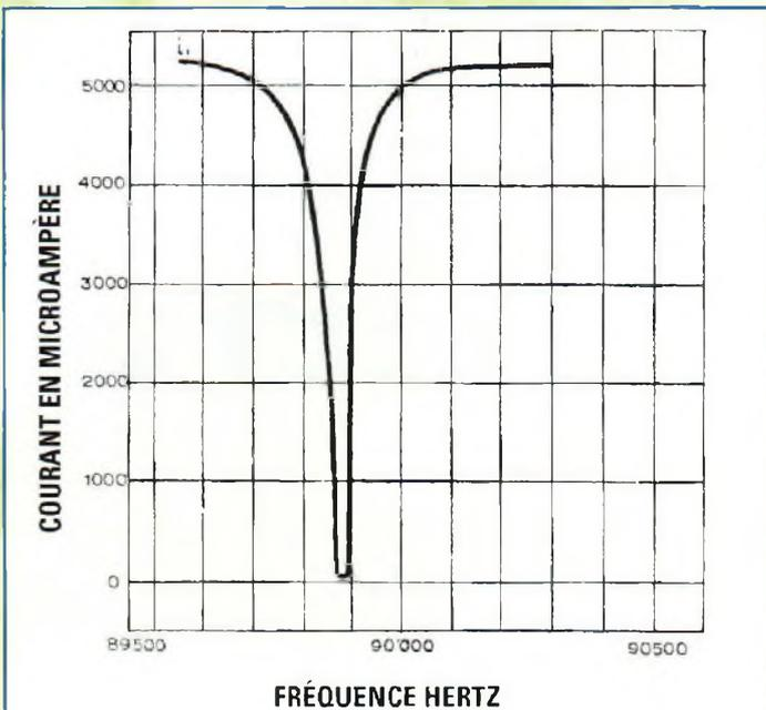
Fig.3 Variation du courant dans le circuit de fig.2 en correspondance de la fréquence de résonance de la lamelle de quartz.
