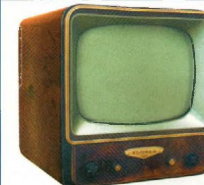
16- Visiola VT330. Tube à rayons cathodiques de 17". 18 Lampes, 2 diodes à cristal, 9 canaux.
