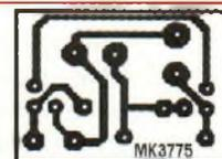
Fig.2 Reproduction à l'échelle 1 du circuit imprimé vu côté cuivre.
