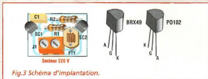
Fig.3 Schéma d'implantation.
