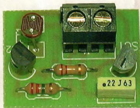
L'interrupteur automatique spécial animation donne une touche plus vivante aux guirlandes d'ampoules qui embellissent l'arbre de Noël ou les éclairages d'ambiance, par une adaptation permanente aux variations de luminosité. Il s'agit en pratique d'un interrupteur crépusculaire prévu pour commander les ampoules jusqu'à 100 W. Son action consiste à indexer l'éclairage
