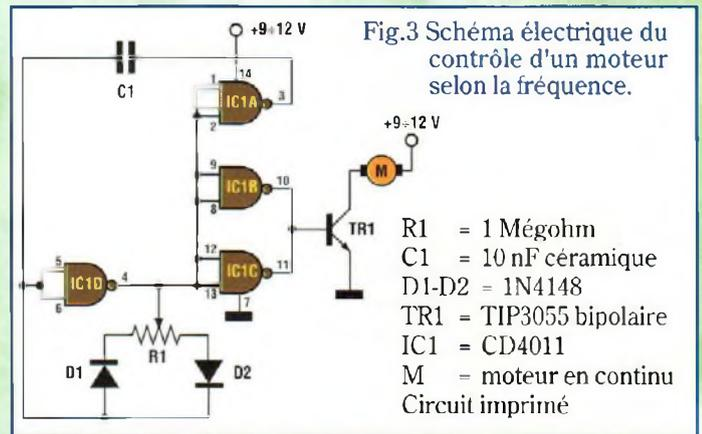
Fig.3 Schéma électrique du contrôle d'un moteur selon la fréquence.
