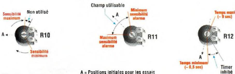
Fig.4 Réglage des ajustables.
