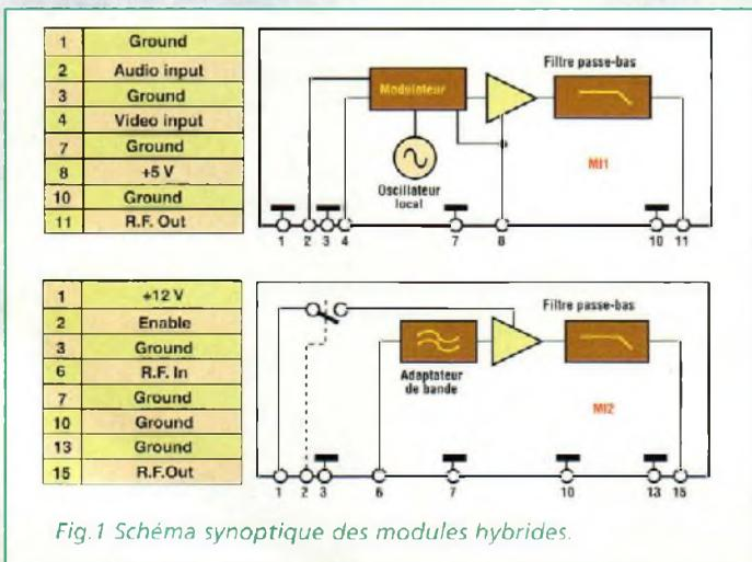
Fig.1 Schéma synoptique des modules hybrides.
