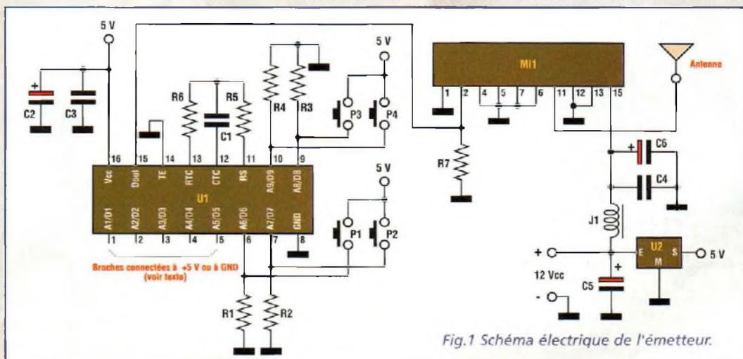
Fig.1 Schéma électrique de l'émetteur.
