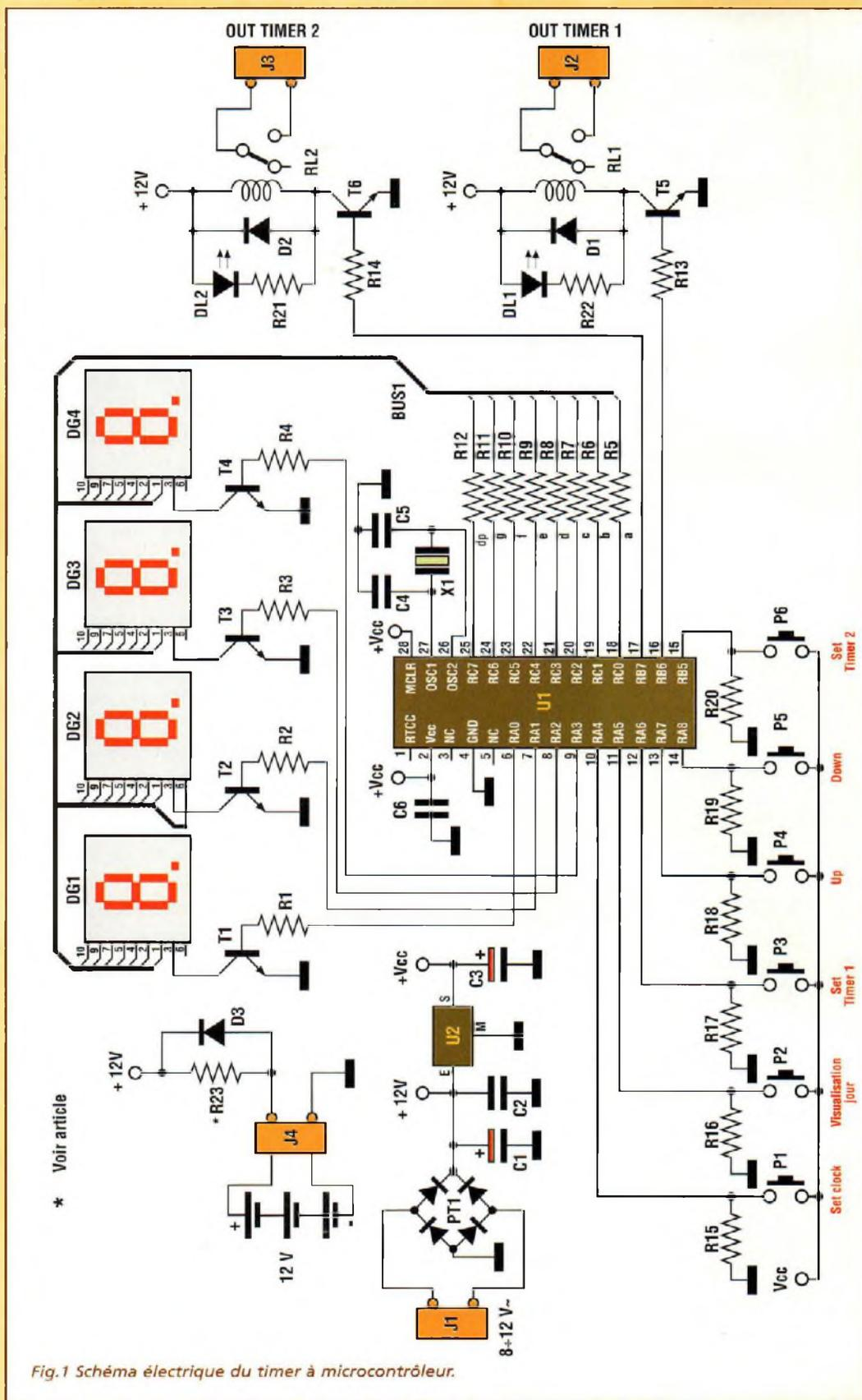
Fig.1 Schéma électrique du timer à microcontrôleur.
