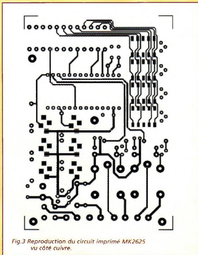
Fig.3 Reproduction du circuit imprimé MK2625 vu côté cuivre.
