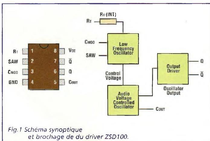
Fig.1 Schéma synoptique et brochage de du driver ZSD100.
