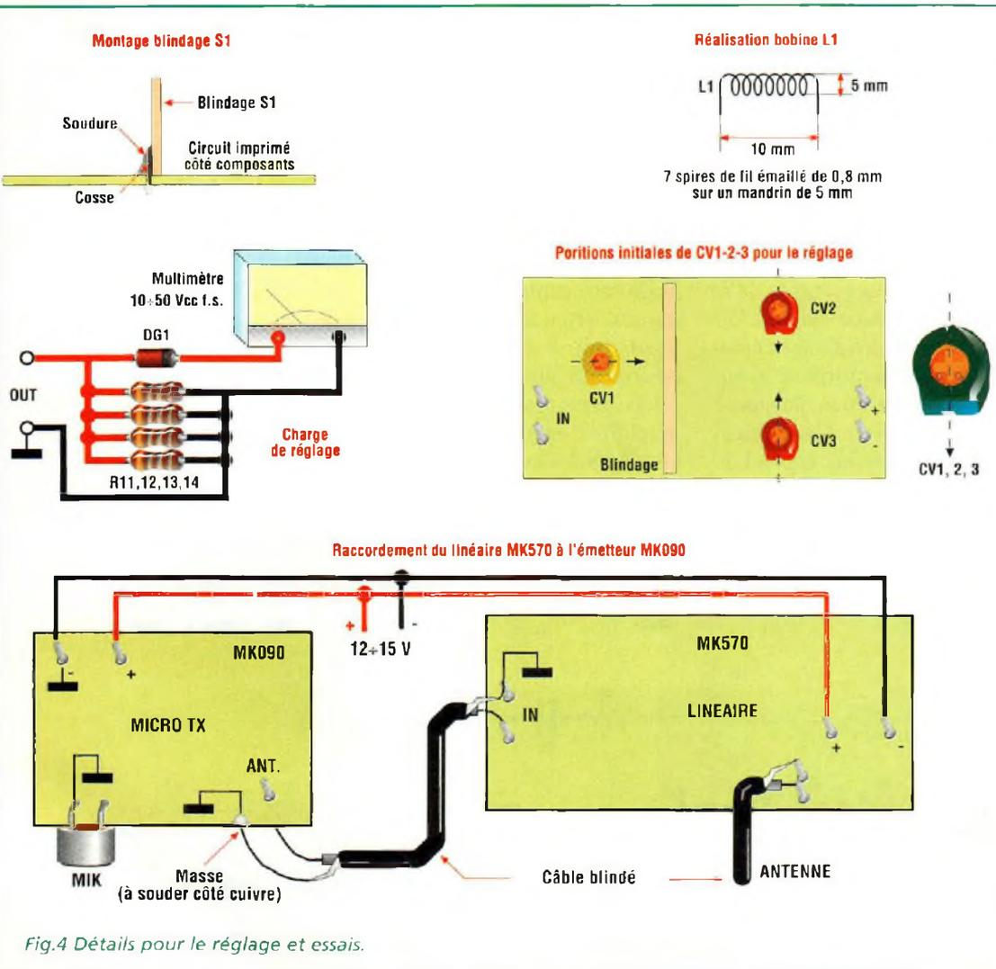
Fig. 4 Détails pour le réglage et essais.
