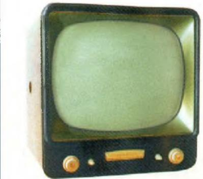
14- Magnadyne tube R.C. 21" (48x35cm). 18 Lampes, 6 canaux. Prise antenne 75/300 ohms
