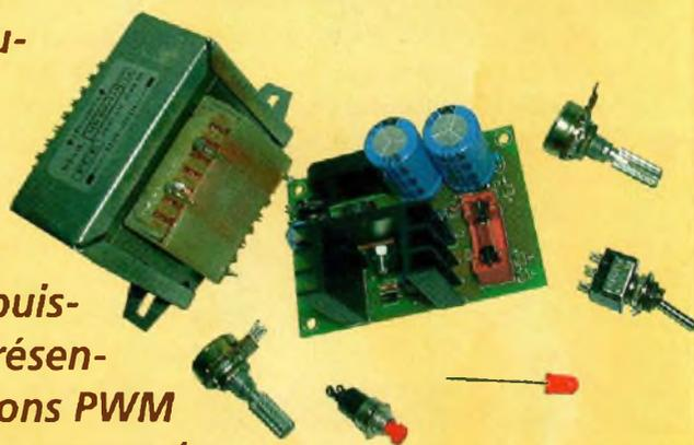
L'alimentation universelle de puissance MK3615 est dédiée à la fourniture d'énergie électrique pour le modélisme ferroviaire. Elle est capable de délivrer une tension de 0 à 14V avec une puissance de 40W.
