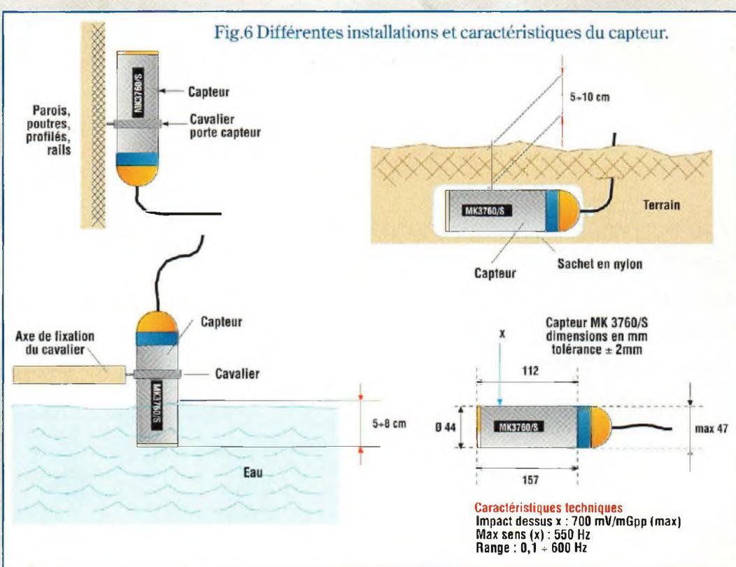
condes, 3 minutes et 6 minutes. La fig.6 montre la fixation du capteur MK3760S pour différentes applications, ainsi que ses caractéristiques électriques.
