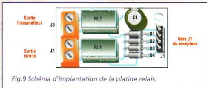
Fig.9 Schéma d'implantation de la platine relais.
