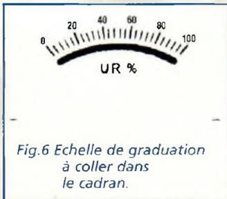
Fig.6 Echelle de graduation à coller dans le cadran.
