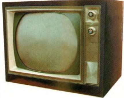
11- TV Zenit USA VHF-UHF couleur Modèle FBA 22A Boîtier métal 23 tubes électroniques en 120V.
