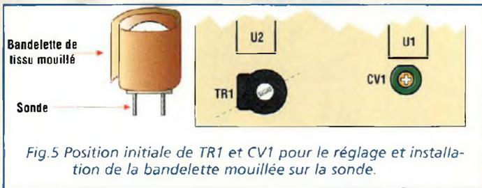
Fig.5 Position initiale de TR1 et CV1 pour le réglage et installation de la bandelette mouillée sur la sonde.
