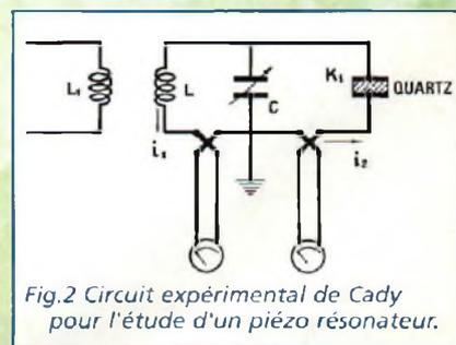
Fig.2 Circuit expérimental de Cady pour l'étude d'un piézo résonateur.
