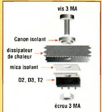
Fig.5 Détail de fixation sur le dissipateur
