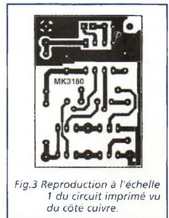
Fig.3 Reproduction à l'échelle 1 du circuit imprimé vu du côté cuivre.
