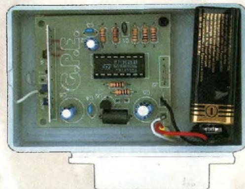
relié à la tension 12Volts continu d'entrée. Le filtre formé par l'inductance J1 avec C4-C8 évite le retour sur la ligne d'alimentation des résiduelles de radiofréquence.
