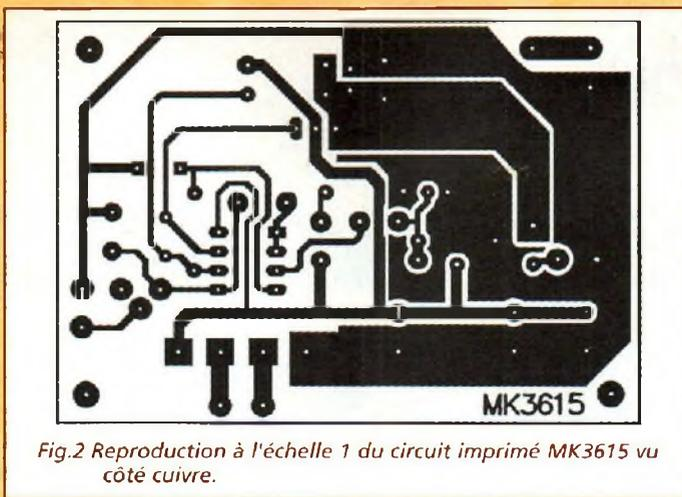
Fig.2 Reproduction à l'échelle 1 du circuit imprimé MK3615 vu côté cuivre.
