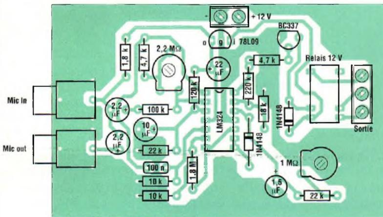
Fig.3 Schéma d'implantation.
