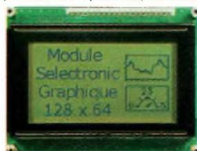
Contrôleur : KS0107/0108 • Avec convertisseur DC/DC intégré (réglage de contraste) • Alim. : 5V/160mA • Fenêtre : 72 x 40 mm • Dim. : 93 x 70 x 15 mm.
