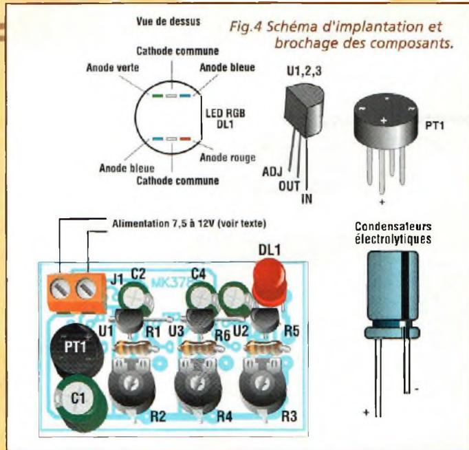
fonctionnement de U1, U2 et U3. Durant le fonctionnement, le maintien de la luminosité maximum sur le chip bleu, soit R4 en butée horaire, provoque un échauffement intensif de U3. Ce phénomène est absolument normal car U3 travaille à son courant maximum.
