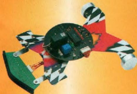
Suivi de ligne par 7 capteurs infrarouges • Propulsion par 2 moteurs • Mise en route par signal sonore • Fourni avec servo-moteur • Alimentation Électronique + servo : 4 piles ou accus de type R6, propulsion : 3 accus de type R6 • Dimensions : 31 x 22 x 9 cm.
