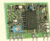
Très haute qualité de l'image et du son. Bande UHF : 479,5 MHz (canal 22). Peut être utilisé avec n'importe quelle source vidéo standard, réception sur n'importe quel récepteur TV standard.
