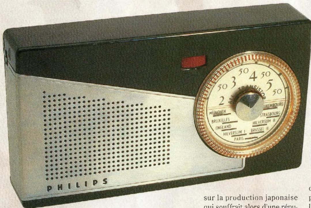
*Une présentation sobre et des matériaux de qualité. Le grand cadran circulaire transparent permet de sélectionner les stations. Un bouton de volume équipé d'une molette rouge sert également de marche arrêt. Le compartiment pile est accessible par la face arrière de l'appareil qu'une vis moletée permet de dégager. Le poids de l'appareil confirme l'impression de robustesse que dégage ce poste à la musicalité excellente.*
