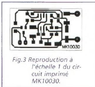
Fig.3 Reproduction à l'échelle 1 du circuit imprimé MK10030.
