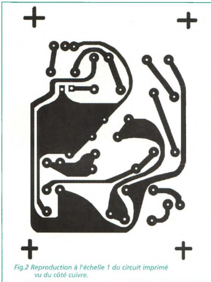
Fig.2 Reproduction à l'échelle 1 du circuit imprimé vu du côté cuivre.
