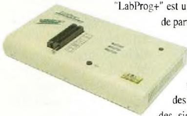
"LabProg+" est un programmeur universel professionnel qui de part ses performances haut de gamme est capable de supporter la plupart des composants programmables (quelque soit leur type ou technologie). Son électronique de commande révolutionnaire lui permet de générer des niveaux logiques, des "tirages" bas ou haut, des signaux d'horloges, des masses, une tension
