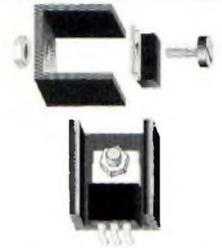
Fig.4 Montage des triac à l'intérieur du radiateur de refroidissement.
