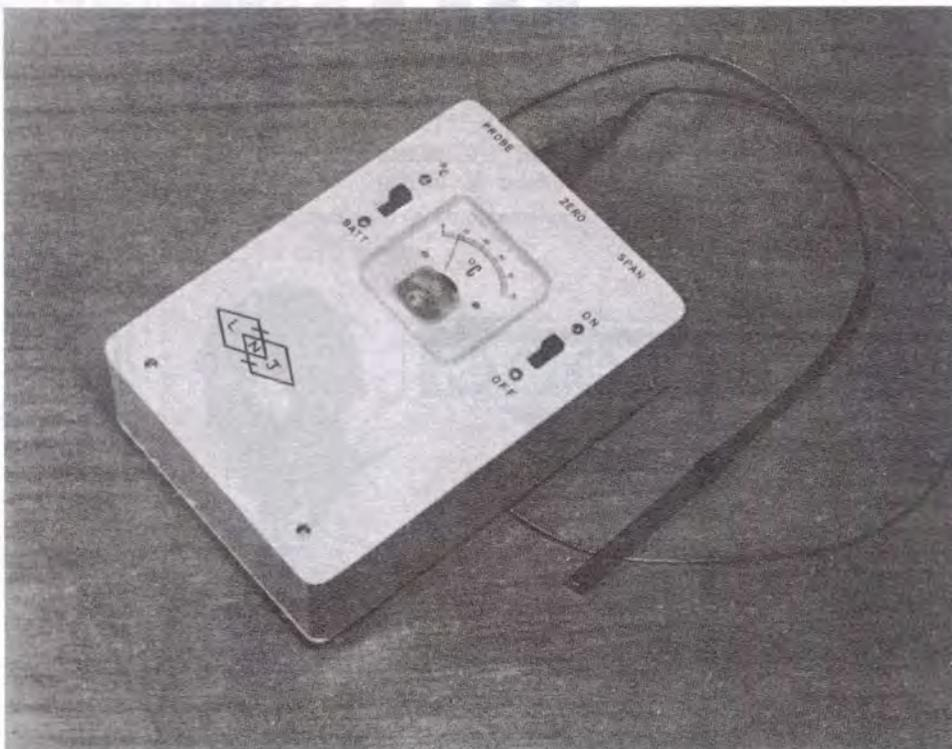
Un qualsiasi diodo può essere impiegato come sonda termoelettrica.
