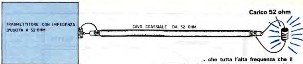
... che tutta l'alta frequenza che il trasmettitore è in grado di erogare venga assorbita dall'antenna è necessario che l'impedenza di uscita del trasmettitore, quella del cavo coassiale, e quella dell'antenna siano dello stesso valore. Così se il trasmettitore ha una impedenza d'uscita di 52 Ohm, sarà necessario che il cavo coassiale e l'antenna siano anch'essi da 52 Ohm.
