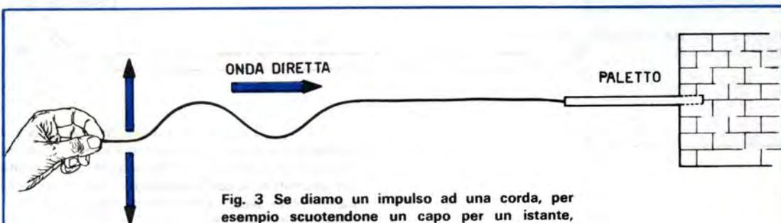
**Fig. 3** Se diamo un impulso ad una corda, per esempio scuotendone un capo per un istante, sulla corda si genera un'onda che, partendo da un estremo si sposta velocemente verso l'estremo opposto. Quando l'onda giunge alla fine della corda si possono avere due comportamenti diversi, a seconda del tipo di sostegno (carico) cui la corda è ancorata, come illustrato in fig. 4 e 5.
