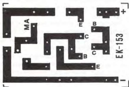
Fig. 4 Dimensioni del circuito stampato del termometro a grandezza naturale. Tale circuito come descritto in articolo è reperibile presso la nostra redazione con la sigla EK. 153.
