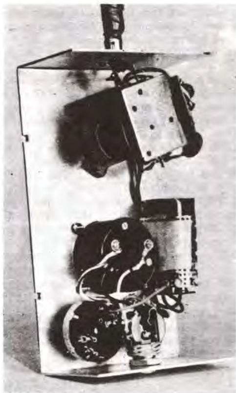
Fig. 4 Nella foto un montaggio sperimentale del grid-dip descritto nell'articolo, come si nota i vari componenti possono anche essere disposti molto diversamente da come disegnato in fig. 3, purché si abbia l'accortezza di tenere corti i collegamenti del condensatore variabile alla presa della bobina L1, ed a quelli del Fet.
