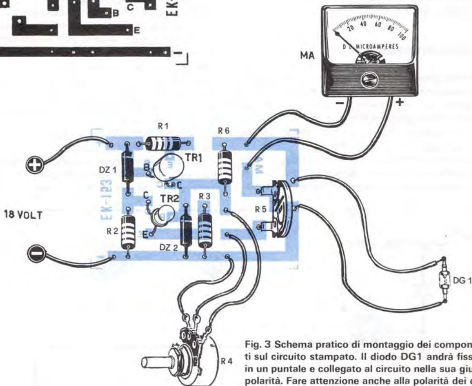
Fig. 3 Schema pratico di montaggio dei componenti sul circuito stampato. Il diodo DG1 andrà fissato in un puntale e collegato al circuito nella sua giusta polarità. Fare attenzione anche alla polarità dei diodi zener DZ1 e DZ2.
