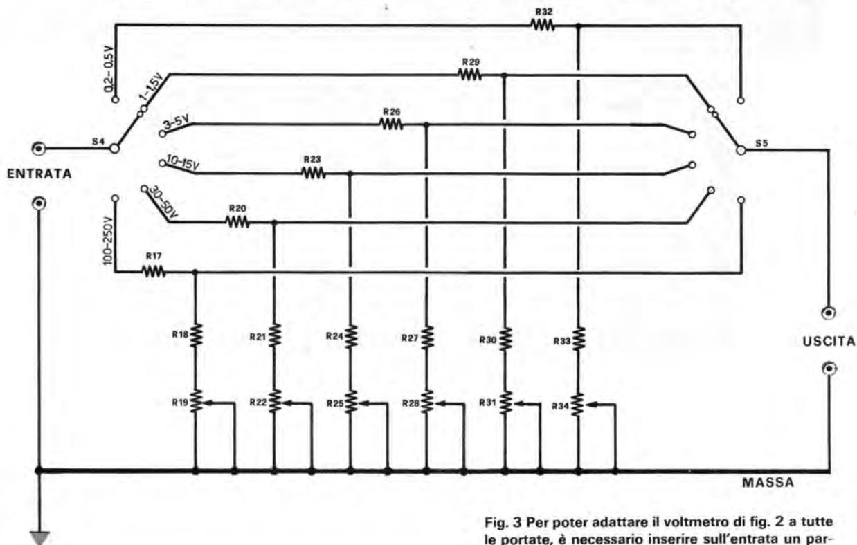
Fig. 3 Per poter adattare il voltmetro di fig. 2 a tutte le portate, è necessario inserire sull'entrata un partitore di tensione come questo illustrato. Nel partitore sono presenti 6 trimmer indispensabili per poter tarare ogni portata sul valore desiderato di fondo scala.
