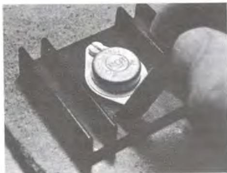
Appoggiando la nostra sonda sopra a qualsiasi superficie, il termometro ci indicherà quasi istantaneamente la temperatura esistente. Tale termometro risulterà quindi utilissimo per controllare durante il funzionamento la temperatura dei transistor.
