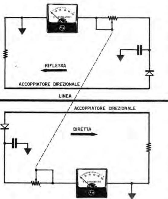
**Fig. 10** Collegando quindi lungo alla linea, due accoppiatori direzionali, e applicando in uno il diodo dal lato rivolto verso il trasmettitore, e sull'altro dal lato rivolto verso all'antenna, noi potremo in uno leggere la tensione DIRETTA e sull'altro la tensione RIFLESSA.
