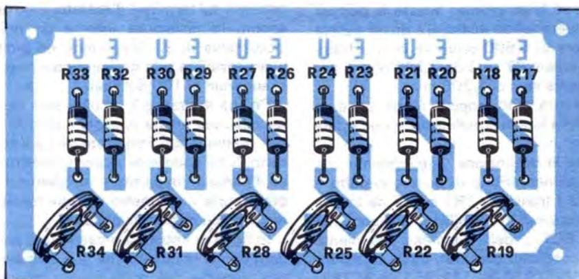
Per ottenere un montaggio veramente adeguato alle caratteristiche del voltmetro, anche il partitore verrà realizzato su circuito stampato. In questo modo i trimmer potranno essere agevolmente collocati, facilitando sia il montaggio sia la successiva regolazione.
