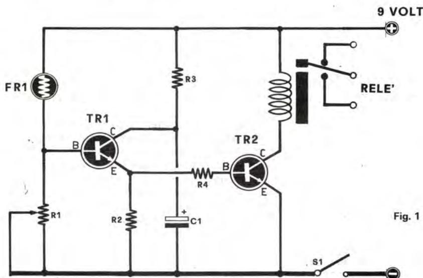
Fig. 1 Schema elettrico del fotoflash
