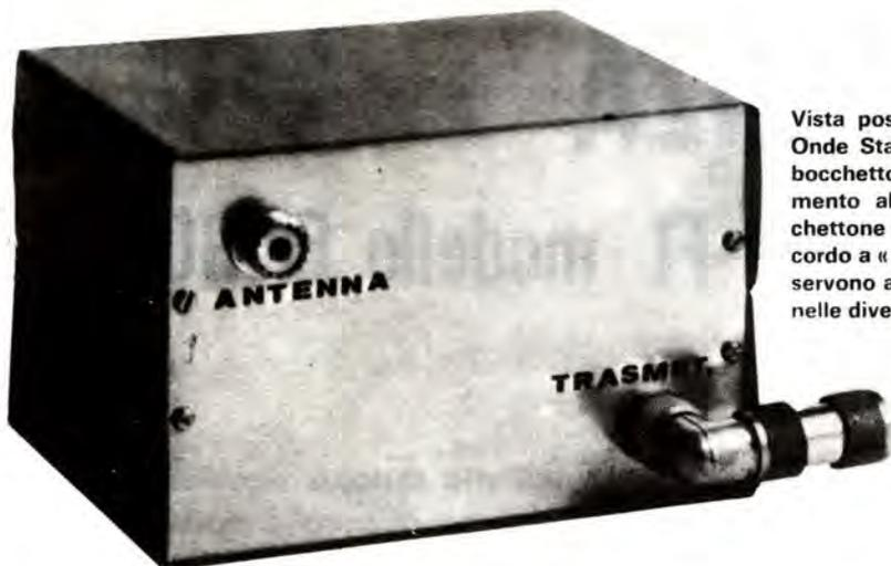
Vista posteriore di un prototipo di Misuratore di Onde Stazionarie. Sono chiaramente visibili i due bocchettoni coassiali UHF SO 239 per il collegamento all'antenna ed al trasmettitore. Nel bocchettone del trasmettitore si trova inserito un raccordo a « T » ed un raccordo maschio-maschio, che servono a rendere più agevole l'uso del Misuratore nelle diverse condizioni di impiego.
