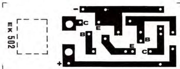
tensione di circa 1 volt che a sua volta polarizzerà la base di TR2. Questo secondo transistor entrerà anch'esso in conduzione e lascerà quindi scorrere attraverso l'avvolgimento del relé una corrente sufficiente ad eccitarlo con conseguente cortocircuito dei terminali di utilizzazione.
