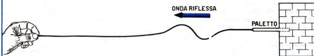
**Fig. 5** Quando il carico non è in grado di assorbire totalmente le oscillazioni, avviene che l'onda, una volta giunta al sostegno, non si dissipa completamente, ma una porzione torna indietro ripercorrendo tutta la corda in senso inverso. Nasce, cioè, una onda riflessa che riporta indietro parte della energia che era stata fornita: è evidente che una simile condizione non è affatto favorevole ad un buon trasferimento di energia dalla corda al carico.
