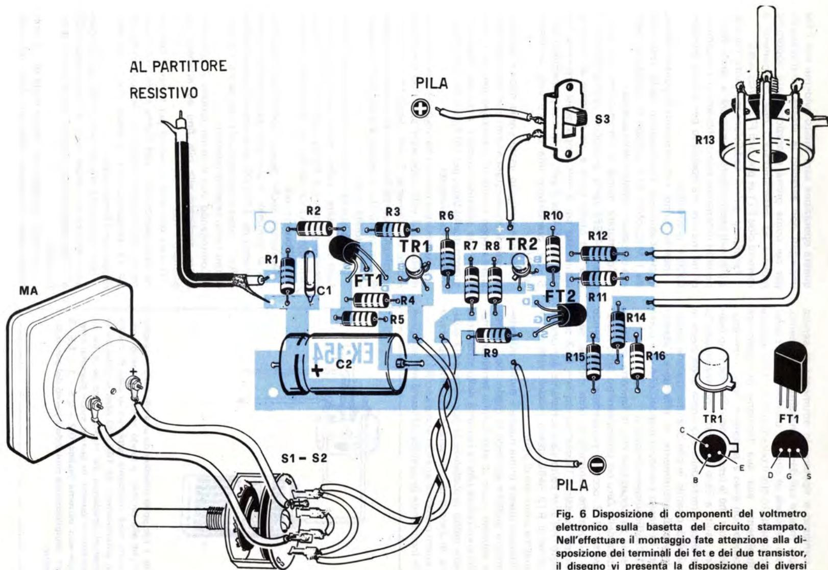
Fig. 6 Disposizione di componenti del voltmetro elettronico sulla basetta del circuito stampato. Nell'effettuare il montaggio fate attenzione alla disposizione dei terminali dei fet e dei due transistor, il disegno vi presenta la disposizione dei diversi terminali visti dal lato in cui fuoriescono dal corpo.
