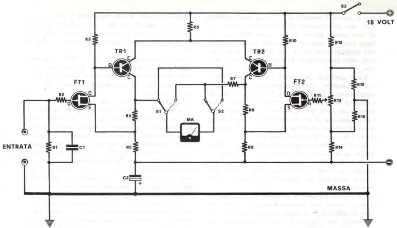
Fig. 2 Schema elettrico del voltmetro elettronico presentato in questo articolo. Il voltmetro oltre ad essere compensato termicamente dal circuito formato da FT2-TR2 dispone pure di un amplificatore supplementare, costituito da TR1 che ne aumenta la sensibilità in modo rilevante. La portata di questo voltmetro è di circa 100 millivolt fondo scala. Il deviatore S1-S2 serve per poter misurare tensioni sia positive che negative rispetto alla massa.
