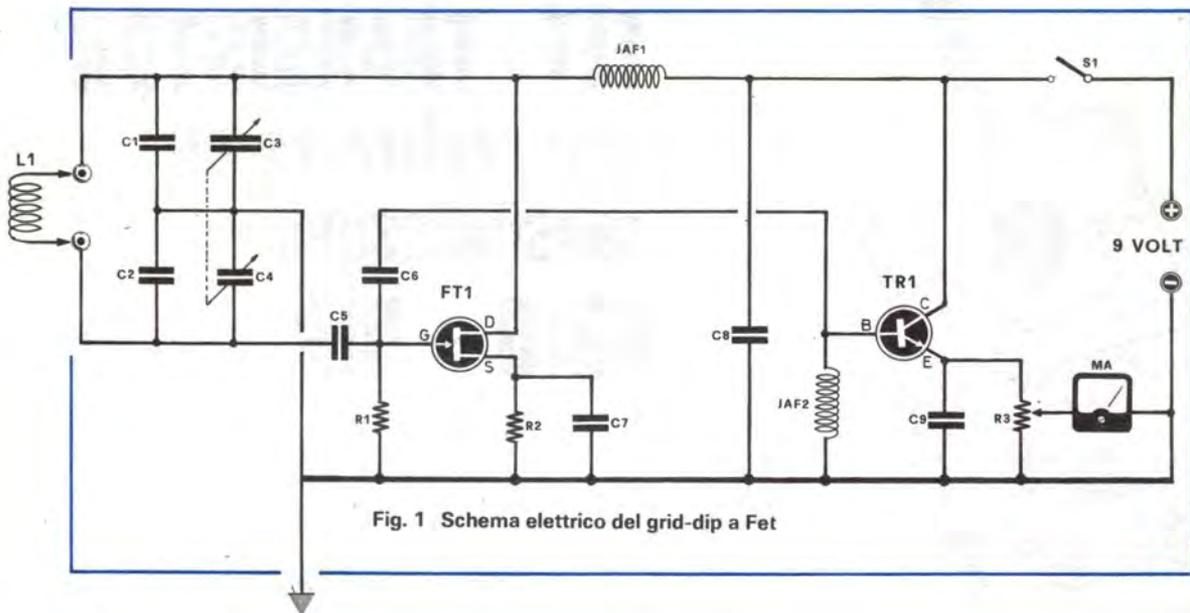
Fig. 1 Schema elettrico del grid-dip a Fet
