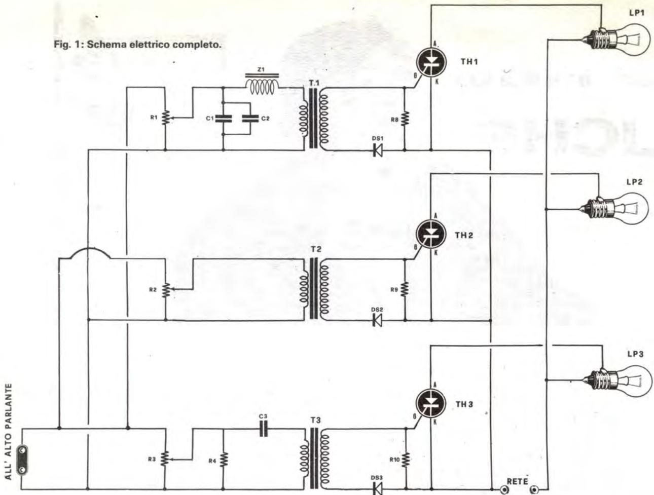
assorbita dalla lampadina è di 0,45 ampere (da  $100 : 220 = 0,45$  ampere), quindi, quando pensate di acquistare tale componente dovete considerare solamente quanti ampere massimi può erogare e quale tensione massima può sopportare così, se verrà usato per la tensione di rete di 220 volt sarà bene che vi orientiate verso un tipo adatto per una tensione superiore, 300 o 400 volt lavoro, se invece la lampadina impiegata è da 12 volt, sarà sufficiente un diodo con una tensione di 100 volt.
