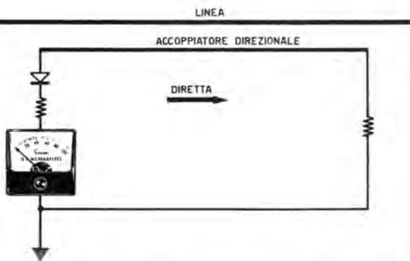
**Fig. 9** Se lungo alla linea che collega il trasmettitore all'antenna applichiamo in parallelo ad essa uno spezzone di filo, noi potremo rivelare, a seconda da che lato è stato posto il diodo rivelatore solo la tensione che viaggia in un certo senso, e non quella che viaggia in senso opposto.
