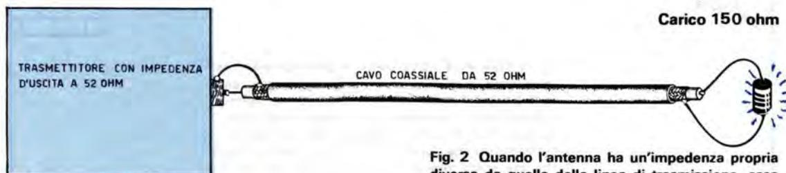
Fig. 2 Quando l'antenna ha un'impedenza propria diversa da quella della linea di trasmissione, essa non riesce ad assorbire tutta l'energia di A.F. disponibile, ma solo una parte di questa. La restante parte viene, quindi, riflessa verso il trasmettitore, causando non pochi inconvenienti.
