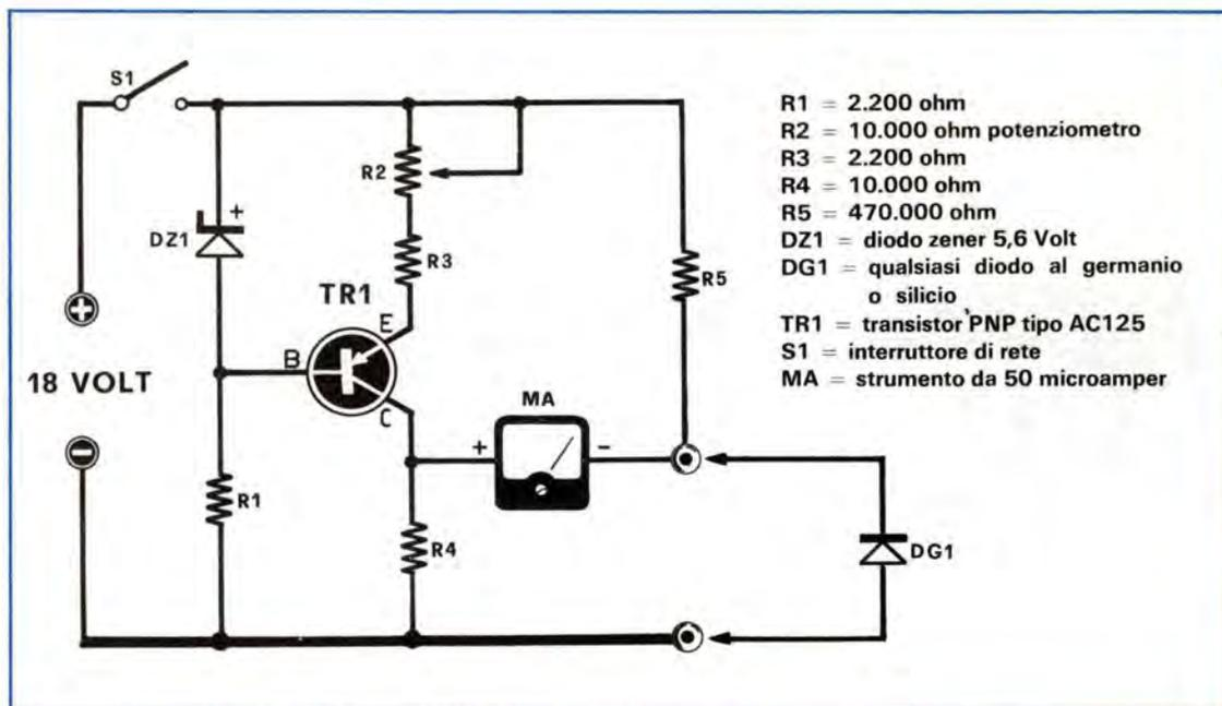
Sull'emettitore di questo transistor è inserito un potenziometro (in figura R2) necessario per l'azzeramento dello strumento indicatore.
