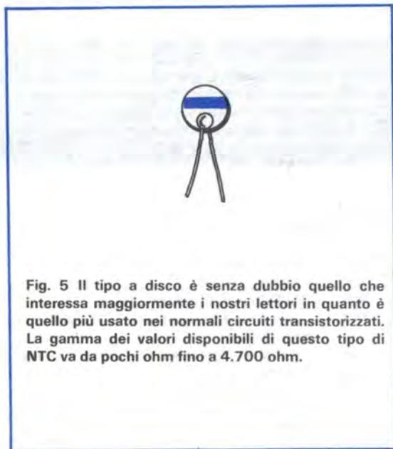
Fig. 5 Il tipo a disco è senza dubbio quello che interessa maggiormente i nostri lettori in quanto è quello più usato nei normali circuiti transistorizzati. La gamma dei valori disponibili di questo tipo di NTC va da pochi ohm fino a 4.700 ohm.
