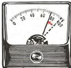
Fig. 16 Se la variazione di assorbimento durante la taratura fosse limitata dovremmo concludere che il circuito di sintonia finale risulta accordato su un'armonica, oppure la presa di collettore sulla bobina non è quella giusta, infine che il transistor non è adatto ad amplificare la frequenza in gioco.
