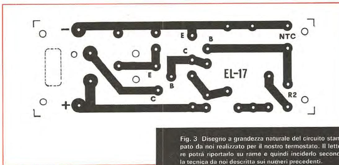
Fig. 3 Disegno a grandezza naturale del circuito stampato da noi realizzato per il nostro termostato. Il lettore potrà riportarlo su rame e quindi inciderlo secondo la tecnica da noi descritta sui numeri precedenti.
