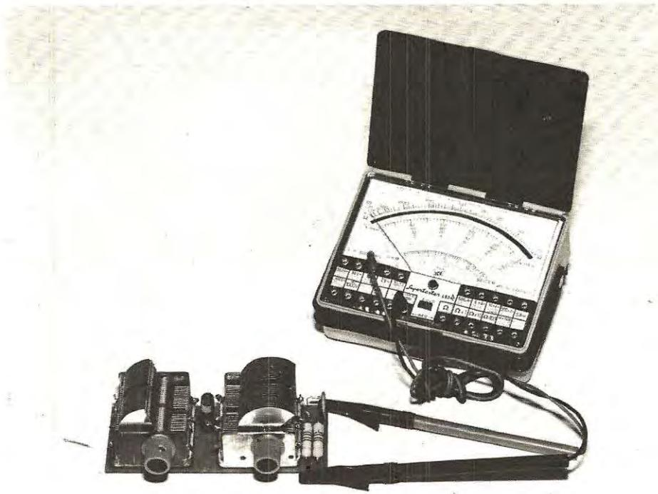
Fig. 4 Per poter adattare l'impedenza d'uscita del nostro trasmettitore della impedenza caratteristica di 75 ohm applicheremo ai capi di C9 due resistenze di 150 ohm 1 watt in parallelo (si ottiene così un valore ohmico di 75 ohm) un qualsiasi diodo al germanio (OA81-OA85-OA79 - ecc.) più un condensatore da 47.000 pF. L'accordo risulterà perfetto quando saremo riusciti, ruotando C8 e C9 ad ottenere in uscita la massima tensione.
