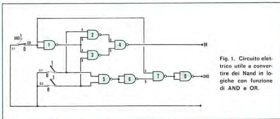
**Fig. 1. Circuito elettrico utile a convertire dei Nand in logiche con funzione di AND e OR.**
