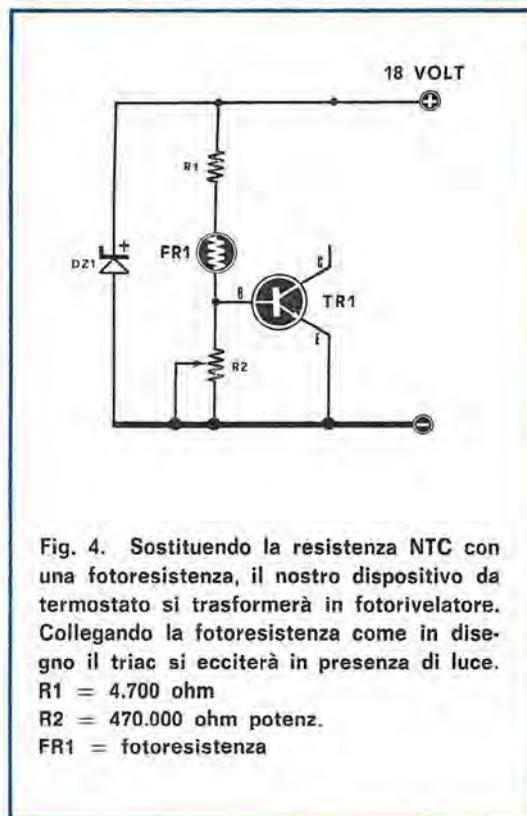
Fig. 4. Sostituendo la resistenza NTC con una fotoresistenza, il nostro dispositivo da termostato si trasformerà in fotorivelatore. Collegando la fotoresistenza come in disegno il triac si ecciterà in presenza di luce.
