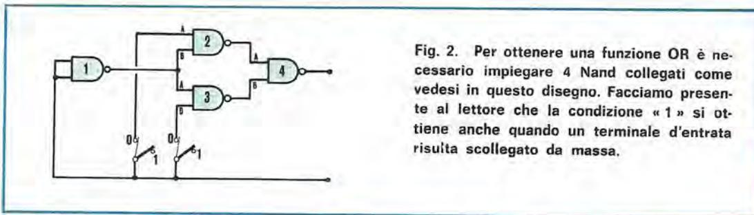
Fig. 2. Per ottenere una funzione OR è necessario impiegare 4 Nand collegati come vedesi in questo disegno. Facciamo presente al lettore che la condizione « 1 » si ottiene anche quando un terminale d'entrata risulta scollegato da massa.
