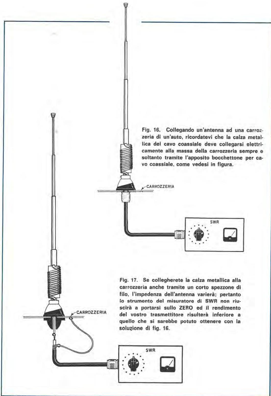
Fig. 16. Collegando un'antenna ad una carrozzeria di un'auto, ricordatevi che la calza metallica del cavo coassiale deve collegarsi elettricamente alla massa della carrozzeria sempre e soltanto tramite l'apposito bocchettone per cavo coassiale, come vedesi in figura.
