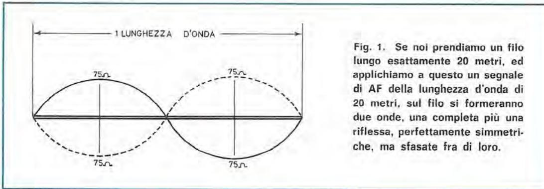
Fig. 1. Se noi prendiamo un filo lungo esattamente 20 metri, ed applichiamo a questo un segnale di AF della lunghezza d'onda di 20 metri, sul filo si formeranno due onde, una completa piú una riflessa, perfettamente simmetriche, ma sfasate fra di loro.
