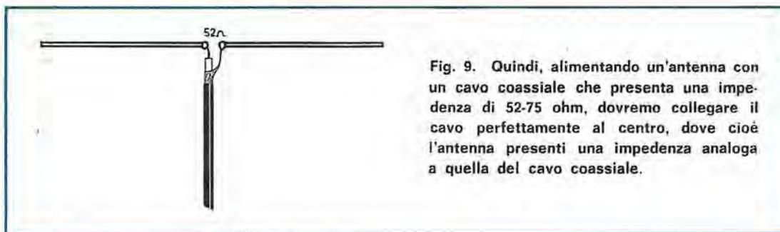
Fig. 9. Quindi, alimentando un'antenna con un cavo coassiale che presenta una impedenza di  $52,75\ \text{ohm}$ , dovremo collegare il cavo perfettamente al centro, dove cioè l'antenna presenti una impedenza analoga a quella del cavo coassiale.
