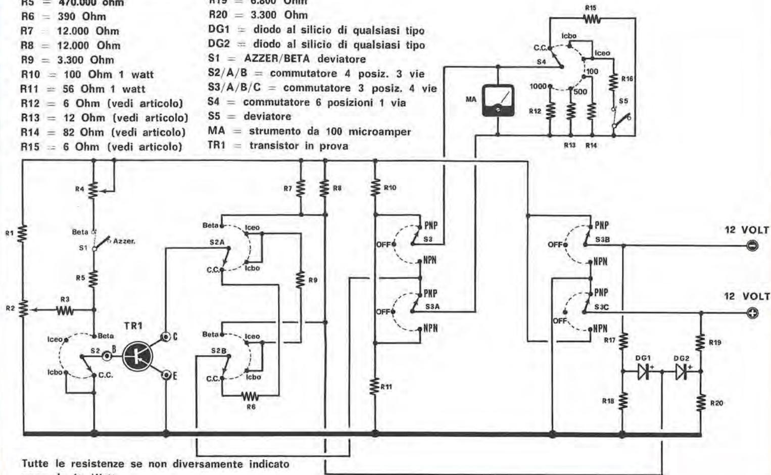
schema elettrico con la sigla S3-S3A-S3B-S3C. In posizione NPN noi applicheremo il positivo dei 12 volt sul collettore del transistor in prova e il negativo alla massa. Per i tipi PNP tale tensione risulterà invertita. Contemporaneamente il terminale negativo dello strumento in posizione NPN viene a trovarsi collegato al collettore del transistor in prova, mentre in posizione PNP ritroveremo il terminale negativo.
