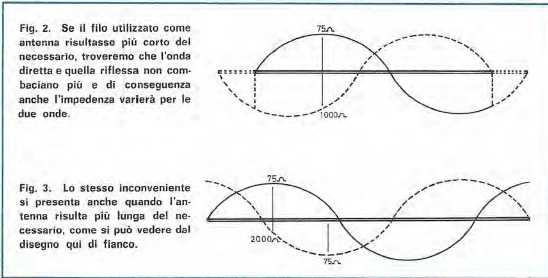
Fig. 2. Se il filo utilizzato come antenna risultasse piú corto del necessario, troveremo che l'onda diretta e quella riflessa non combaciano piú e di conseguenza anche l'impedenza varierà per le due onde.
