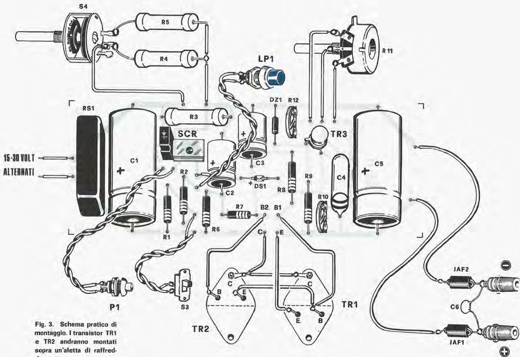
Fig. 3. Schema pratico di montaggio. I transistor TR1 e TR2 andranno montati sopra un'aletta di raffreddamento.
