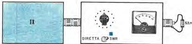
**Fig. 13.** In seguito ruoteremo il deviatore in posizione ONDA RIFLESSA. Se l'impedenza del trasmettitore risulterà identica a quella della resistenza applicata sul misuratore di SWR, la lancetta dello strumento dovrà portarsi completamente sullo ZERO. Tale condizione si presenterà anche quando, al posto della resistenza, inseriremo un'antenna la cui impedenza risulti esattamente di 52 ohm.
