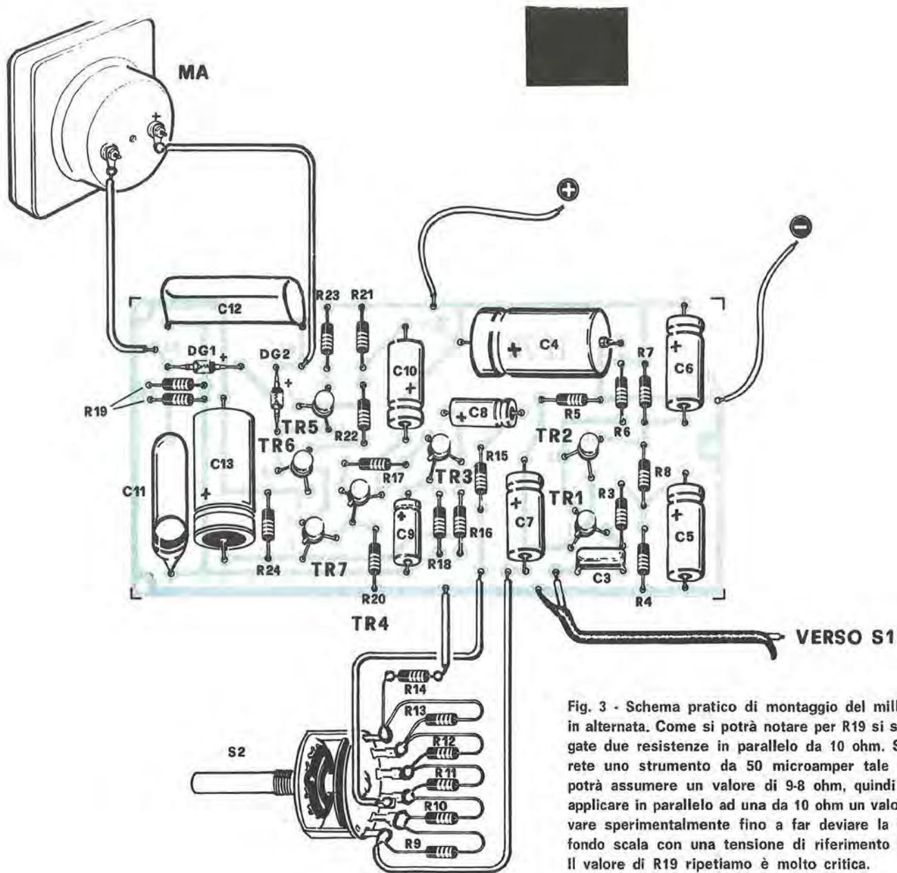
Fig. 3 - Schema pratico di montaggio del millivoltmetro in alternata. Come si potrà notare per R19 si sono impiegate due resistenze in parallelo da 10 ohm. Se utilizzerete uno strumento da 50 microamper tale resistenza potrà assumere un valore di 9-8 ohm, quindi occorrerà applicare in parallelo ad una da 10 ohm un valore da ricavare sperimentalmente fino a far deviare la lancetta a fondo scala con una tensione di riferimento da 1 volt. Il valore di R19 ripetiamo è molto critica.
