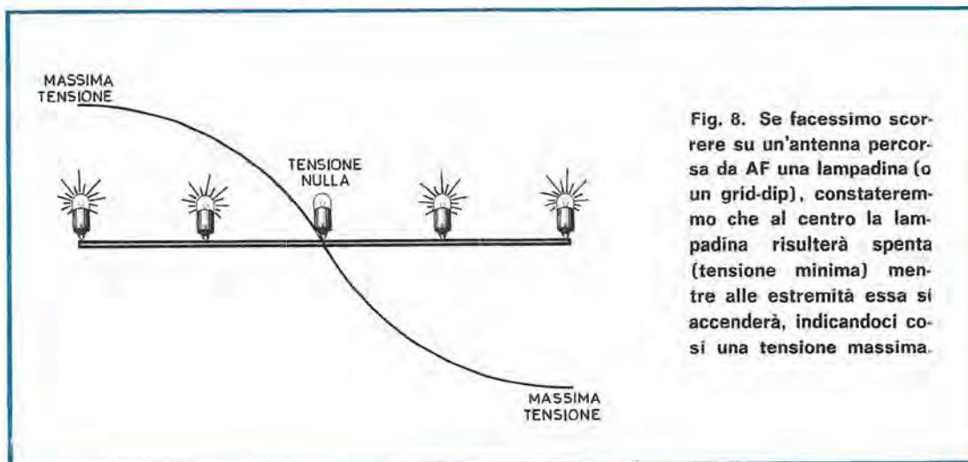
**Fig. 8.** Se facessimo scorrere su un'antenna percorsa da AF una lampadina (o un grid-dip), constateremo che al centro la lampadina risulterà spenta (tensione minima) mentre alle estremità essa si accenderà, indicandoci così una tensione massima.
