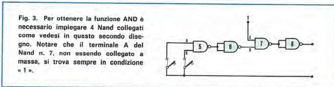
Fig. 3. Per ottenere la funzione AND è necessario impiegare 4 Nand collegati come vedesi in questo secondo disegno. Notare che il terminale A del Nand n. 7, non essendo collegato a massa, si trova sempre in condizione « 1 ».
