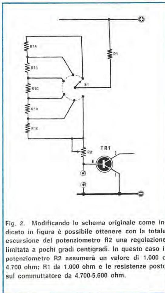
Fig. 2. Modificando lo schema originale come indicato in figura è possibile ottenere con la totale escursione del potenziometro R2 una regolazione limitata a pochi gradi centigradi. In questo caso il potenziometro R2 assumerà un valore di 1.000 o 4.700 ohm; R1 da 1.000 ohm e le resistenze poste sul commutatore da 4.700-5.600 ohm.
