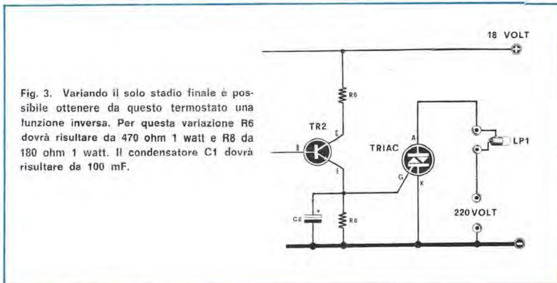
Fig. 3. Variando il solo stadio finale è possibile ottenere da questo termostato una funzione inversa. Per questa variazione R6 dovrà risultare da 470 ohm 1 watt e R8 da 180 ohm 1 watt. Il condensatore C1 dovrà risultare da 100 mF.
