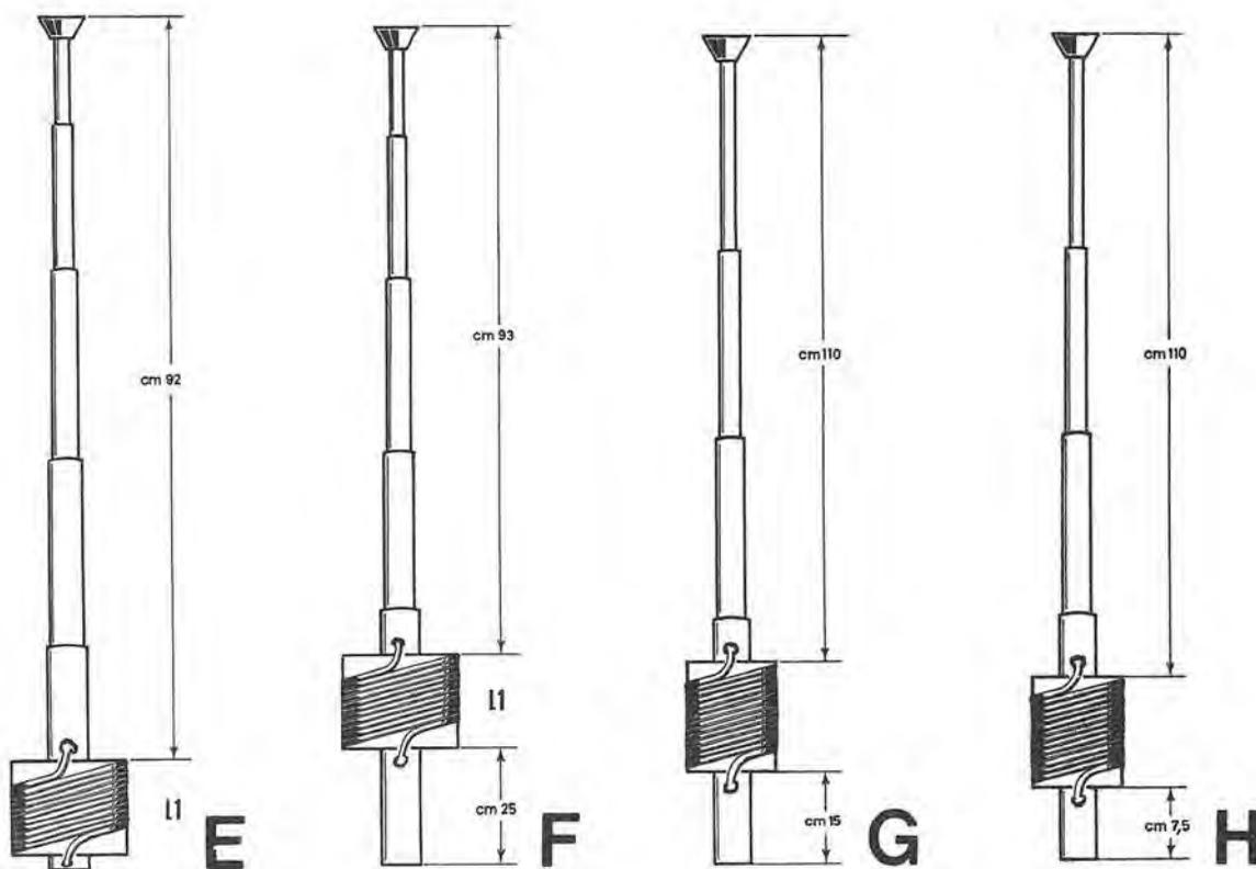
Fig. 15. Vi forniamo, in linea di massima, il numero di spire necessario ad una bobina di compensazione, in base alla lunghezza dello stilo impiegato e alla posizione nella quale questa verrà inserita. La lunghezza dell'antenna o il numero esatto delle spire della bobina di compensazione andranno poi ritoccati con l'aiuto del misuratore di onde stazionarie.
