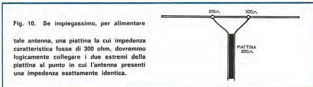
Fig. 10. Se impiegassimo, per alimentare
