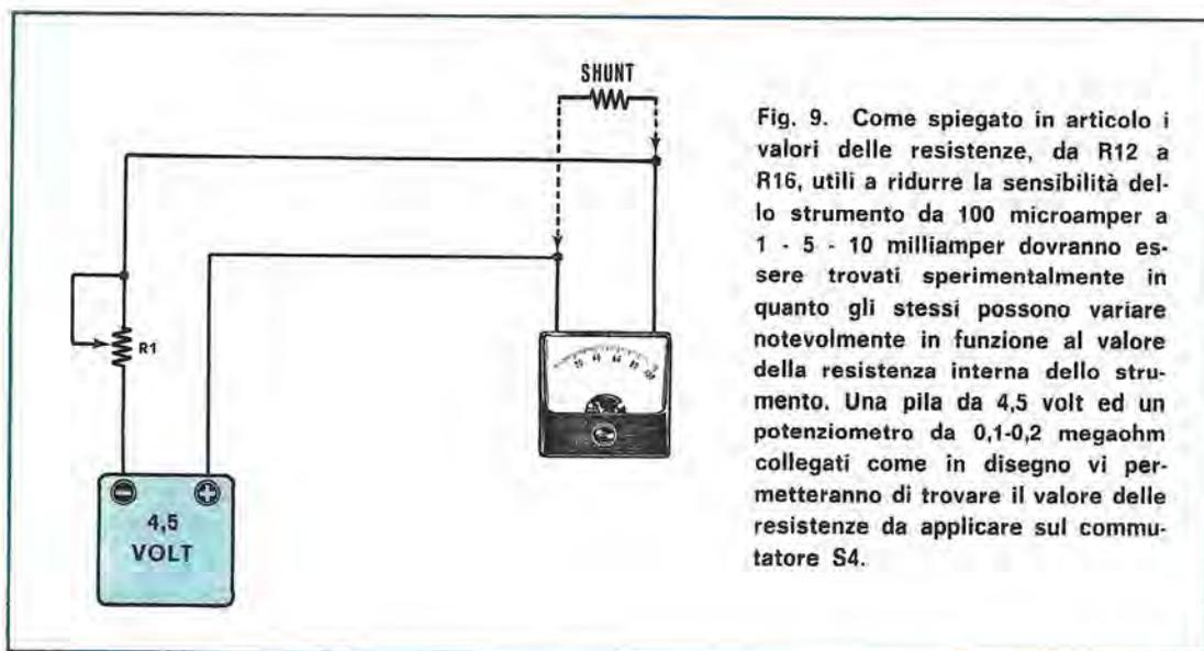
Fig. 9. Come spiegato in articolo i valori delle resistenze, da R12 a R16, utili a ridurre la sensibilità dello strumento da 100 microamper a 1 - 5 - 10 milliamper dovranno essere trovati sperimentalmente in quanto gli stessi possono variare notevolmente in funzione al valore della resistenza interna dello strumento. Una pila da 4,5 volt ed un potenziometro da 0,1-0,2 megohm collegati come in disegno vi permetteranno di trovare il valore delle resistenze da applicare sul commutatore S4.
