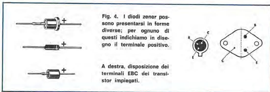
Fig. 4. I diodi zener possono presentarsi in forme diverse; per ognuno di questi indichiamo in disegno il terminale positivo.
