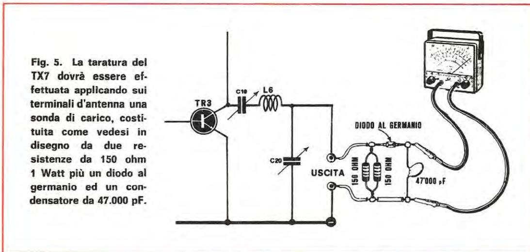
ratura degli stadi AF dovrà risultare ancora inserita. Se tutto è a posto, parlando sul microfono si potrà constatare che la tensione in uscita (misurata dal tester collegato alla sonda) passerà dai 8-9 volt iniziali ad un valore maggiore; in linea di massima si dovranno raggiungere gli 11-12 volt.
