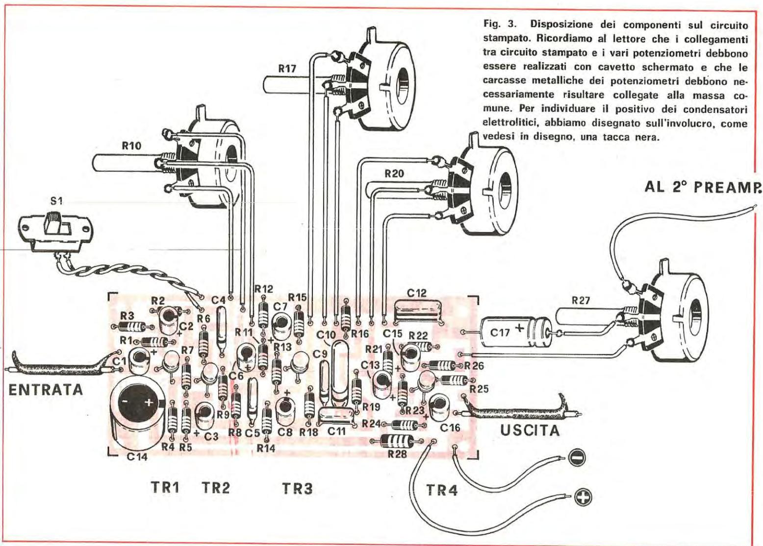
Fig. 3. Disposizione dei componenti sul circuito stampato. Ricordiamo al lettore che i collegamenti tra circuito stampato e i vari potenziometri debbono essere realizzati con cavetto schermato e che le carcasse metalliche dei potenziometri debbono necessariamente risultare collegate alla massa comune. Per individuare il positivo dei condensatori elettrolitici, abbiamo disegnato sull'involucro, come vedesi in disegno, una tacca nera.
