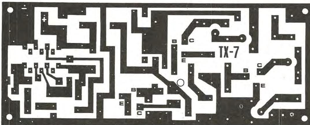
**Fig. 2.** Disegno del circuito stampato del TX7 da noi fornito in fibra di vetro del tipo per UHF. Al lettore che volesse ricopiarlo consigliamo di impiegare per questo circuito del « fibraglass » per VHF o meglio ancora per UHF.
