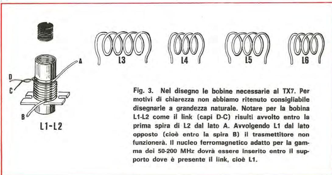
**Fig. 3.** Nel disegno le bobine necessarie al TX7. Per motivi di chiarezza non abbiamo ritenuto consigliabile disegnarle a grandezza naturale. Notare per la bobina L1-L2 come il link (capi D-C) risulti avvolto entro la prima spira di L2 dal lato A. Avvolgendo L1 dal lato opposto (cioè entro la spira B) il trasmettitore non funzionerà. Il nucleo ferromagnetico adatto per la gamma dei 50-200 MHz dovrà essere inserito entro il supporto dove è presente il link, cioè L1.
