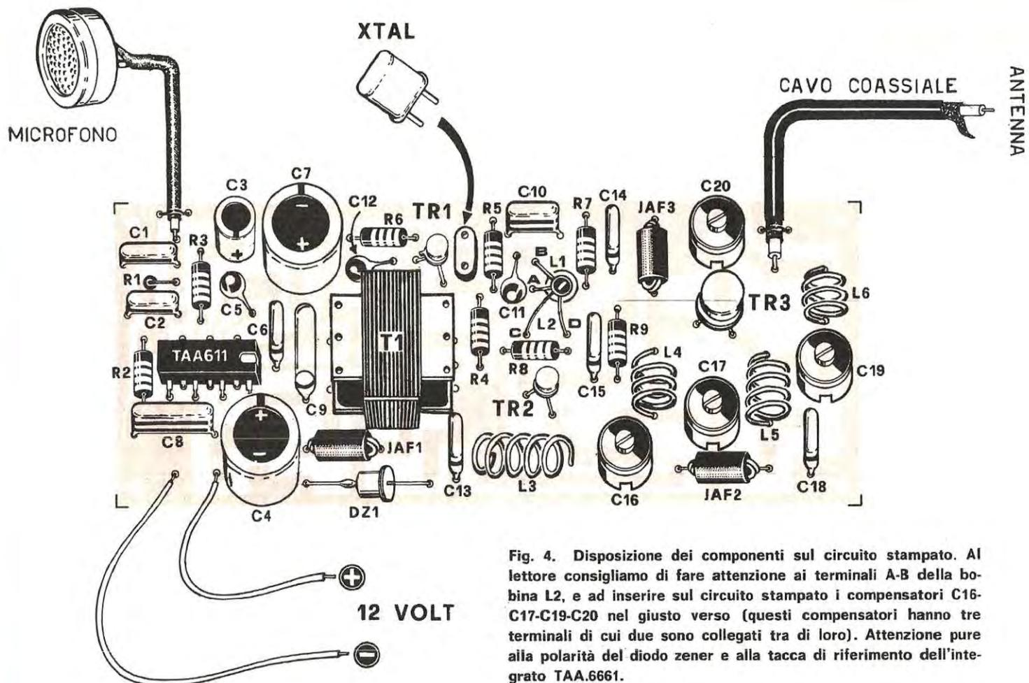
e C17, fino ad ottenere il massimo della tensione di uscita poi si passerà a C19 e C20 e con questa ultima regolazione dovreste ottenere in uscita una tensione di circa 8-9 Volt. Se la tensione risulta notevolmente inferiore a quanto da noi indicato, ad esempio la metà, significa che la taratura non è corretta quindi occorrerà procedere ad un ritocco di L1/L2 e dei vari compensatori, ripetendo le precedenti operazioni, fino ad avere la tensione indicata.
