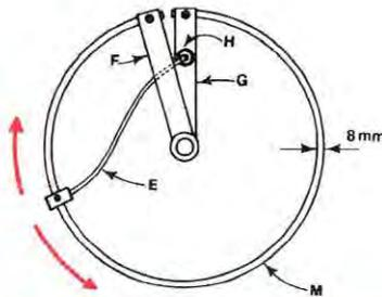
**Fig. 4. L'adattatore d'impedenza visto da sopra (cioè dal lato dello stilo verticale). Il filo E dovendo spostarsi in fase di taratura di circa 40 cm sul tubo M dovrà essere sagomato in modo che in qualsiasi posizione risulti fissato non venga mai in contatto con il tubo verticale. Una volta eliminate le onde stazionarie il filo E potrà essere fissato o saldato sul tubo M.**
