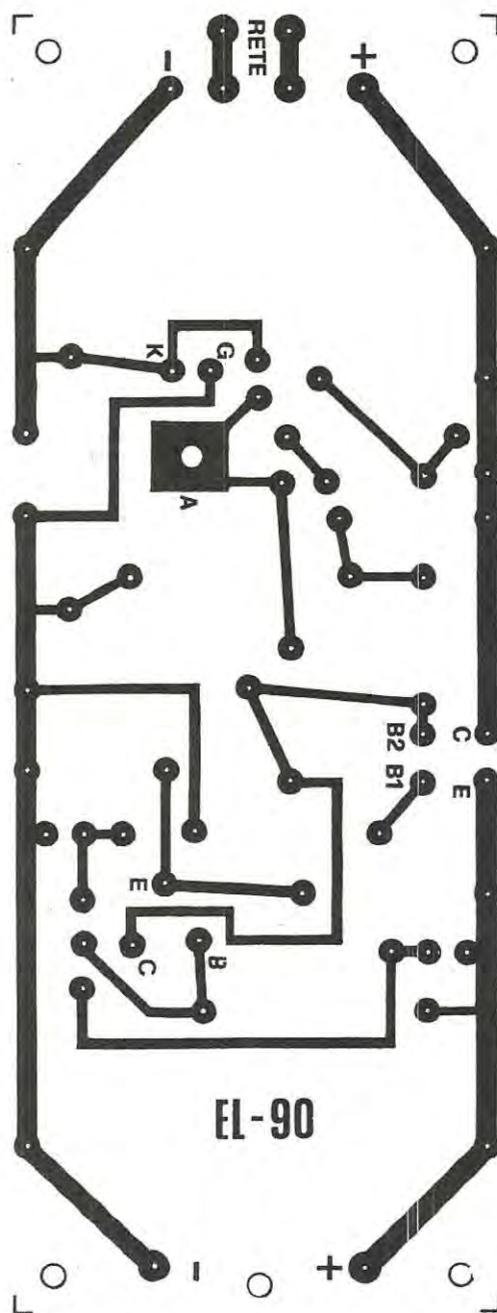
— Inoltre il condensatore elettrolitico C8 va invertito di polarità, cioè il terminale POSITIVO va rivolto verso la base del transistor TR3, e non verso la resistenza R15. Questa inversione è del resto facilmente intuibile, poichè sulla base TR3 sono presenti 7,2 volt positivi, mentre il lato di C8 rivolto verso R15 si collega a massa, e quindi deve essere necessariamente NEGATIVO.
