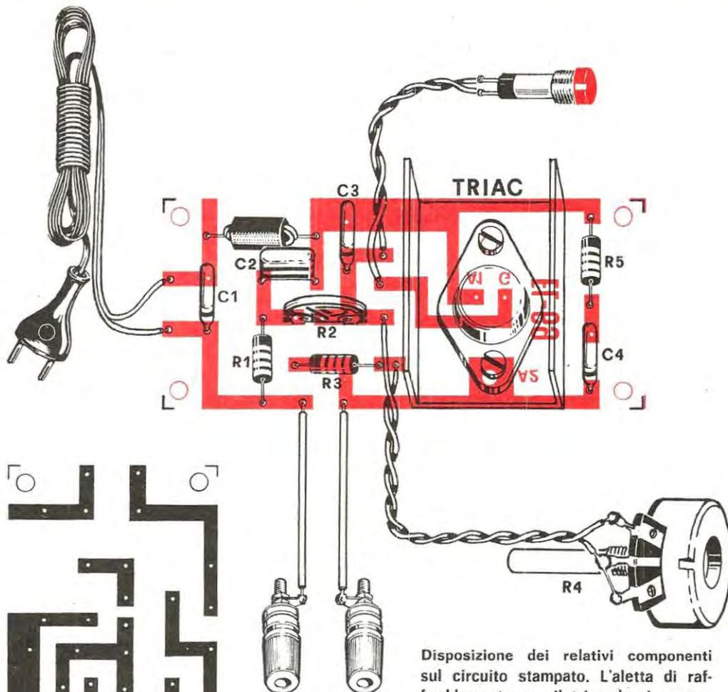
Disposizione dei relativi componenti sul circuito stampato. L'aletta di raffreddamento per il triac dovrà essere realizzata dal lettore utilizzando un sottile lamierino di alluminio, ottone o rame. Facciamo notare al lettore che se la lampadina al neon LPI risultasse da 60-70 volt lavoro la resistenza R1 dovrà risultare da 68.000 ohm.
