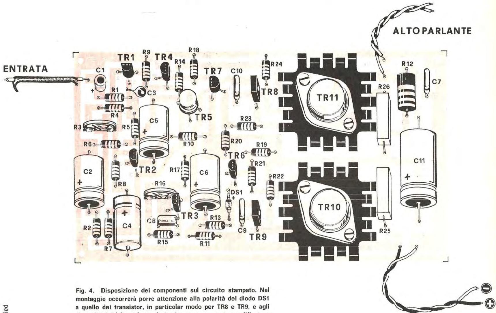
Fig. 4. Disposizione dei componenti sul circuito stampato. Nel montaggio occorrerà porre attenzione alla polarità del diodo DS1 a quello dei transistor, in particolar modo per TR8 e TR9, e agli elettrolitici. L'altoparlante da impiegare per questo amplificatore dovrà disporre di una impedenza di 4 ohm.
