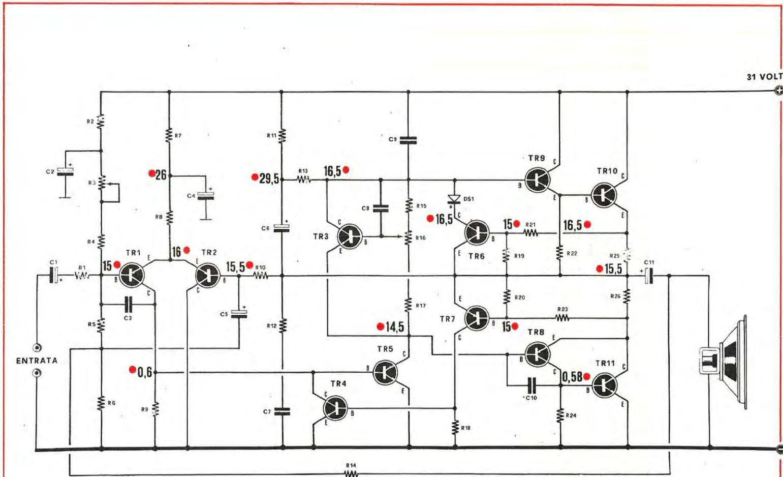
Le tensioni indicate sui vari punti del circuito con un punto rosso, sono state rilevate con un voltmetro elettronico. Con un normale tester sarà possibile controllare solo la tensione centrale (R25-R26-C11) che necessariamente dovrà risultare « metà » esatta della tensione di alimentazione.
