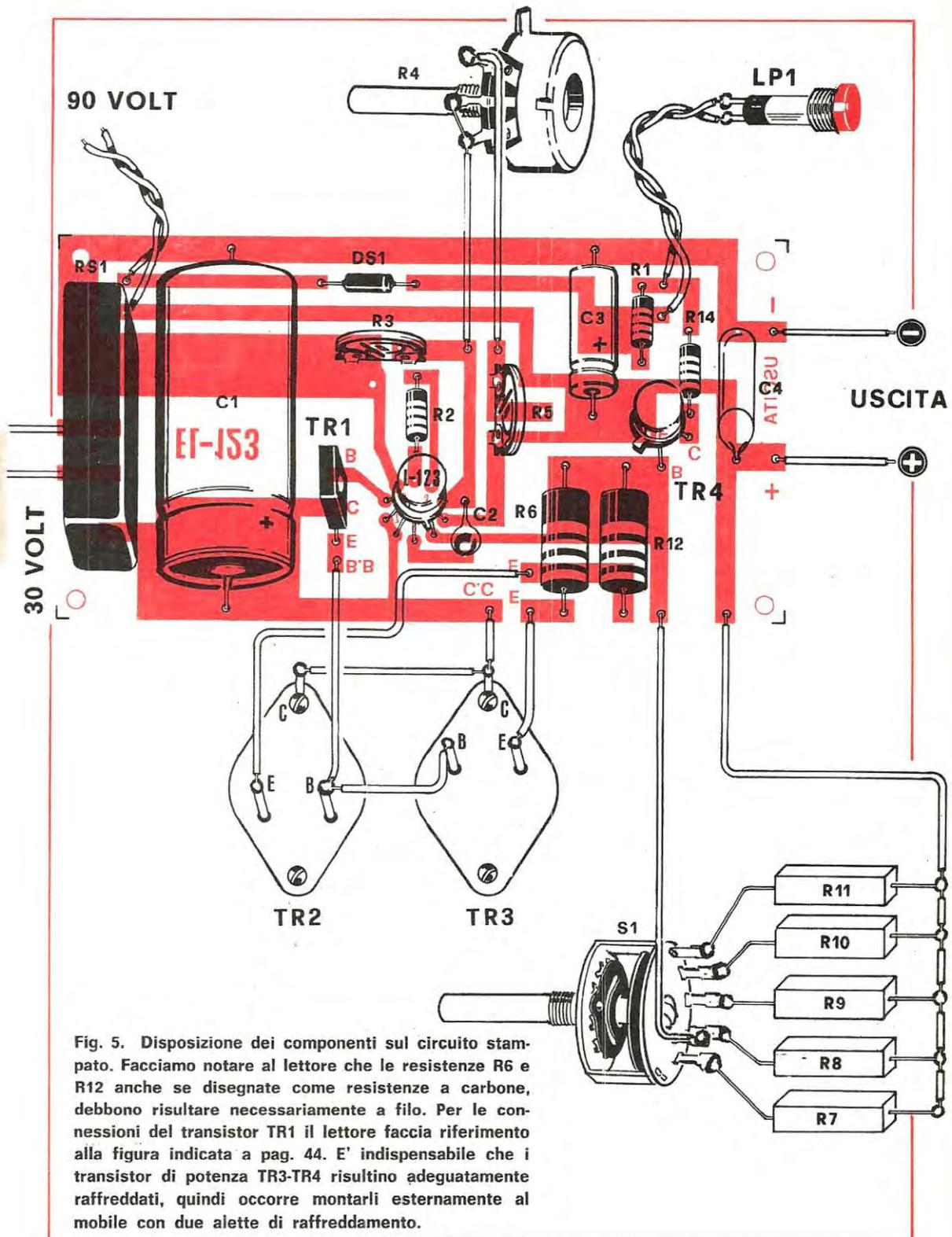
Fig. 5. Disposizione dei componenti sul circuito stampato. Facciamo notare al lettore che le resistenze R6 e R12 anche se disegnate come resistenze a carbone, debbono risultare necessariamente a filo. Per le connessioni del transistor TR1 il lettore faccia riferimento alla figura indicata a pag. 44. E' indispensabile che i transistor di potenza TR3-TR4 risultino adeguatamente raffreddati, quindi occorre montarli esternamente al mobile con due alette di raffreddamento.
