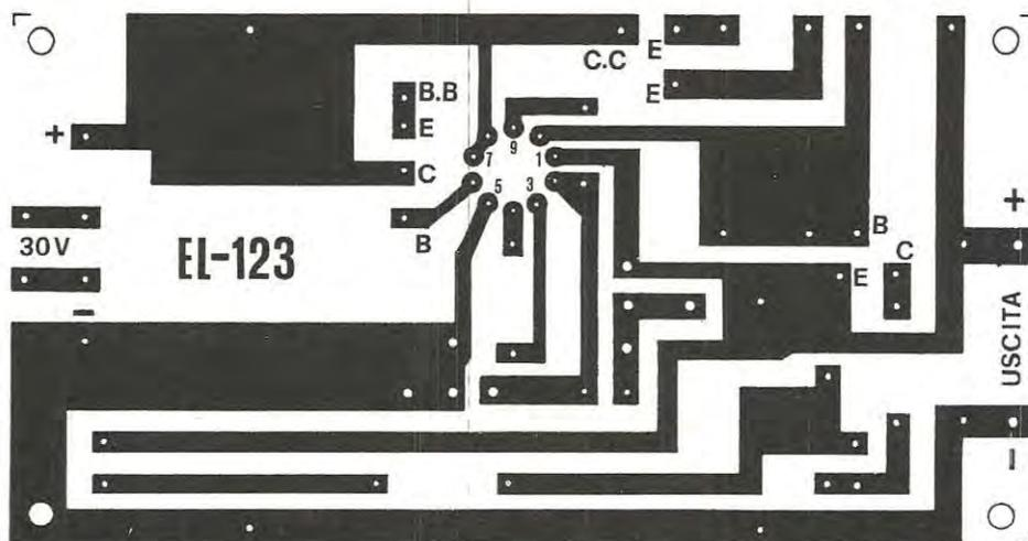
**Fig. 4. Circuito stampato a grandezza naturale dell'alimentatore. Per le connessioni dell'integrato L.123, non essendo riusciti ad includere sul circuito i 10 numeri, il lettore prenda come riferimento il terminale 1 ed il 9. Quello tra queste due piste corrisponde al terminale 10.**
