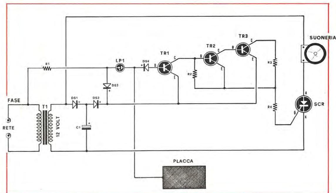
solo se le arriva tensione. Come transistor TR1 e TR3 ho utilizzato due PNP tipo AC135, mentre per TR2 un NPN tipo AC127; in questo circuito si potranno usare con profitto anche altri transistor, purchè si rispetti il tipo PNP o NPN.
