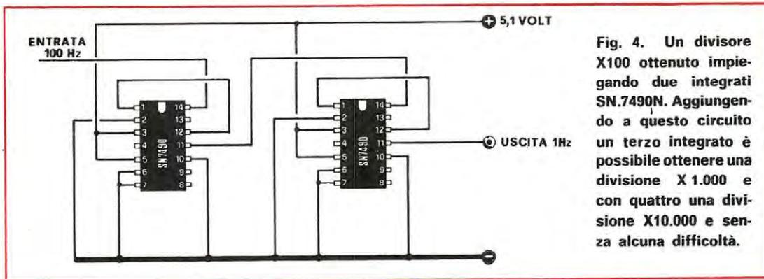
Fig. 4. Un divisore X100 ottenuto impiegando due integrati SN.7490N. Aggiungendo a questo circuito un terzo integrato è possibile ottenere una divisione X 1.000 e con quattro una divisione X10.000 e senza alcuna difficoltà.
