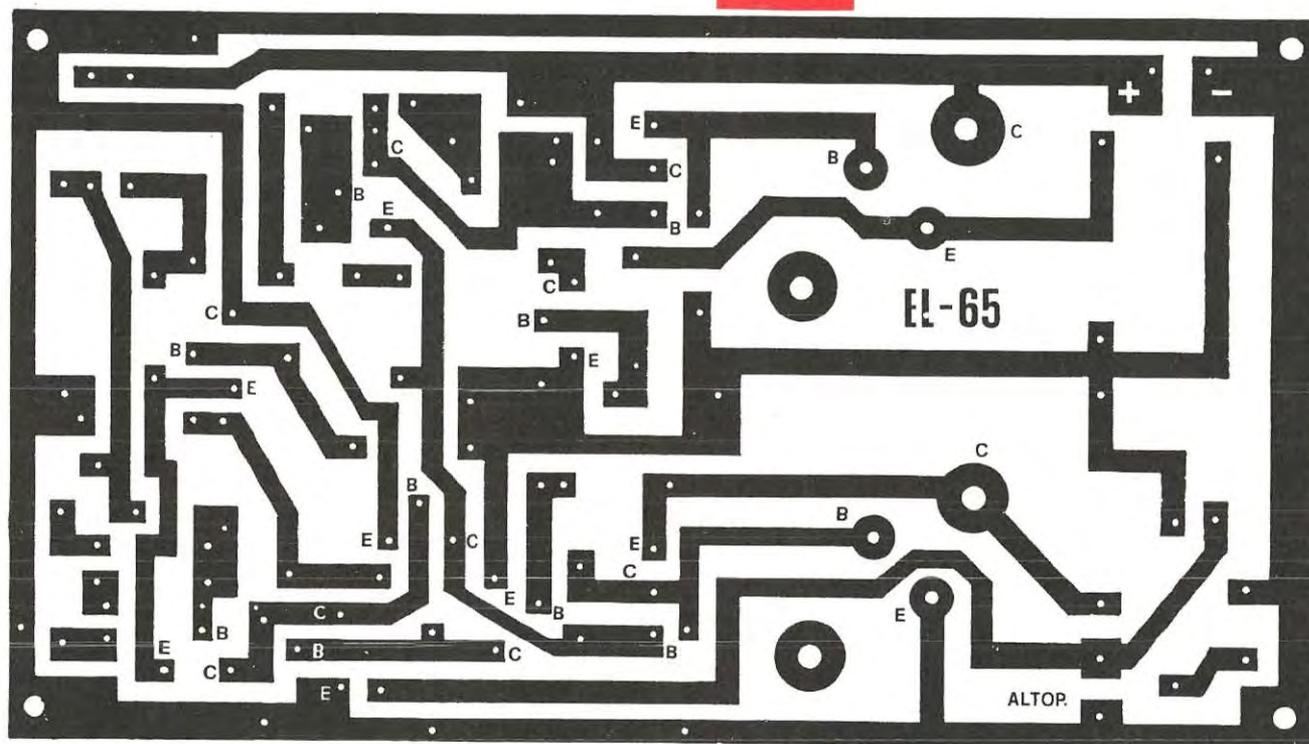
Fig. 2. Circuito stampato a grandezza naturale dell'amplificatore EL65. Il circuito che noi forniamo è in fibra di vetro, offrendo questo supporto una maggior rigidità e minor perdite, possiamo comunque assicurare al lettore che le prestazioni non subiranno nessuna variazione anche utilizzando supporti in bachelite.
