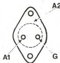
Disposizione dei terminali G-A1-A2 sull'involucro del Triac da noi consigliato per questo montaggio. Il Triac necessario a questo montaggio dovrà risultare da 400 volt lavoro 6 amper.
