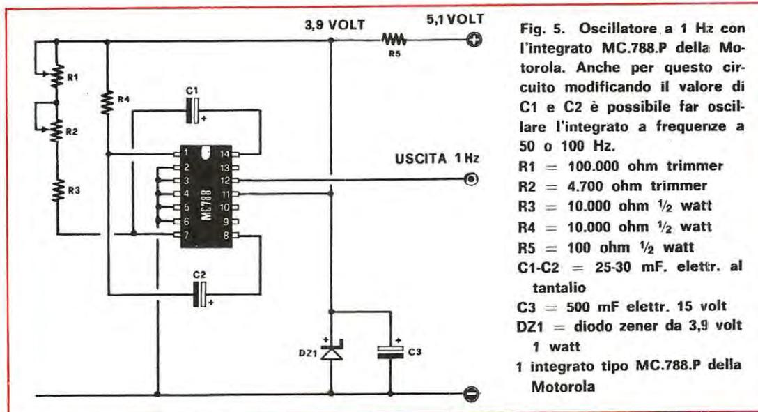
Fig. 5. Oscillatore a 1 Hz con l'integrato MC.788.P della Motorola. Anche per questo circuito modificando il valore di C1 e C2 è possibile far oscillare l'integrato a frequenze a 50 o 100 Hz.
