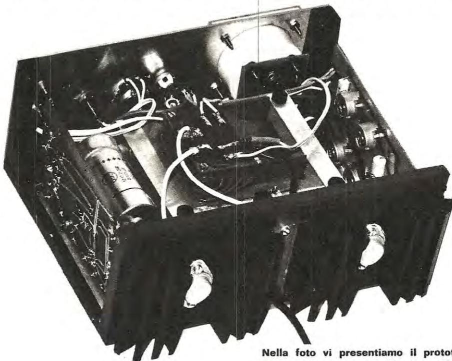
Nella foto vi presentiamo il prototipo di questo alimentatore montato e collaudato nel nostro laboratorio. Come si può notare i due transistor 2N3055 o BD130 sono stati applicati esternamente al mobile con due adeguate alette di raffreddamento.
