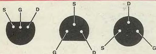
Fig. 4 Per le connessioni del fet fate attenzione alla forma dell'involucro poiché, variando quest'ultima, i terminali S-G-D risulteranno disposti in modo diverso (come vedesi nel disegno).
