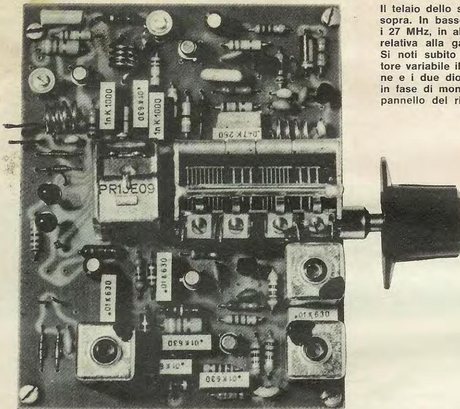
Il telaio dello stadio di AF visto da sopra. In basso la sezione AF per i 27 MHz, in alto invece la sezione relativa alla gamma dei 144 MHz. Si noti subito dietro al condensatore variabile il relè di commutazione e i due diodi led che dovremo, in fase di montaggio, applicare sul pannello del ricevitore.
