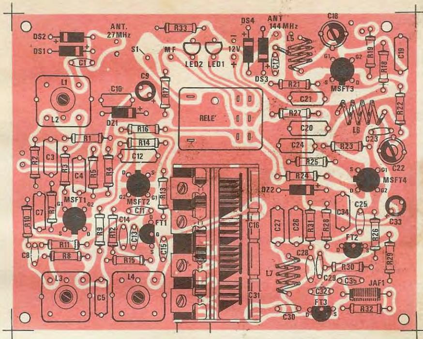
Fig. 9 Non potendo il lettore con il solo schema pratico di fig. 8 riuscire ad individuare la posizione dei vari componenti, riportiamo il disegno serigrafico dei componenti relativi al telaio di AF. Tale disegno è comunque riportato con vernice indelebile sul circuito stampato che noi forniamo, quindi potrà servire solo ed esclusivamente per coloro che si incideranno da soli il circuito.
