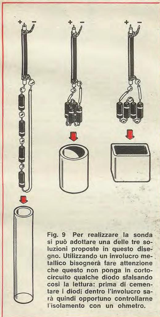
**Fig. 9** Per realizzare la sonda si può adottare una delle tre soluzioni proposte in questo disegno. Utilizzando un involucro metallico bisognerà fare attenzione che questo non ponga in cortocircuito qualche diodo sfalsando così la lettura: prima di cementare i diodi dentro l'involucro sarà quindi opportuno controllarne l'isolamento con un ohmetro.
