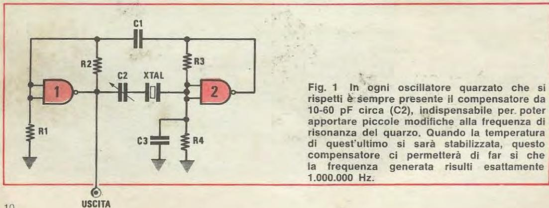
Fig. 1 In ogni oscillatore quarzato che si rispetti è sempre presente il compensatore da 10-60 pF circa (C2), indispensabile per poter apportare piccole modifiche alla frequenza di risonanza del quarzo. Quando la temperatura di quest'ultimo si sarà stabilizzata, questo compensatore ci permetterà di far sì che la frequenza generata risulti esattamente 1.000.000 Hz.
