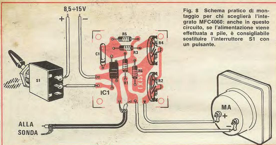
Fig. 8 Schema pratico di montaggio per chi sceglierà l'integrato MFC4060: anche in questo circuito, se l'alimentazione viene effettuata a pile, è consigliabile sostituire l'interruttore S1 con un pulsante.
