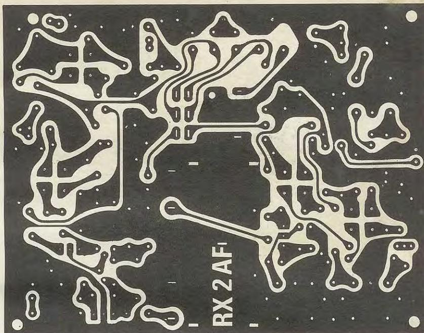
Fig. 7 In basso il circuito a grandezza naturale del telaio di MF-BF e da noi denominato RX2.MF. Su entrambi i circuiti RX2.AF e RX2.MF è riportato il disegno serigrafico dei componenti come visibile in fig. 9 e 11.
