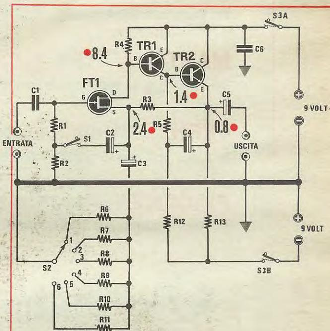
Fig. 1 Schema elettrico del preamplificatore a guadagno programmabile. Le tensioni indicate sullo schema sono state misurate con un voltmetro elettronico.
