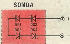
Fig. 4 La sonda del nostro termometro può essere realizzata utilizzando quattro diodi al silicio di qualsiasi tipo collegati in serie. Applicando poi tale sonda ad uno dei due circuiti di fig. 2 o 3 si dovrà rispettare la polarità dei terminali collegandoli nel senso di conduzione poiché, in caso contrario, la lancetta sbatterà violentemente contro il fondo scala.
