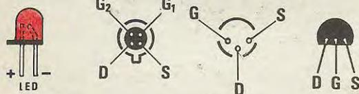
Fig. 3 Disposizione dei terminali dei diodi led dei Mosfet e dei fet: per quest'ultimi occorre controllare la forma dell'involucro, se circolare o a mezzaluna, prima di inserirli sullo stampato.
