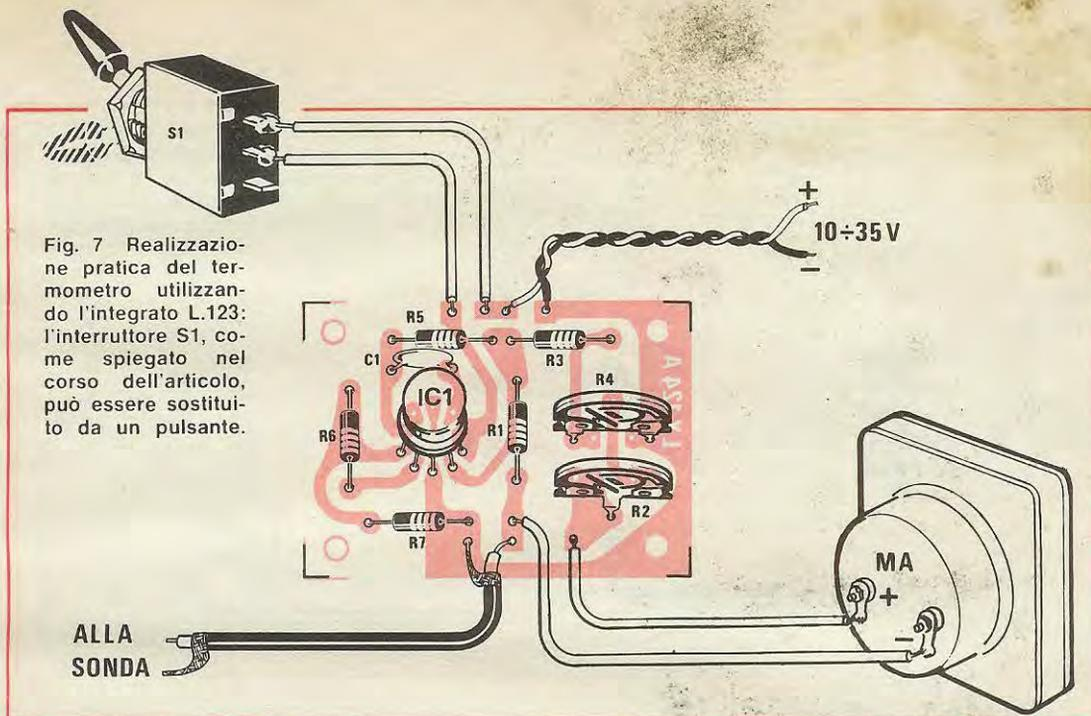
vuole ottenere un'escursione da 0 a 100 gradi, oppure da 150 microamper di fondo scala, se invece si ha bisogno di un'escursione da 0 a 150 gradi: in tal modo la scala dello strumento corrisponderà con la scala effettiva delle temperature, in quanto, in corrispondenza alla variazione di temperatura di un grado, si ha una variazione di 1 microamper sulla corrente che attraversa lo strumento.
