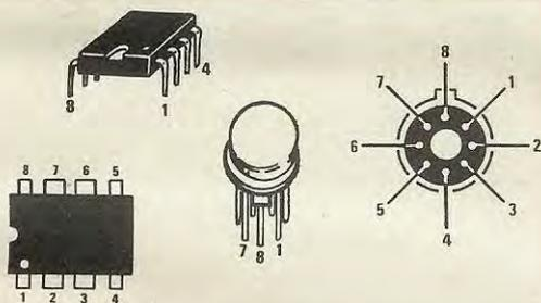
**Fig. 2** L'integrato NE.555 può essere reperito in commercio sia in versione dual-line plastico (figura di sinistra), sia in versione tutto metallo (figura di destra). Grazie alla particolare disposizione dei terminali dei due tipi è comunque possibile inserire il tipo metallico laddove è richiesto quello dual-line, semplicemente allargandone i terminali.
