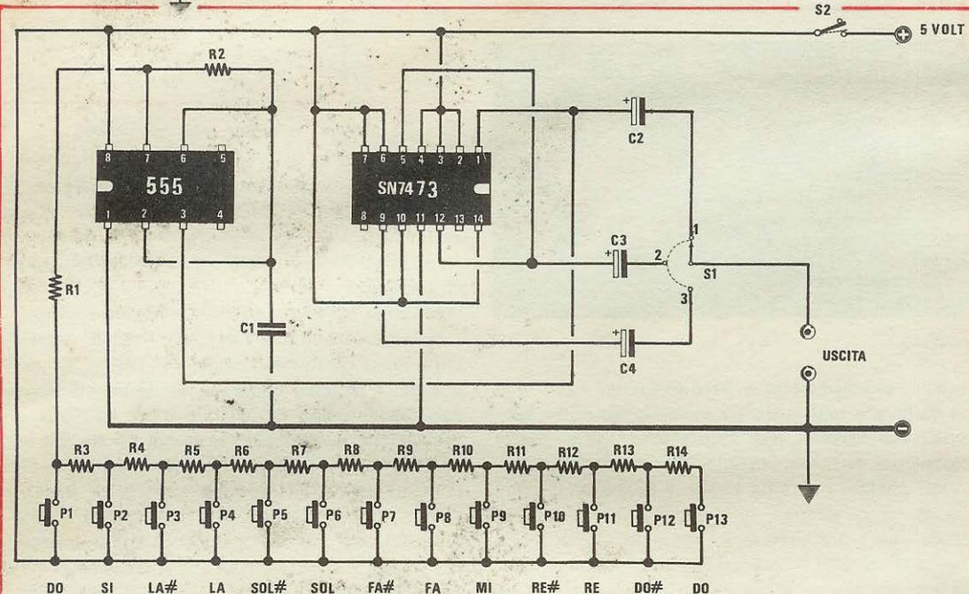
Fig. 9 Schema elettrico di un semplice organo.
