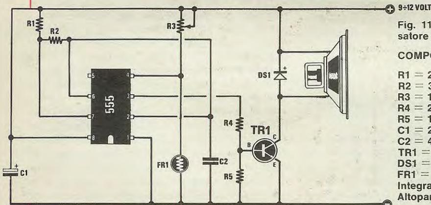
Fig. 11 Schema di un avvisatore di fiamma.
