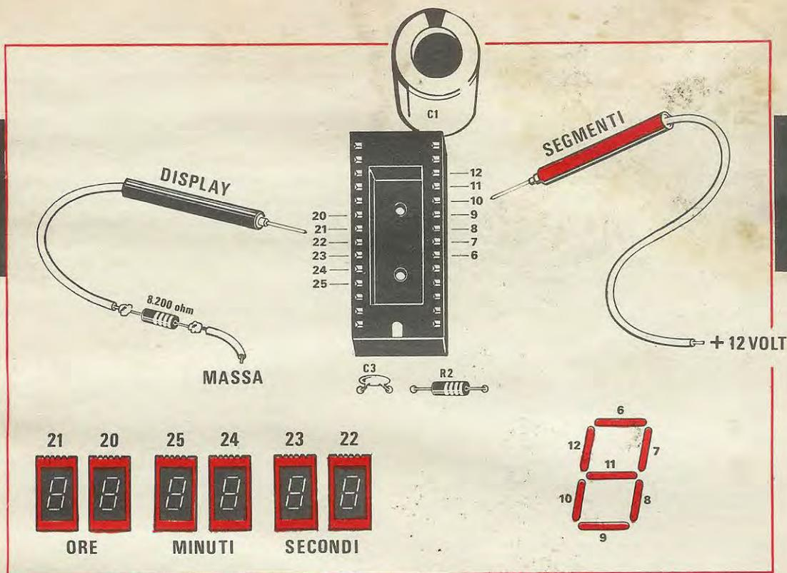
Fig. 1 Toccando, con il puntale negativo, i terminali dello zoccolo dal n. 20 al n. 25, noi alimenteremo i vari display secondo l'ordine riportato in basso a sinistra. Fornendo poi, in corrispondenza ad ogni display della serie, tensione positiva ai terminali dal n. 6 al n. 12, vedremo accendersi i diversi segmenti del display selezionato secondo l'ordine indicato dalla figura in basso a destra.
