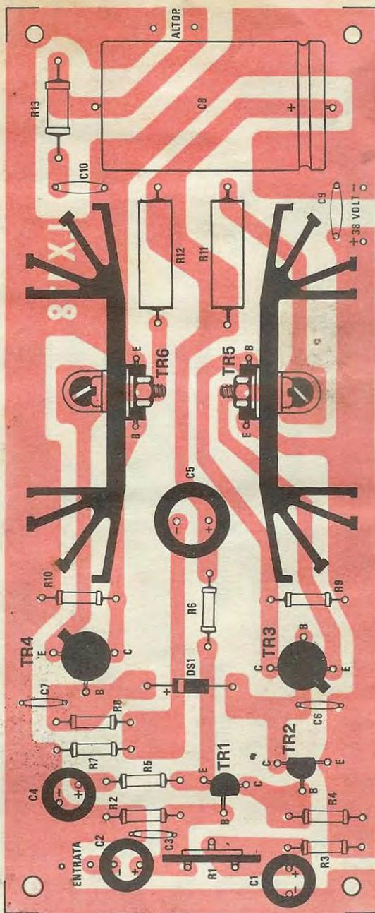
Fig. 3 Tutti i circuiti stampati da noi forniti sono in fibra di vetro ed hanno riportato, dal lato componenti, un disegno serigrafico identico a quello che compare in questa figura, onde semplificare le operazioni di montaggio.
