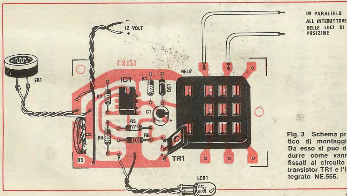
Fig. 3 Schema pratico di montaggio. Da esso si può dedurre come vanno fissati al circuito il transistor TR1 e l'integrato NE.555.
