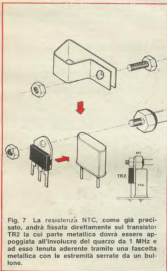
Fig. 7 La resistenza NTC, come già precisato, andrà fissata direttamente sul transistor TR2 la cui parte metallica dovrà essere appoggiata all'involucro del quarzo da 1 MHz e ad esso tenuta aderente tramite una fascetta metallica con le estremità serrate da un bullone.
