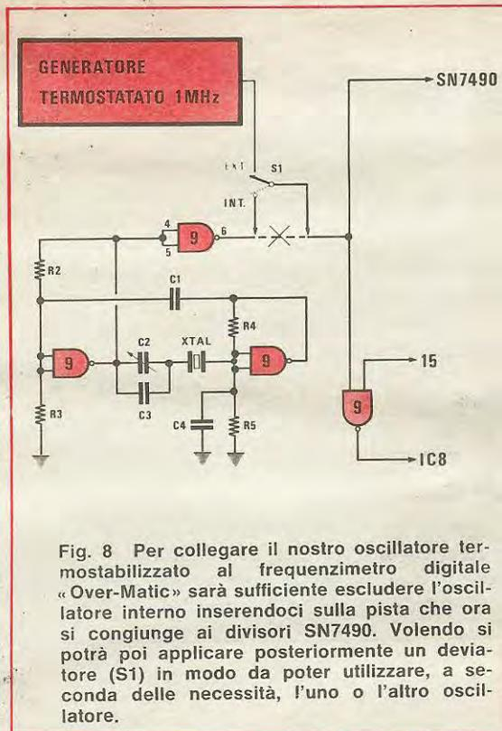
Fig. 8 Per collegare il nostro oscillatore termostabilizzato al frequenzimetro digitale «Over-Matic» sarà sufficiente escludere l'oscillatore interno inserendoci sulla pista che ora si congiunge ai divisori SN7490. Volendo si potrà poi applicare posteriormente un deviatore (S1) in modo da poter utilizzare, a seconda delle necessità, l'uno o l'altro oscillatore.
