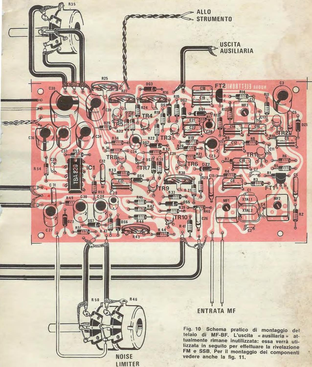
Fig. 10 Schema pratico di montaggio del telaio di MF-BF. L'uscita «ausiliaria» attualmente rimane inutilizzata: essa verrà utilizzata in seguito per effettuare la rivelazione FM e SSB. Per il montaggio dei componenti vedere anche la fig. 11.
