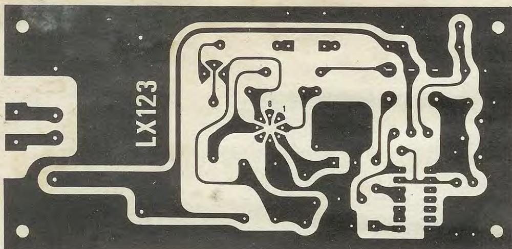
**Fig. 3** Disegno a grandezza naturale del circuito stampato, da noi denominato LX123, indispensabile per realizzare questo oscillatore termostabilizzato.
