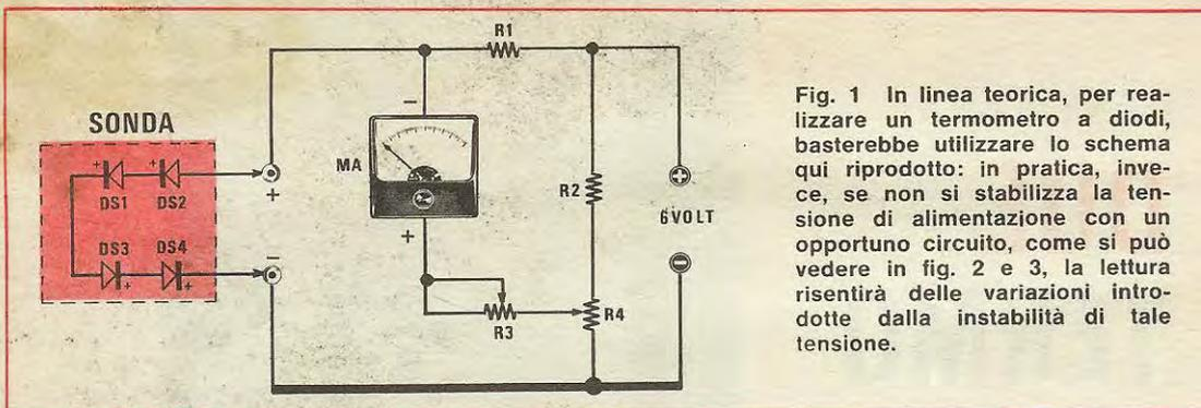
Fig. 1 In linea teorica, per realizzare un termometro a diodi, basterebbe utilizzare lo schema qui riprodotto: in pratica, invece, se non si stabilizza la tensione di alimentazione con un opportuno circuito, come si può vedere in fig. 2 e 3, la lettura risentirà delle variazioni introdotte dalla instabilità di tale tensione.
