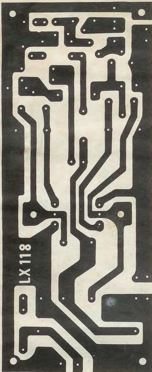
Fig. 2 Disegno a grandezza naturale del circuito stampato (denominato LX118) utile per la realizzazione del nostro amplificatore. Chiunque volesse autocostruirselo sarà bene che scelga come supporto la fibra di vetro anziché la bachelite.
