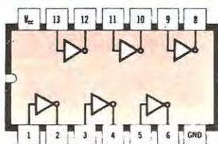
Fig. 1 L'integrato SN7404 racchiude nel suo involucro sei INVERTER come vedesi nella figura qui a lato. Facendo riferimento alla tacca presente sulla sinistra (l'integrato è visto da sopra) il primo terminale in alto (indicato Vcc) serve per i 5 volt positivi di alimentazione mentre il settimo a destra in basso (indicato GND) per il negativo di alimentazione.
