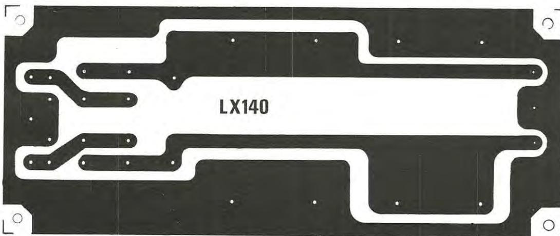
**Fig. 7** Circuito stampato non a grandezza naturale (le dimensioni reali sono 19,5 x 8 cm) utile a ricevere i componenti della sezione alimentatrice. Su tale circuito possono venire montati indifferentemente uno o due ponti raddrizzatori B80.C5000 in modo da poter alimentare un solo amplificatore oppure un gruppo stereo.
