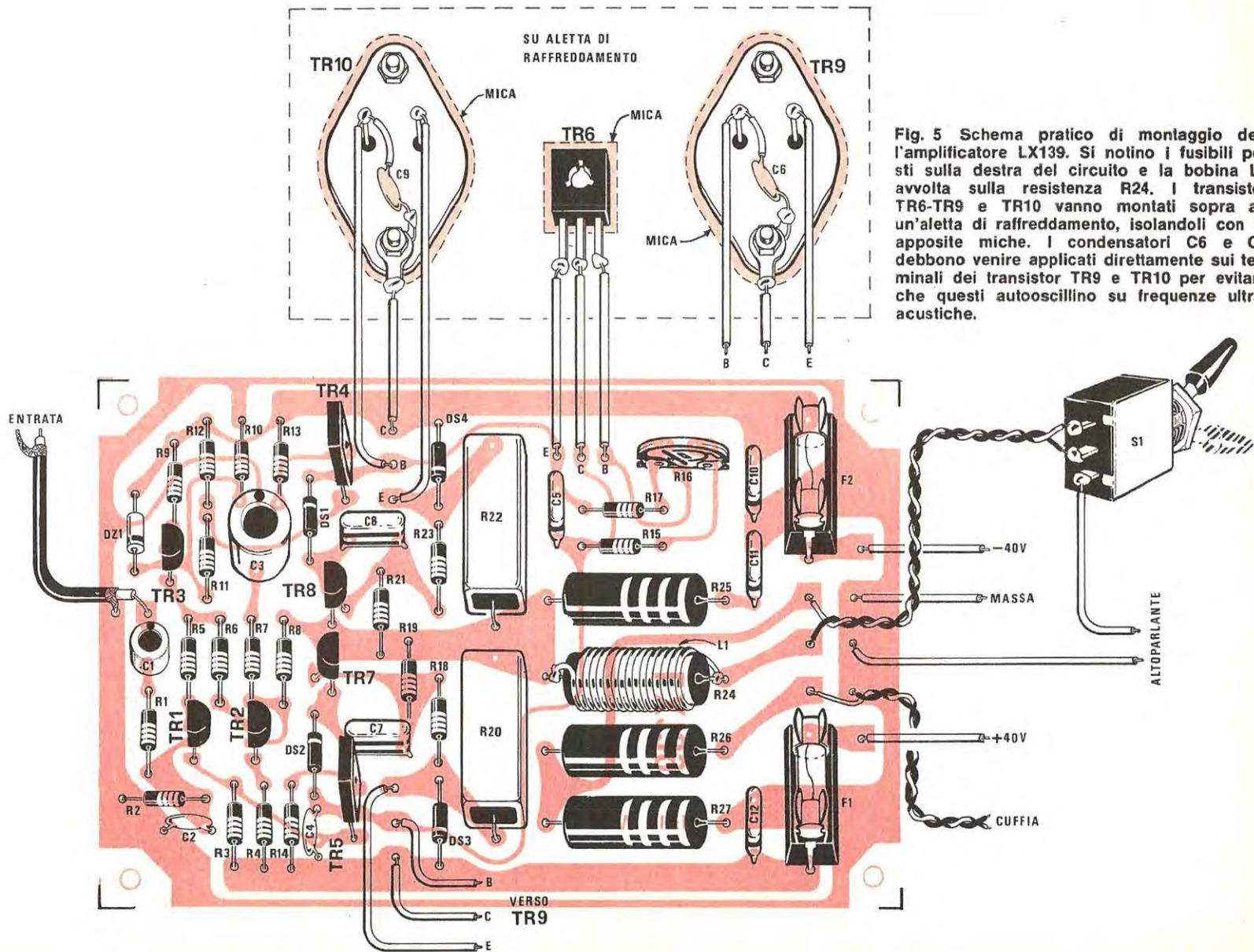
Fig. 5 Schema pratico di montaggio dell'amplificatore LX139. Si notino i fusibili posti sulla destra del circuito e la bobina L1 avvolta sulla resistenza R24. I transistor TR6-TR9 e TR10 vanno montati sopra ad un'aletta di raffreddamento, isolandoli con le apposite miche. I condensatori C6 e C9 debbono venire applicati direttamente sui terminali dei transistor TR9 e TR10 per evitare che questi autooscillino su frequenze ultracustiche.
