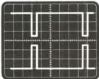
**Fig. 3** Forma d'onda presente in uscita sul piedino 1 (traccia superiore) e sul piedino 6 (traccia inferiore) quando all'ingresso dell'integrato arrivano gli impulsi provenienti dalle puntine di un motore a 4 cilindri funzionante a 1.200 giri/min.
