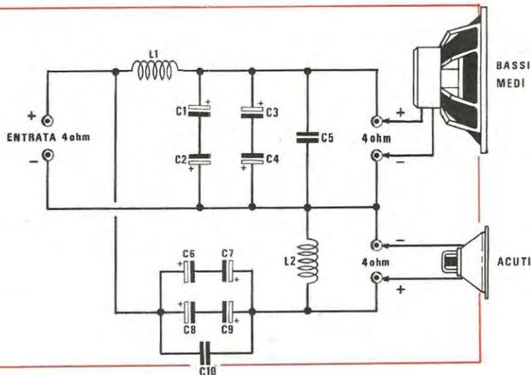
Fig. 4 Filtro cross-over a 3 vie da impiegare con altoparlanti aventi un'impedenza caratteristica di 4 ohm (per lo schema pratico di montaggio vedi fig. 9).
