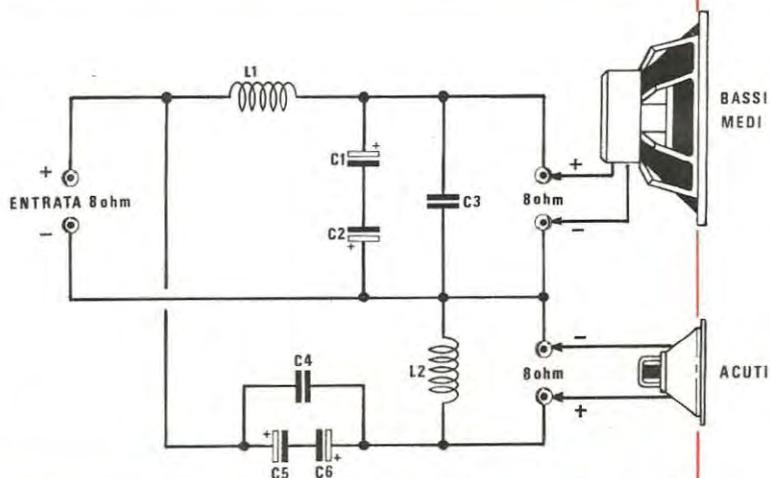
Fig. 3 Filtro cross-over a 2 vie adatto per altoparlanti con impedenza caratteristica di 4 ohm (per lo schema pratico di montaggio vedi fig. 7).
