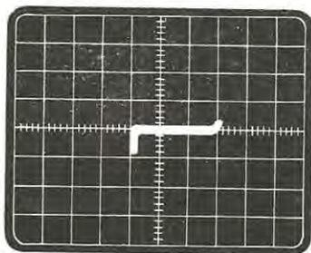
Fig. 24 Spostando il commutatore S2 sulla posizione «Tensione di Rottura» potremo controllare la tensione massima inversa sopportata da un semiconduttore. Con il deviatore S3 in posizione «5 volt x cm», esaminando un diodo zener da 15 volt, la traccia orizzontale copre 3 quadretti ( $3 \times 5 = 15$  volt).
