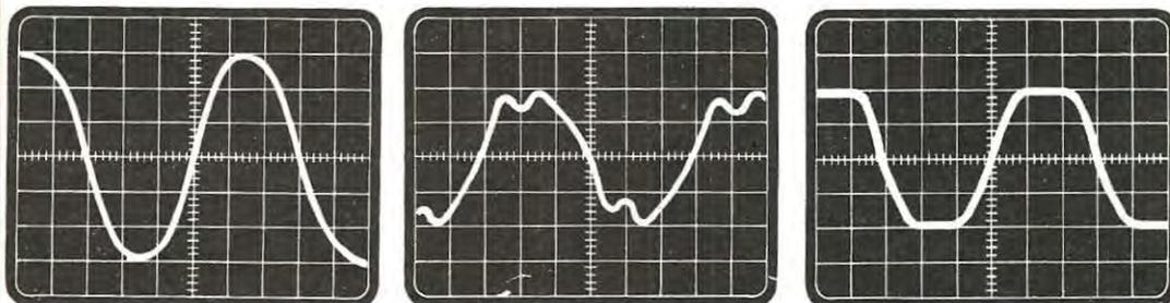
Fig. 1 Nel primo fotogramma è visibile la distorsione introdotta da un filtro commerciale nelle vicinanze del punto d'incrocio, causata dall'isteresi del nucleo magnetico su cui è avvolta la bobina. Nel secondo fotogramma il taglio inferiore e superiore è invece dovuto alla saturazione dell'induttanza. Nel terzo fotogramma infine, la forma d'onda in uscita dal nostro filtro la quale, come potrete notare, non presenta nessun difetto.
