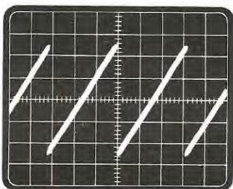
Fig. 4 Dente di sega alla frequenza di circa 600 Hz presente sull'anodo dell'unigiunzione UJP1 (punto n. 2 dello schema elettrico di fig. 1). L'ampiezza totale di tale rampa si aggira sui 24 volt.
