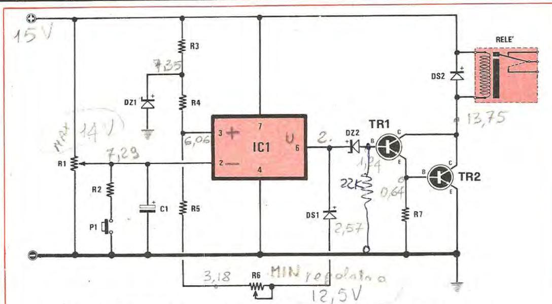
Fig. 1 Schema elettrico del controllo automatico per carica-batterie.
