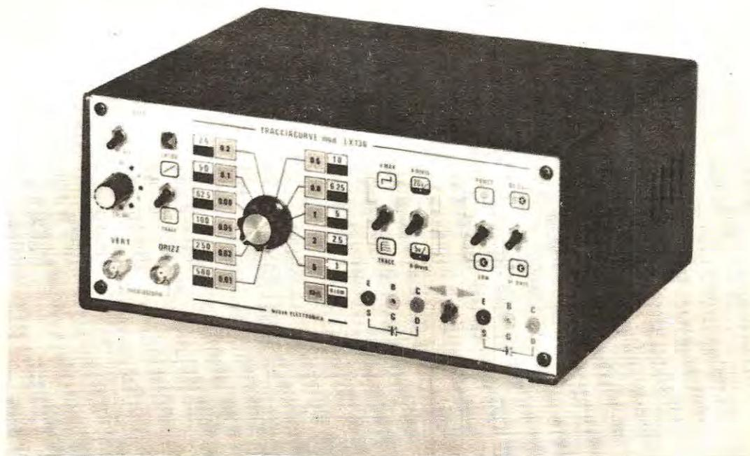
Questo progetto è completo di contenitore metallico e del relativo pannello frontale di alluminio anodizzato. Il disegno riportato su questo pannello non è ottenuto per via serigrafica, bensì chimicamente, per incisione a due colori, quindi risulta praticamente incancellabile anche sfregandolo in continuazione con le dita.
