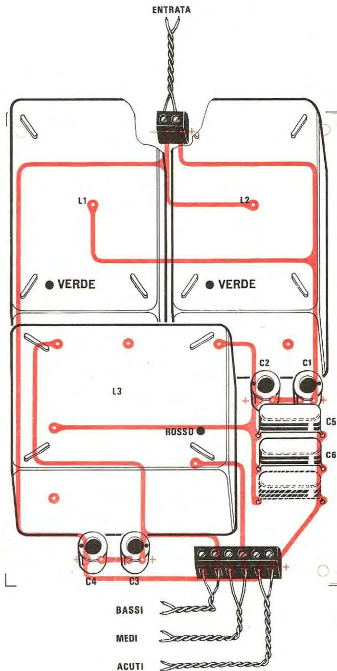
l'uso di condensatori elettrolitici quindi anche se la capacità complessiva richiesta è piuttosto elevata essendo necessari circa 7,9 mF, essa dovrà essere ottenuta collegando in parallelo diversi condensatori in poliestere (C5-C6-C7).
