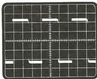
**Fig. 6** Forma d'onda presente sul collettore del transistor TR6. Le Indicazioni « Sweep-Time » e « Amplif. Verticale » presenti sotto ogni didascalia sono le posizioni sulle quali occorre portare questi due comandi dell'oscilloscopio per rilevare queste forme d'onda. Sweep-Time = 0,5 millisecc. x cm. Amplificazione Verticale = 1 volt x cm.
