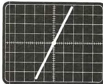
**Fig. 15** Se anziché collocare la traccia a  $45^\circ$ , come indicato nella figura precedente, la si farà salire di due quadretti in verticale per ogni quadretto orizzontale, si tarerà l'apparecchio per una lettura di 2 volt x cm in orizzontale anziché 1 volt x cm come nel caso precedente. Questo potrà servire per far rientrare la curva caratteristica all'interno dello schermo nel caso essa tendesse a fuoriuscire dai bordi laterali, in modo da poterla esaminare con più chiarezza.
