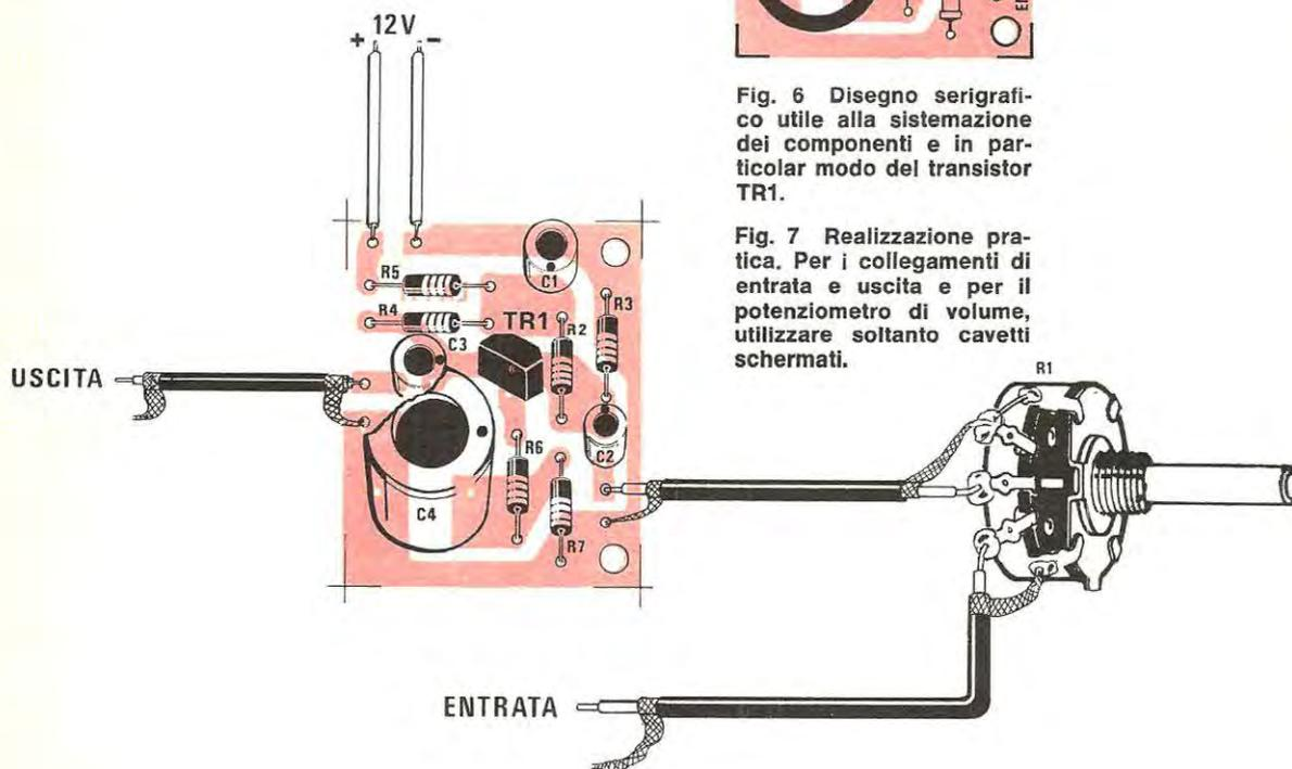
Terminato il montaggio, il preamplificatore dovrà essere racchiuso entro una scatola metallica collegando elettricamente la massa del circuito (lato negativo di alimentazione) al metallo della scatola stessa in quanto altrimenti può verificarsi l'inconveniente di ottenere un segnale d'uscita con sovrapposto un leggero ronzio di alternata.
