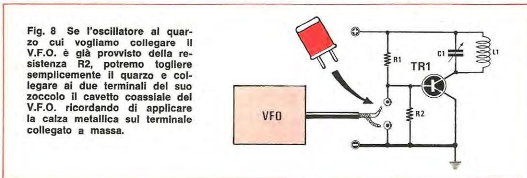
**Fig. 8** Se l'oscillatore al quarzo cui vogliamo collegare il V.F.O. è già provvisto della resistenza R2, potremo togliere semplicemente il quarzo e collegare ai due terminali del suo zoccolo il cavetto coassiale del V.F.O. ricordando di applicare la calza metallica sul terminale collegato a massa.
