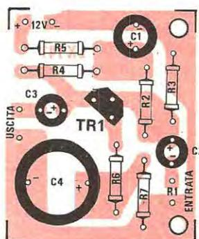
Fig. 6 Disegno serigrafico utile alla sistemazione dei componenti e in particolar modo del transistor TR1.
