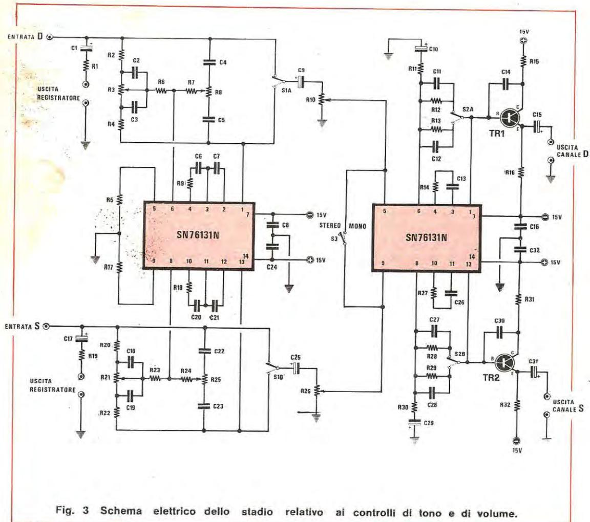
Fig. 3 Schema elettrico dello stadio relativo ai controlli di tono e di volume.
