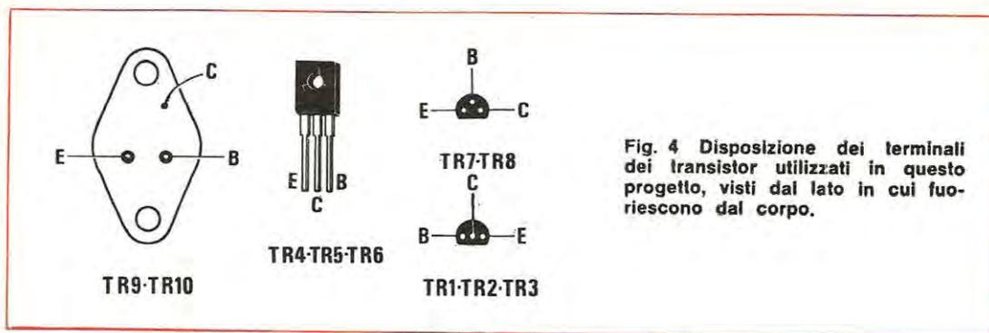
Fig. 4 Disposizione dei terminali dei transistor utilizzati in questo progetto, visti dal lato in cui fuoriescono dal corpo.
