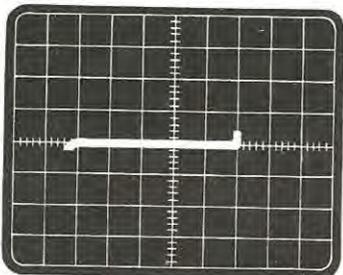
Fig. 25 Col commutatore S2 sempre in posizione «Tensione di Rottura» e con S3 sempre sulla posizione «5 volt x cm», esaminando un diodo al silicio di tipo BA100, si ottiene una traccia orizzontale lunga 5 cm., il che significa che tale diodo sopporterà una tensione massima inversa di 25 volt ( $5 \times 5 = 25$  volt).
