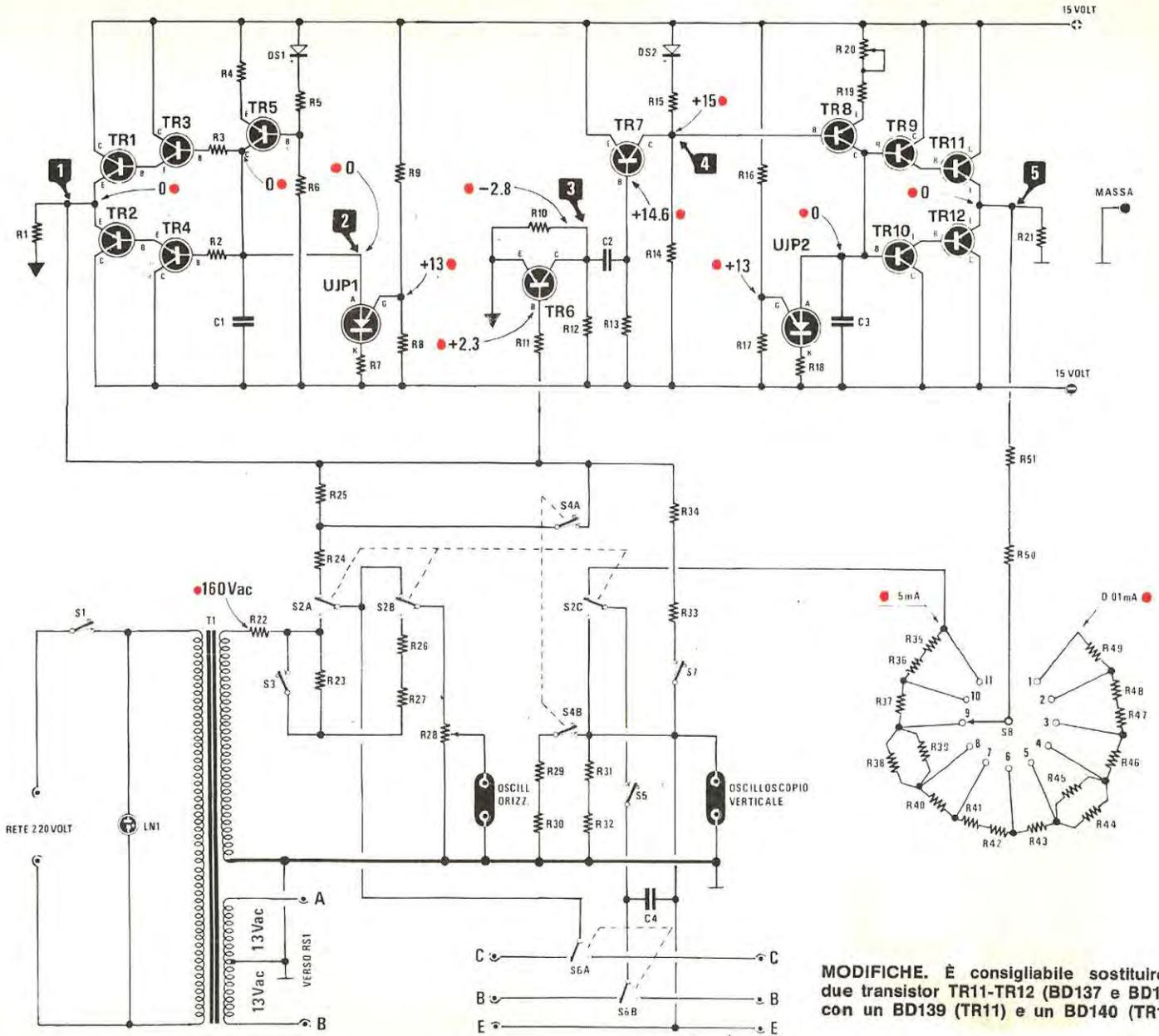
**MODIFICHE.** È consigliabile sostituire i due transistor TR11-TR12 (BD137 e BD138) con un BD139 (TR11) e un BD140 (TR12).
