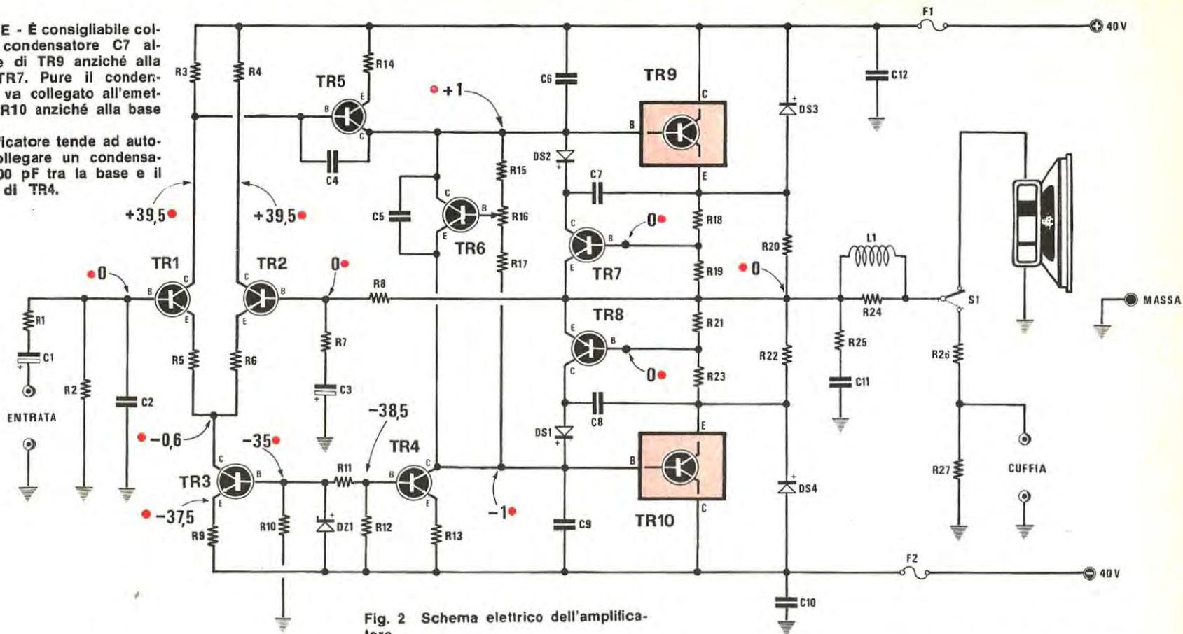
Fig. 2 Schema elettrico dell'amplificatore
