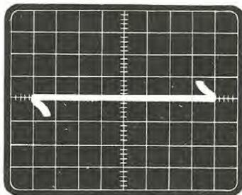
Fig. 26 Un diodo DIAC, a differenza degli altri diodi finora analizzati, presenta una curva di questo genere. Risultando la curva lunga 8 quadretti ( $5 \times 8 = 40$  volt) dedurremo che tale diodo innescherà solo con tensioni alternate di ampiezza superiore ai 20 volt picco-picco.
