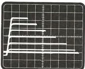
**Fig. 19** Ogni traccia presente sullo schermo corrisponde ad una diversa corrente di base e differisce da quella che la precede e da quella che la segue di tanti milliamper quanti ne indica il commutatore S8 (vedi tabella 1).
