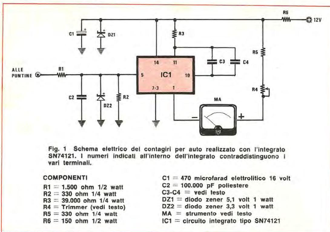
milliamperometro, la lancetta dello strumento, per l'inerzia del suo equipaggio mobile, non riuscirà a seguire tali impulsi uno per uno ma ci fornirà invece una misura media cioè si fermerà sul valore corrispondente al valore efficace della sequenza degli impulsi.
