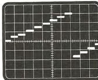
**Fig. 8** Per controllare il numero degli scalini sulla rampa di fig. 3 è consigliabile spostare lo Sweep-Time sulla posizione 2 millisecc. x cm. e contare quanti trattini vi sono al di sopra dei due trattini più ravvicinati (in rosso). Sweep-Time = 2 millisecc. x cm. Amplificazione Verticale = 5 volt x cm.
