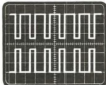
**Fig. 4** Forma d'onda presente in uscita sul piedino 1 (traccia superiore) e sul piedino 6 (traccia inferiore) quando lo stesso motore funziona a 6.000 giri/min. Si noti come gli impulsi siano proporzionalmente più fitti rispetto al caso precedente.
