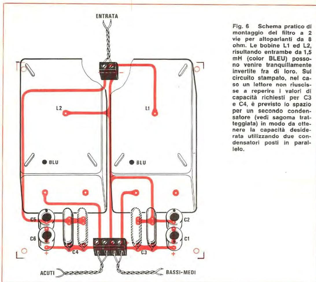
Fig. 6 Schema pratico di montaggio del filtro a 2 vie per altoparlanti da 8 ohm. Le bobine L1 ed L2, risultando entrambe da 1,5 mH (color BLEU) possono venire tranquillamente invertite fra di loro. Sul circuito stampato, nel caso un lettore non riuscisse a reperire i valori di capacità richiesti per C3 e C4, è previsto lo spazio per un secondo condensatore (vedi sagoma tratteggiata) in modo da ottenere la capacità desiderata utilizzando due condensatori posti in parallelo.
