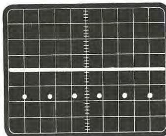
**Fig. 7** Sul collettore di TR7, cioè nel punto da noi indicato con il n. 4 sullo schema elettrico di fig. 1, troveremo invece questa forma d'onda, cioè una tensione continua con 6 impulsi di polarità negativa. Sweep-Time = 0,1 millisecc. x cm. Amplificazione Verticale = 1 volt x cm.
