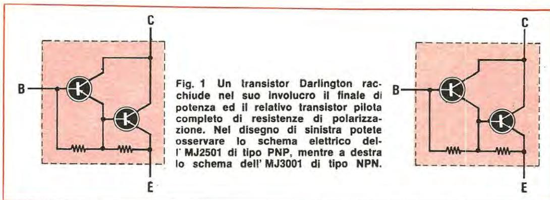
Fig. 1 Un transistor Darlington racchiude nel suo involucro il finale di potenza ed il relativo transistor pilota completo di resistenze di polarizzazione. Nel disegno di sinistra potete osservare lo schema elettrico dell' MJ2501 di tipo PNP, mentre a destra lo schema dell' MJ3001 di tipo NPN.
