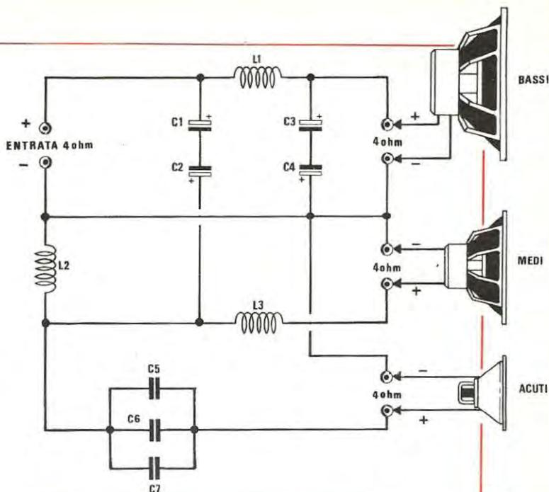
Fig. 5 Filtro cross-over a 3 vie da impiegare con altoparlanti che abbiamo un'impedenza caratteristica di 8 ohm (per lo schema pratico di montaggio vedi fig. 10).
