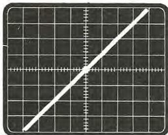
**Fig. 14** Ponendo il tracciacurve in posizione « Calibrazione » sullo schermo apparirà una traccia diagonale suddivisa a metà da un punto luminoso. Posizionato questo punto al centro dello schermo, dovremo ruotare la manopola di calibrazione fino ad inclinare la traccia esattamente di  $45^\circ$  (la traccia deve passare sui vertici di ogni quadretto che attraversa). In tal modo avremo tarato l'apparecchio per misurare 1 volt x cm. in orizzontale e 5 mA x cm. in verticale (in LOW POWER).
