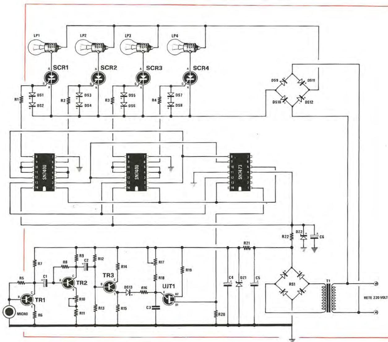
pletamente cambiata: come potrete infatti constatare il ponte costituito dai diodi DS9, DS10, DS11 e DS12 anziché raddrizzare la tensione del secondario del trasformatore raddrizza direttamente i 220 volt di rete; è inoltre stato tolto il condensatore C1 rinunciando volutamente ad ottenere una tensione ben stabilizzata: solo in questo modo infatti si riusciranno a disinnescare i vari SCR allorché scomparirà l'impulso positivo sui loro gates.
