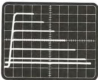
**Fig. 20** Ruotando il commutatore S8 in modo da ottenere che le tracce centrali risultino distanziate fra di loro di 1 cm come vedesi in figura, potremo direttamente leggere, sulla manopola di detto commutatore, il beta del transistor in prova.
