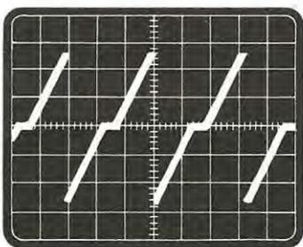
Fig. 5 Sugli emettitori dei transistor TR1 e TR2 (punto n. 1 di fig. 1) potremo rilevare questa forma d'onda, simile a quella precedente ma con una discontinuità centrale.
