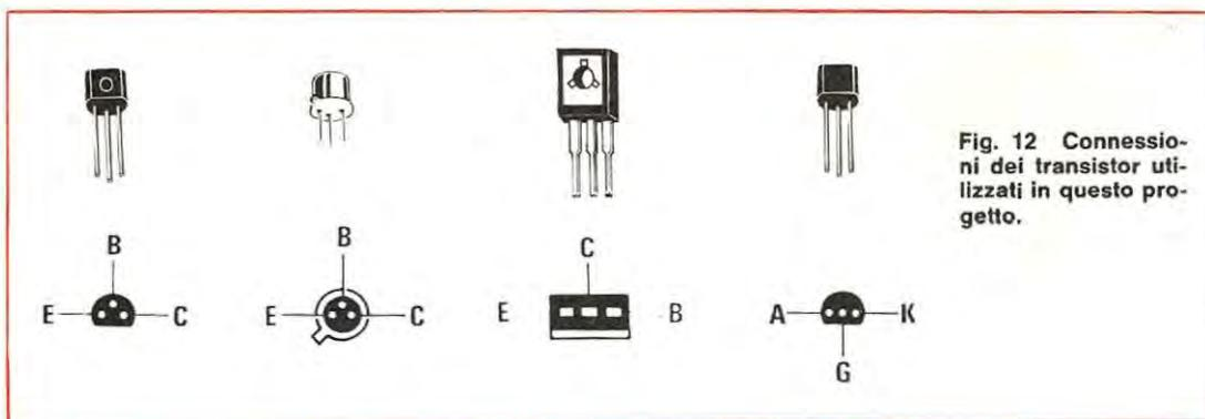
Fig. 12 Connessioni dei transistor utilizzati in questo progetto.
