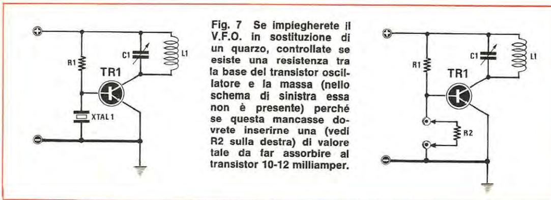
**Fig. 7** Se impiegherete il V.F.O. in sostituzione di un quarzo, controllate se esiste una resistenza tra la base del transistor oscillatore e la massa (nello schema di sinistra essa non è presente) perché se questa mancasse dovrete inserirne una (vedi R2 sulla destra) di valore tale da far assorbire al transistor 10-12 milliampere.
