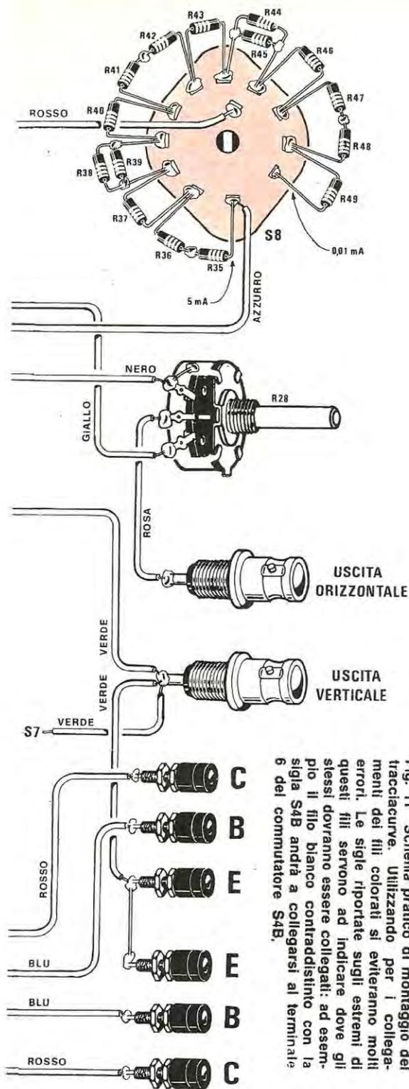
Fig. 11 Schema pratico di montaggio del tracciacurve. Utilizzando per i collegamenti dei fili colorati si eviteranno molti errori. Le sigle riportate sugli estremi di questi fili servono ad indicare dove gli stessi dovranno essere collegati: ad esempio il filo bianco contraddistinto con la sigla S4B andrà a collegarsi al terminale 6 del commutatore S4B.
