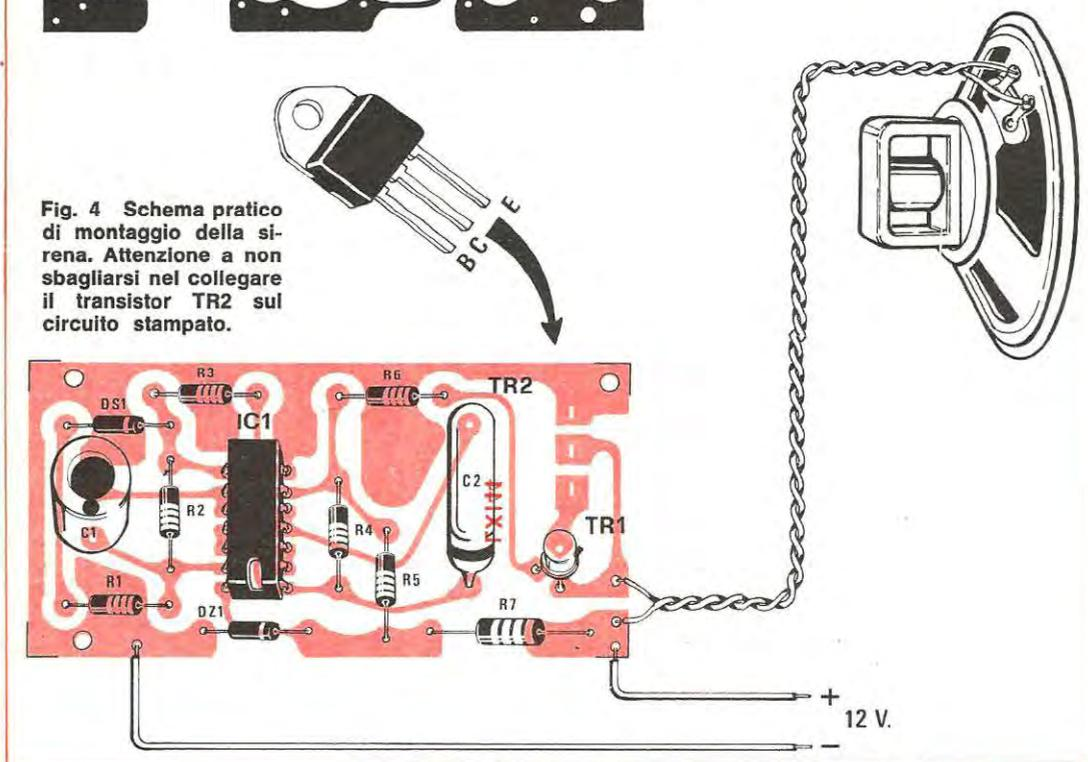
Per quanto riguarda l'alimentazione, si ricorda che il circuito funziona correttamente con tensioni comprese fra i 9 e i 14 volt, anche se ovviamente ad una maggiore tensione di alimentazione corrisponde una maggiore potenza d'uscita e più precisamente, con un altoparlante avente un'impedenza caratteristica di 4 ohm, si ottiene una potenza media di circa 3 watt con 9 volt e di oltre 10 watt con 14 volt.
