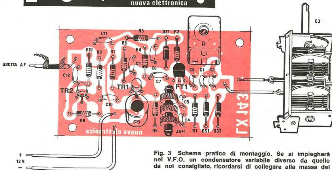
Fig. 3 Schema pratico di montaggio. Se si impiegherà nel V.F.O. un condensatore variabile diverso da quello da noi consigliato, ricordarsi di collegare alla massa del circuito stampato la carcassa metallica o il terminale di massa di tale condensatore.
