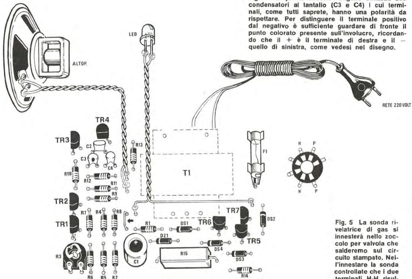
Fig. 3 In questo circuito vengono utilizzati due condensatori al tantalio (C3 e C4) i cui terminali, come tutti saprete, hanno una polarità da rispettare. Per distinguere il terminale positivo dal negativo è sufficiente guardare di fronte il punto colorato presente sull'involucro, ricordando che il + è il terminale di destra e il - quello di sinistra, come vedesi nel disegno.
