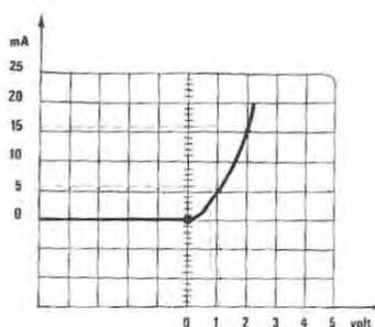
Fig. 7 Per un diodo rivelatore al germanio abbiamo una caduta irrisoria se la corrente che scorre nel diodo risulta inferiore a 1 mA; tale caduta però sale a 1 volt con correnti di circa 5 mA e a 2 volt con 15 mA.
