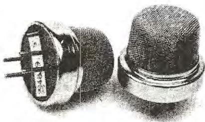
**Fig. 7** Le sonde rivelatrici da noi fornite sono universali, cioè sensibili a tutti i gas velenosi o esplosivi, quindi consigliamo di non sostituirle con altre similari anche se meno costose, perché queste ultime hanno una gamma di sensibilità più ristretta.
