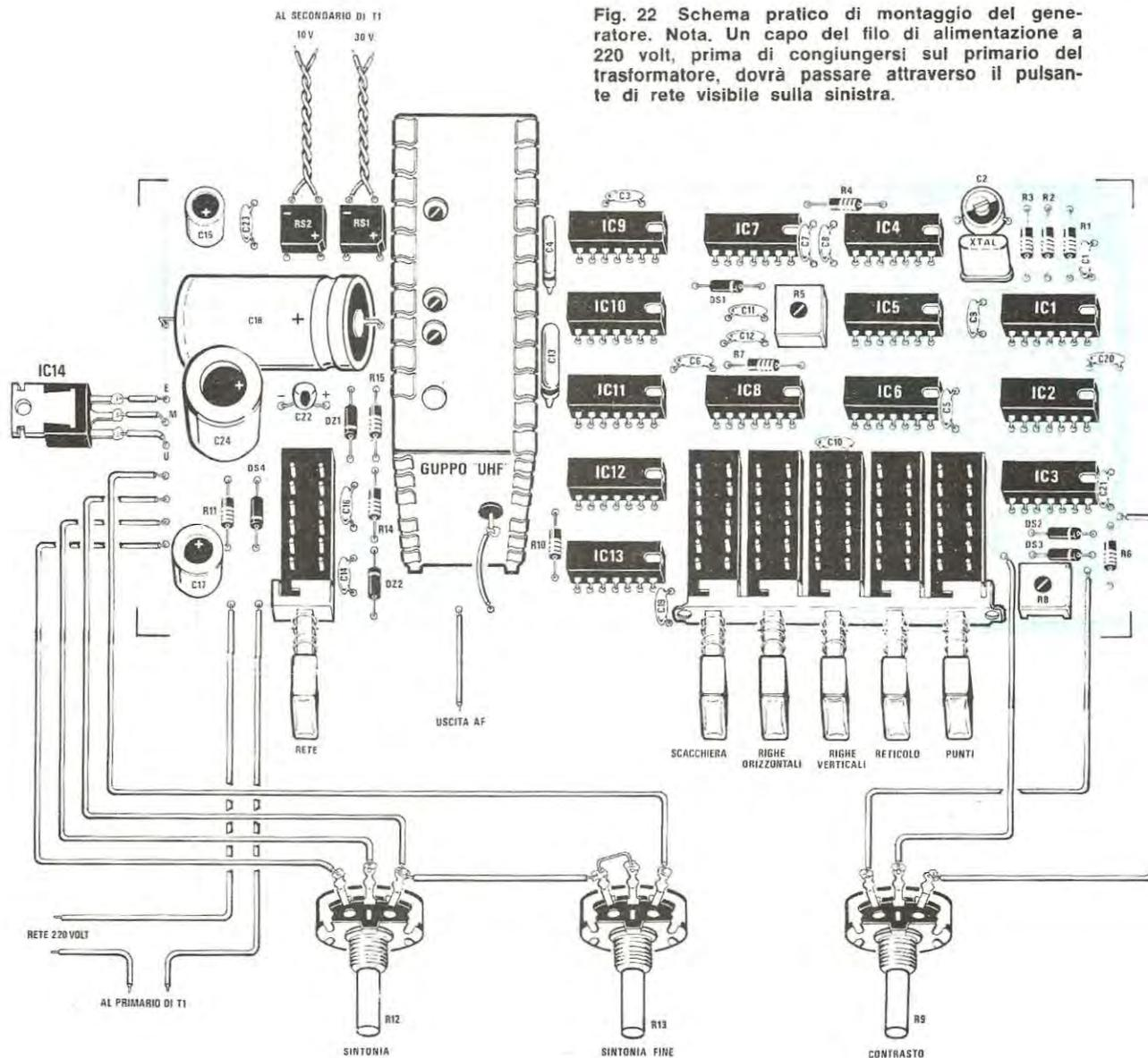
Fig. 22 Schema pratico di montaggio del generatore. Nota. Un capo del filo di alimentazione a 220 volt, prima di congiungersi sul primario del trasformatore, dovrà passare attraverso il pulsante di rete visibile sulla sinistra.
