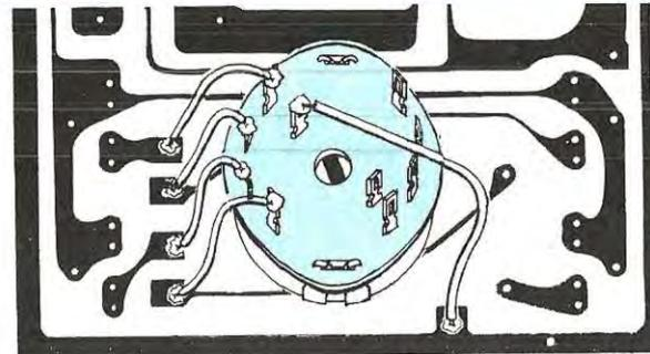
Fig. 7 I terminali del commutatore S2 andranno collegati con dei corti spezzi di filo sulle piste del circuito stampato come appare chiaramente visibile in questo disegno.
