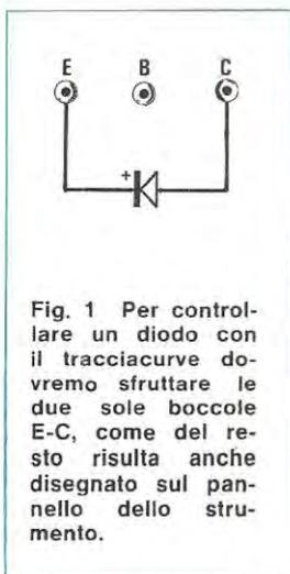
Fig. 1 Per controllare un diodo con il tracciacurve dovremo sfruttare le due sole boccole E-C, come del resto risulta anche disegnato sul pannello dello strumento.
