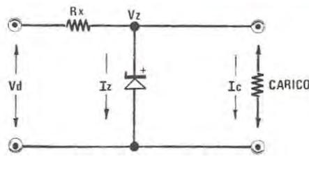
Fig. 14 Come spiegato nell'articolo, per far scorrere attraverso il diodo zener la corrente più idonea per la miglior stabilizzazione, è necessario conoscere quanti milliampere assorbirà il carico che dovremo stabilizzare.
