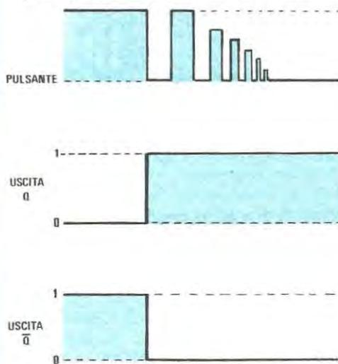
Fig. 6 Il vantaggio di un flip-flop è quello di risultare insensibile agli impulsi di rimbalzo sempre presenti nei contatti meccanici.
