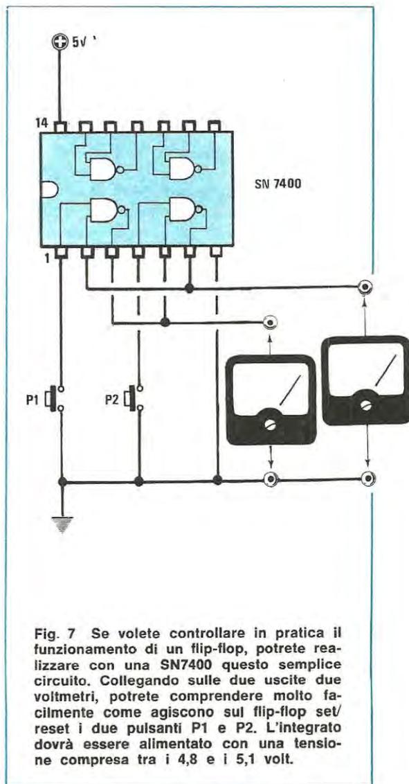
Fig. 7 Se volete controllare in pratica il funzionamento di un flip-flop, potrete realizzare con una SN7400 questo semplice circuito. Collegando sulle due uscite due voltmetri, potrete comprendere molto facilmente come agiscono sul flip-flop set/reset i due pulsanti P1 e P2. L'integrato dovrà essere alimentato con una tensione compresa tra i 4,8 e i 5,1 volt.
