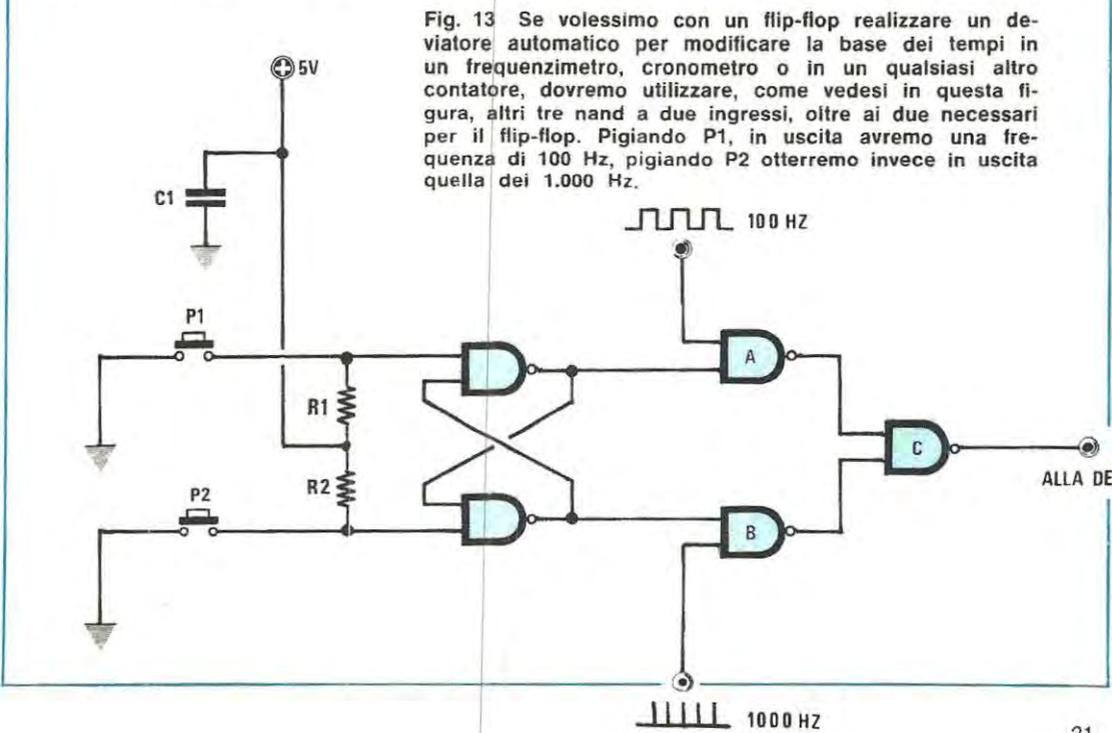
Fig. 13 Se volessimo con un flip-flop realizzare un deviatore automatico per modificare la base dei tempi in un frequenzimetro, cronometro o in un qualsiasi altro contatore, dovremo utilizzare, come vedesi in questa figura, altri tre nand a due ingressi, oltre ai due necessari per il flip-flop. Pigiando P1, in uscita avremo una frequenza di 100 Hz, pigiando P2 otterremo invece in uscita quella dei 1.000 Hz.
