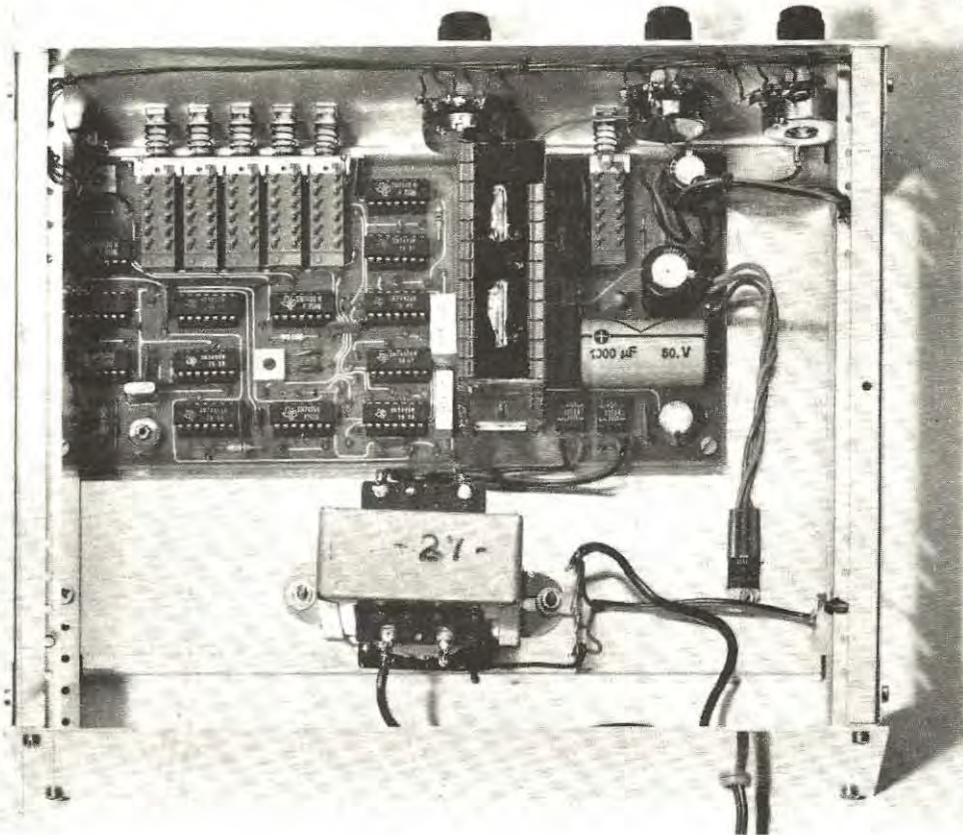
**Fig. 21** Come verrà montato nell'interno del mobile, il circuito stampato del generatore di barre. Si noti la posizione del trasformatore di alimentazione e l'integrato uA. 7805 (a destra) fissato sul pannello di sostegno orizzontale.
