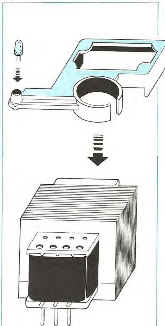
Fig. 6 Nel kit troverete un supporto in plastica simile a quello disegnato in alto, che infilato sul trasformatore T1, servirà da sostegno per il diodo led e per l'altoparlante, il cui magnete si innesterà nel vano circolare. Nell'inserire il trasformatore sul circuito stampato non potrete incorrere in nessun errore, in quanto il lato provvisto di tre terminali è, come intuibile, il secondario a bassa tensione.
