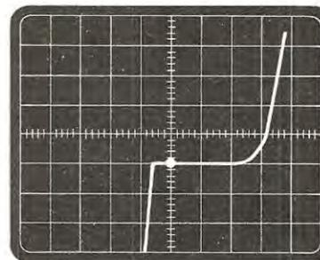
Fig. 10 Se inseriremo sulle boccole del tracciacurve il diodo zener in senso opposto a quella consigliato in fig. 1, sullo schermo dell'oscilloscopio apparirà una figura rovesciata rispetto a quella presentata in fig. 9.
