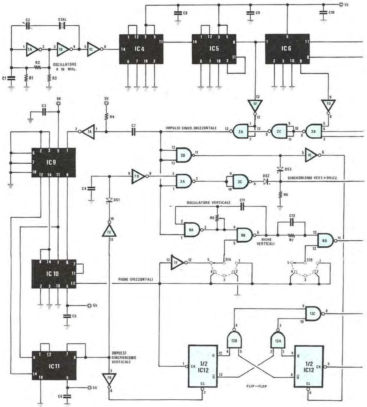
Fig. 1 Schema elettrico completo del generatore di barre TV. La lista dei componenti è riportata nella pagina seguente.
