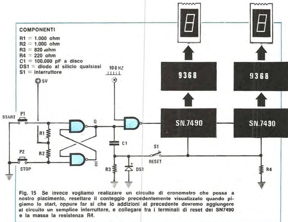
giungere il contatore e contemporaneamente, tramite il condensatore C1, si otterrà un impulso positivo che verrà applicato ai terminali 2 e 3 dell'SN7490, azzerrandolo. Perciò, ogniqualvolta pigieremo P1, il conteggio, come si comprenderà, ripartirà sempre e solo da zero.
