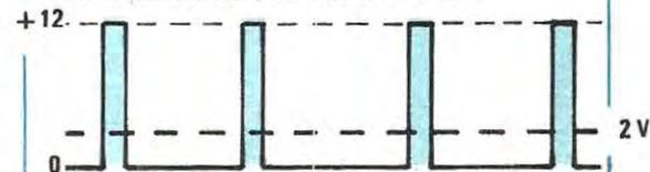
Fig. 8 Se il tempo di pausa è notevolmente maggiore rispetto a quello di erogazione la tensione efficace di utilizzo può passare da 12 volt a soli 2 volt come indicato in disegno.
