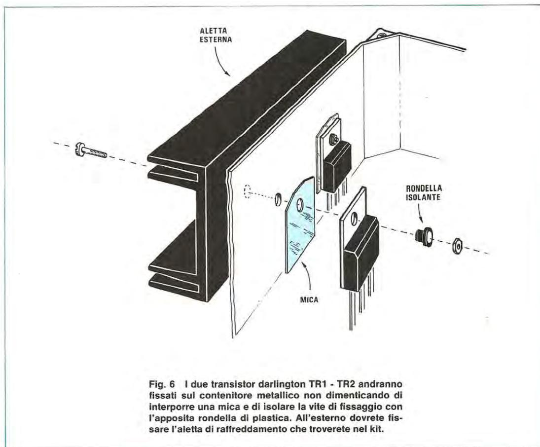
**Fig. 6** I due transistor darlington TR1 - TR2 andranno fissati sul contenitore metallico non dimenticando di interporre una mica e di isolare la vite di fissaggio con l'apposita rondella di plastica. All'esterno dovrete fissare l'aletta di raffreddamento che troverete nel kit.
