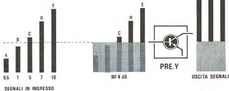
**Fig. 2** A parità di guadagno, un preamplificatore che disponga di una cifra di rumore più bassa (per esempio 4 dB contro i 10 dB di fig. 1) ci permetterà sempre di ottenere maggiori vantaggi infatti anche i segnali più deboli riusciranno a superare la soglia di rumore in ingresso e ad essere quindi amplificati.
