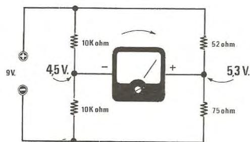
**Fig. 2** Se le due resistenze del braccio destro o sinistro differiscono tra di loro anche di pochi ohm, il ponte risulterà sbilanciato, e lo strumento ci indicherà la differenza di tensione esistente fra i due bracci.
