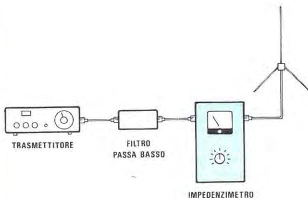
**Fig. 8** Se non riuscissimo, anche modificando la lunghezza dell'antenna, ad ottenere i 52 ohm richiesti, significa che il trasmettitore eroga una eccessiva quantità di frequenze armoniche. Per eliminarle occorrerà inserire come vedesi in figura un filtro passa basso. Leggere articolo sul N. 60/61.
