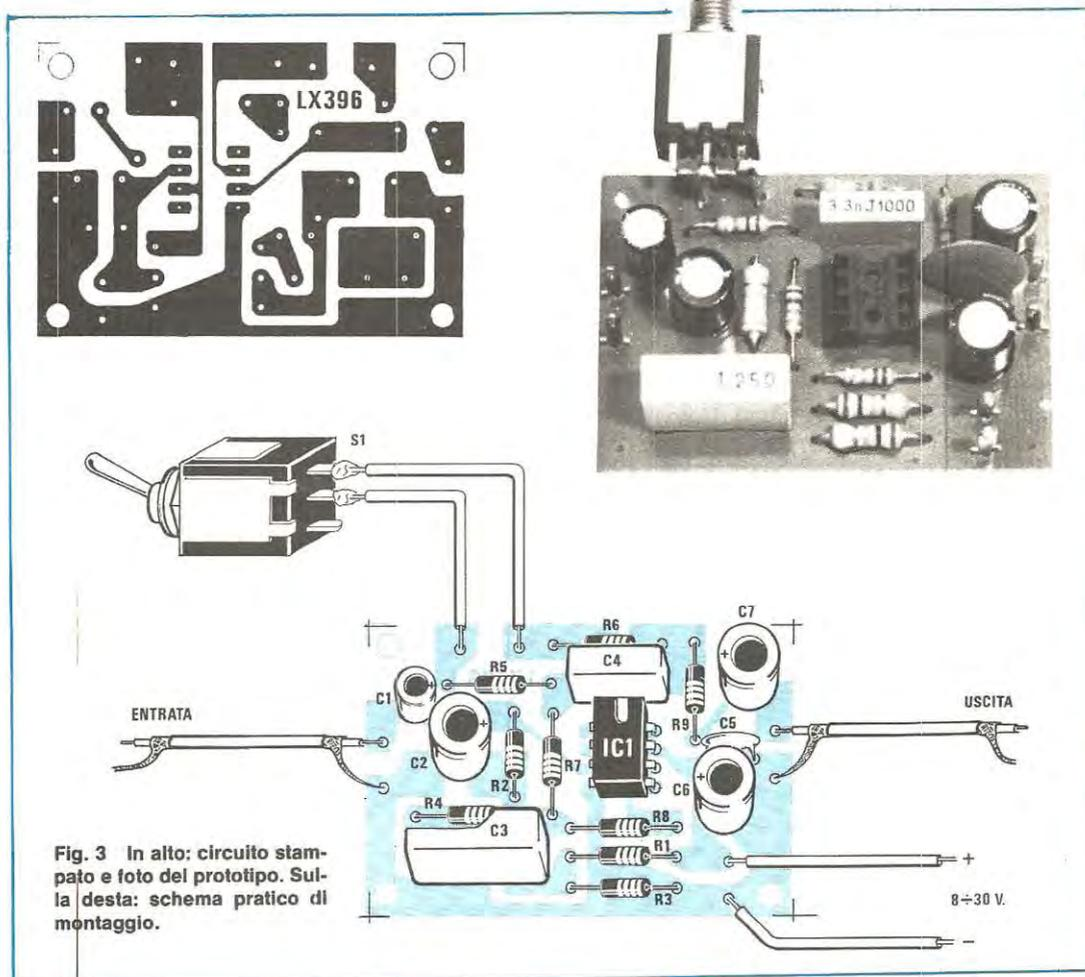
**Fig. 3** In alto: circuito stampato e foto del prototipo. Sulla destra: schema pratico di montaggio.
