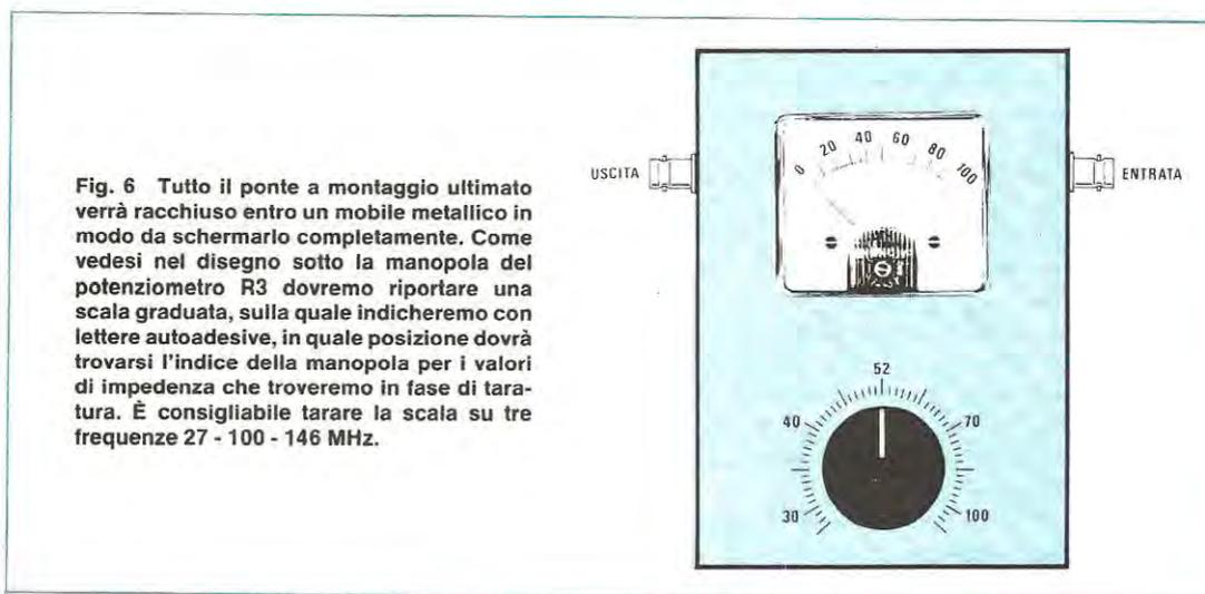
**Fig. 6** Tutto il ponte a montaggio ultimato verrà racchiuso entro un mobile metallico in modo da schermarlo completamente. Come vedesi nel disegno sotto la manopola del potenziometro R3 dovremo riportare una scala graduata, sulla quale indicheremo con lettere autoadesive, in quale posizione dovrà trovarsi l'indice della manopola per i valori di impedenza che troveremo in fase di taratura. È consigliabile tarare la scala su tre frequenze 27 - 100 - 146 MHz.
