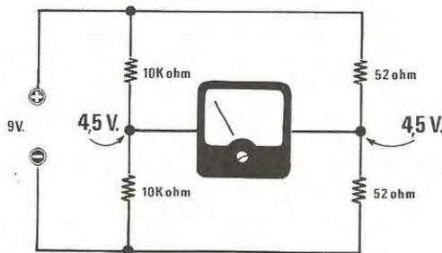
**Fig. 1** In un ponte resistivo se le due resistenze poste in serie fra di loro nel braccio di sinistra sono di identico valore e lo stesso dicasi anche per quelle poste sul braccio destro, lo strumento collocato fra i due « nodi » centrali ci indicherà tensione « zero ».
