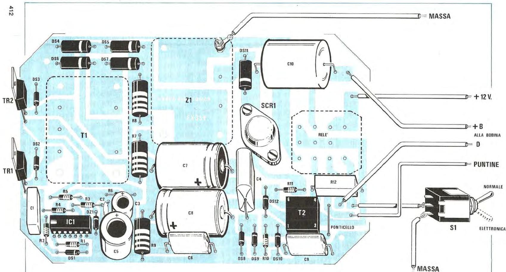
**Fig. 2** Schema pratico di montaggio. Si raccomanda di rispettare la numerazione dei piedini del trasformatore d'innesco T2 e di effettuare il ponticello con filo di rame sui due fori posti davanti sempre a T2. I terminali + B e D vanno collegati alla bobina AT.
