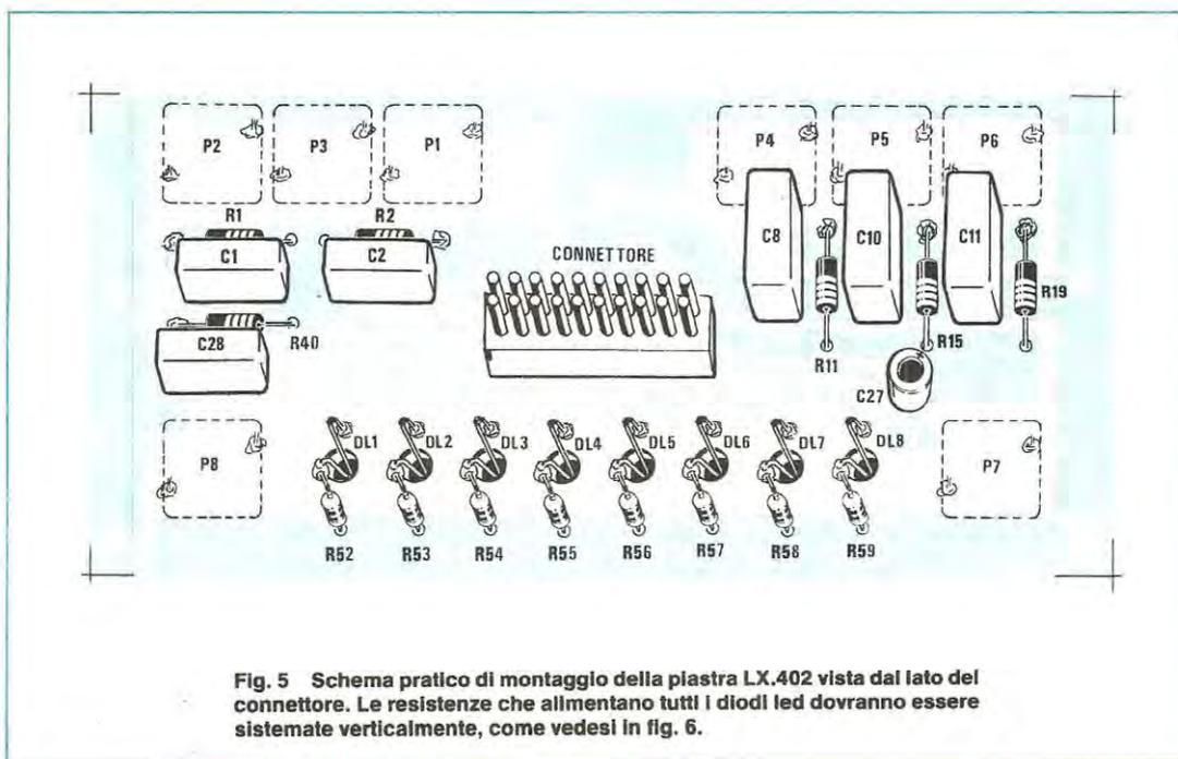
**Fig. 5** Schema pratico di montaggio della piastra LX.402 vista dal lato del connettore. Le resistenze che alimentano tutti i diodi led dovranno essere sistemate verticalmente, come vedesi in fig. 6.
