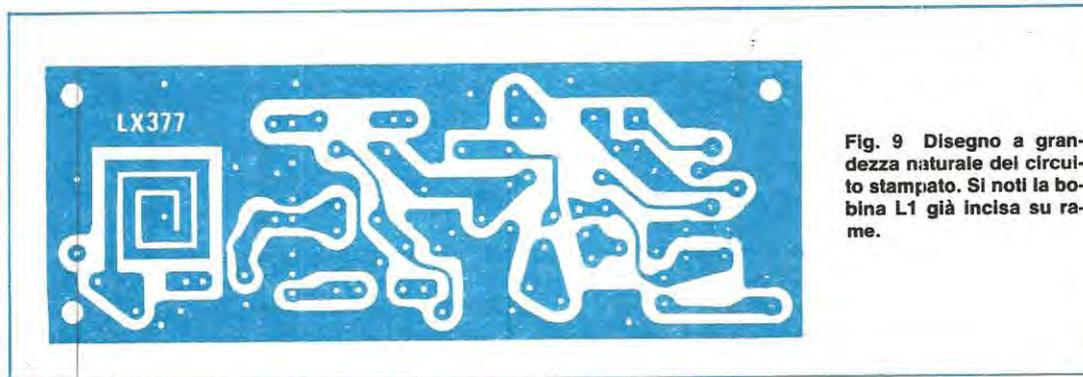
Fig. 9 Disegno a grandezza naturale del circuito stampato. Si noti la bobina L1 già incisa su rame.
