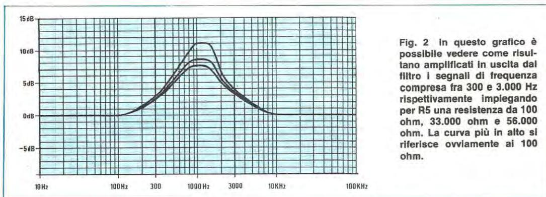
Fig. 2 In questo grafico è possibile vedere come risultano amplificati in uscita dal filtro i segnali di frequenza compresa fra 300 e 3.000 Hz rispettivamente impiegando per R5 una resistenza da 100 ohm, 33.000 ohm e 56.000 ohm. La curva più in alto si riferisce ovviamente ai 100 ohm.
