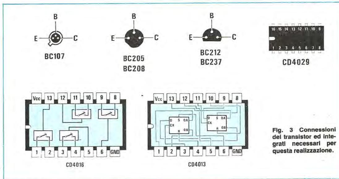
Fig. 3 Connessioni del transistor ed integrati necessari per questa realizzazione.
