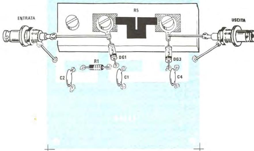
**Fig. 5** Schema pratico di montaggio del ponte AF visto dai due lati del circuito stampato. Si noti la resistenza antiinduttiva da 52 ohm (R5) e i relativi collegamenti con i bocchettoni BNC di entrata e uscita.
