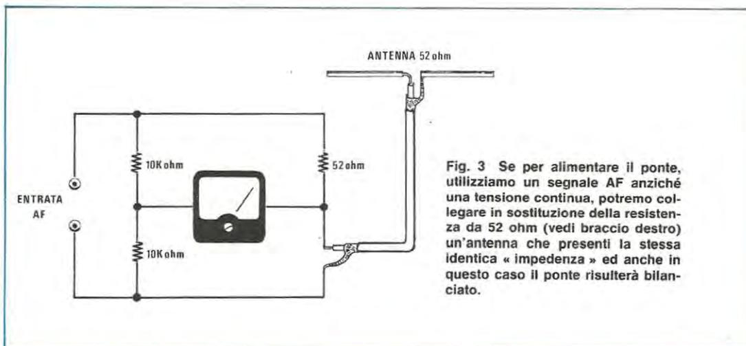
Fig. 3 Se per alimentare il ponte, utilizziamo un segnale AF anziché una tensione continua, potremo collegare in sostituzione della resistenza da 52 ohm (vedi braccio destro) un'antenna che presenti la stessa identica « impedenza » ed anche in questo caso il ponte risulterà bilanciato.
