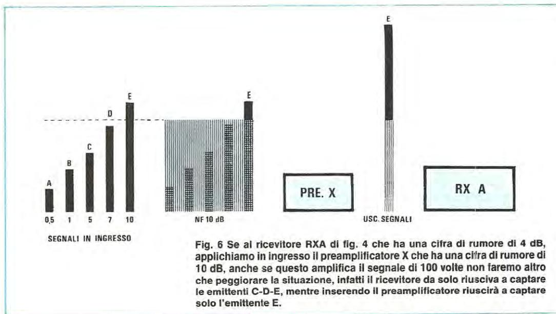
Fig. 6 Se al ricevitore RXA di fig. 4 che ha una cifra di rumore di 4 dB, applichiamo in ingresso il preamplificatore X che ha una cifra di rumore di 10 dB, anche se questo amplifica il segnale di 100 volte non faremo altro che peggiorare la situazione, infatti il ricevitore da solo riusciva a captare le emittenti C-D-E, mentre inserendo il preamplificatore riuscirà a captare solo l'emittente E.
