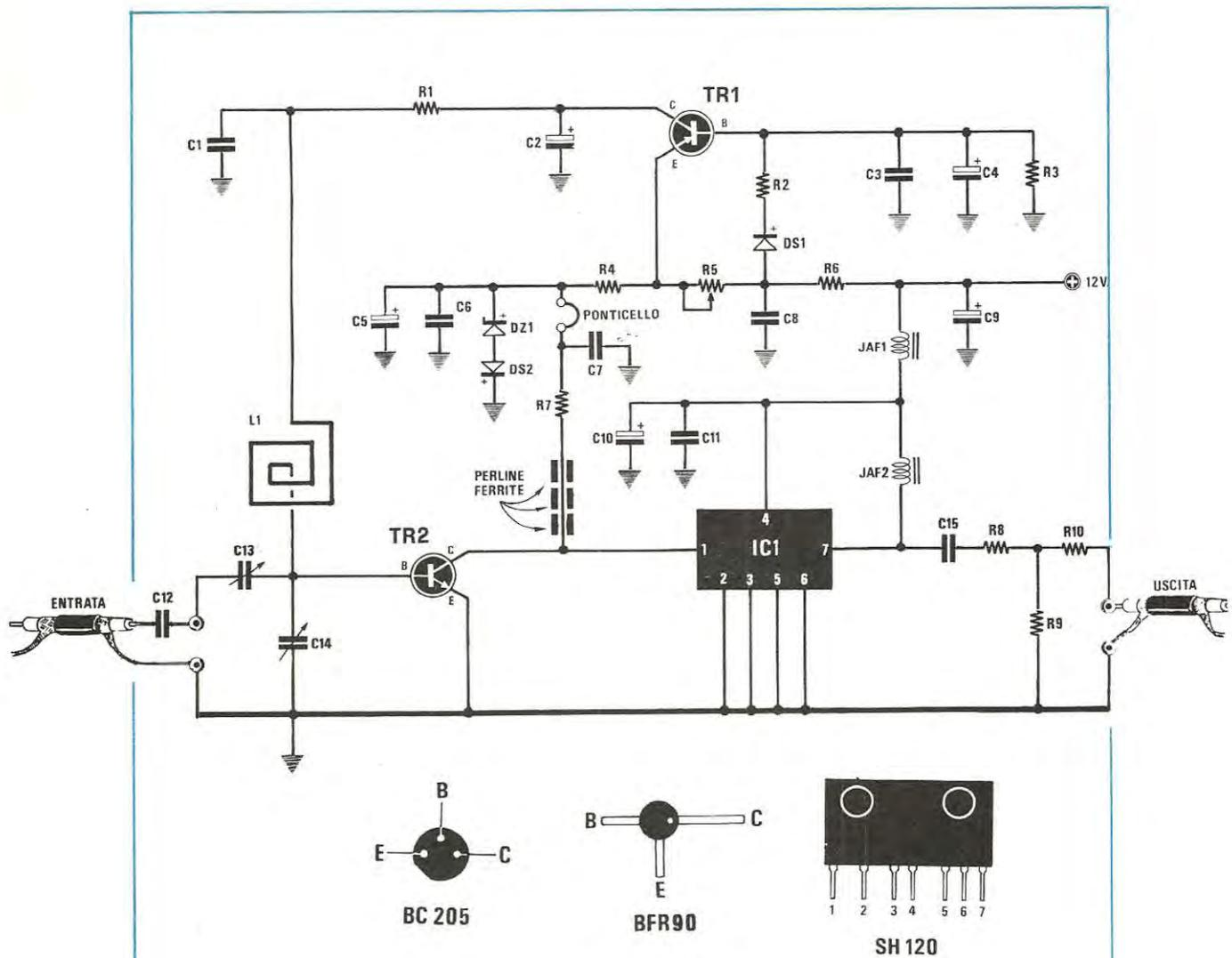
Fig. 8 Schema elettrico e connessioni dei transistor e dell'ibrido SH.120.
