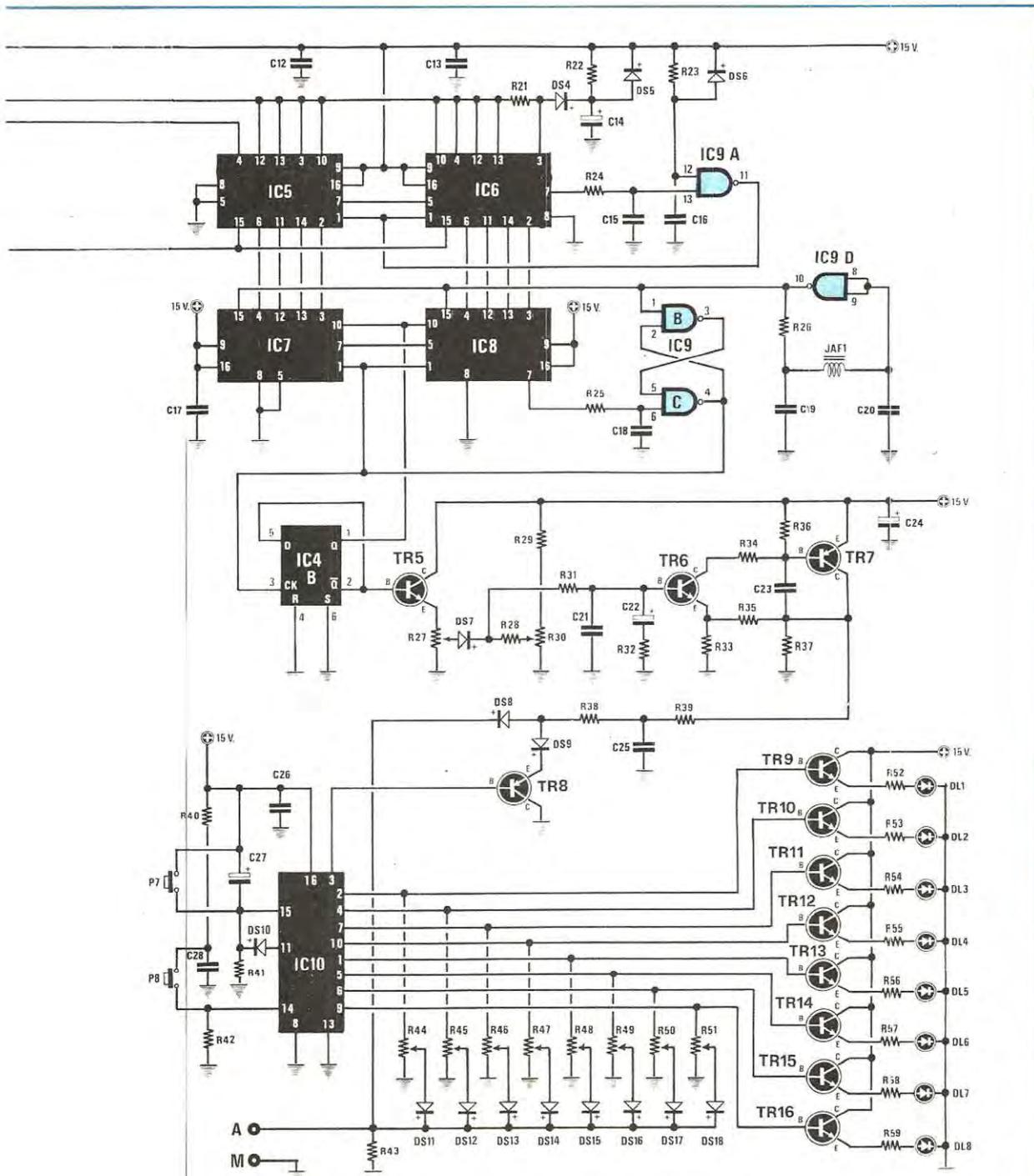
**NOTA =** Se utilizzando la sintonia elettronica, in sottofondo si ode un leggero fischio, lo potremo facilmente eliminare aumentando il valore del condensatore C.25 portandolo dagli attuali 100.000 pF a 220.000-330.000 o 470.000 pF. La massima capacità che potremo utilizzare per C.25 può raggiungere anche gli 820.000 picofarad.
