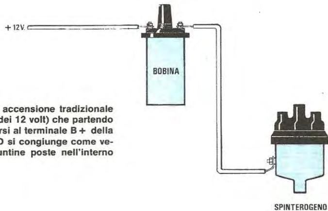
**Fig. 4** In un impianto di accensione tradizionale abbiamo un filo positivo (dei 12 volt) che partendo dal cruscotto va a collegarsi al terminale B + della bobina. L'altro terminale D si congiunge come vedesi nel disegno, alle puntine poste nell'interno dello spinterogeno.
