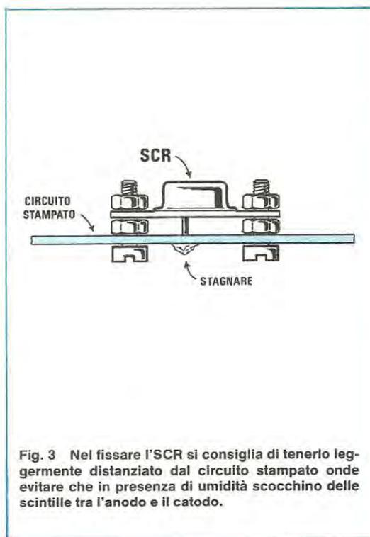
**Fig. 3** Nel fissare l'SCR si consiglia di tenerlo leggermente distanziato dal circuito stampato onde evitare che in presenza di umidità scocchino delle scintille tra l'anodo e il catodo.
