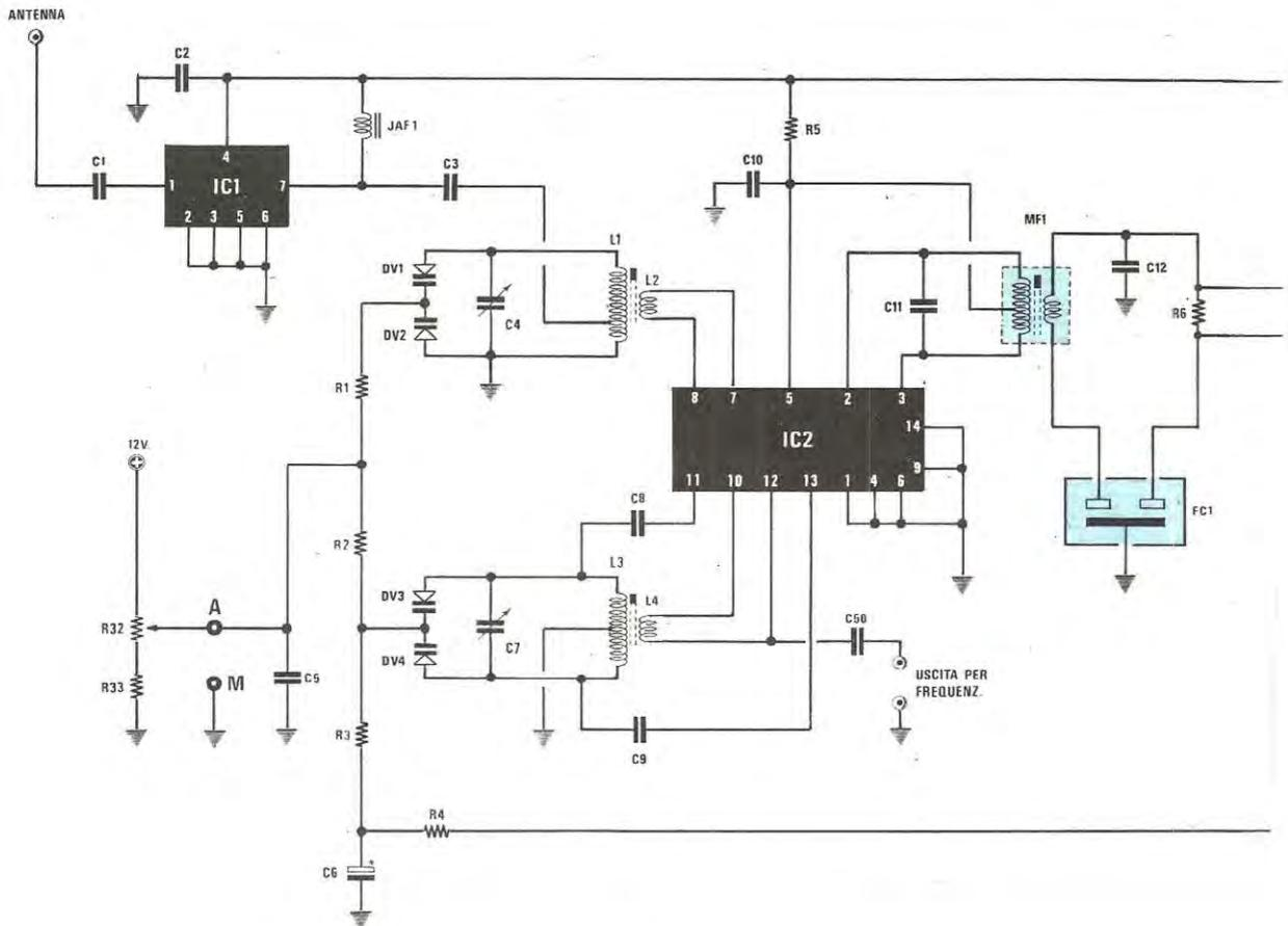
**Fig. 1** Schema elettrico del sintonizzatore FM descritto in questo articolo e del relativo alimentatore. La lista componenti è riportata nella pagina successiva. Chi volesse applicare la sintonia elettronica LX401 dovrà richiederci il trasformatore di alimentazione n. 76 che dispone di due secondari: uno da 15 volt per il sintonizzatore ed uno da 18 volt per la sintonia elettronica.
