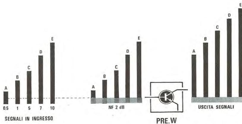
**Fig. 3** Solo realizzando un preamplificatore che abbia un guadagno di almeno 15-20 dB ed una cifra di rumore di 2-2,5 dB max potremo sensibilizzare effettivamente il nostro ricevitore ponendolo così in condizione di farci ascoltare tutte quelle emittenti che i preamplificatori di fig. 1 e fig. 2, a causa della loro soglia di rumore troppo elevata, non potevano amplificare.
