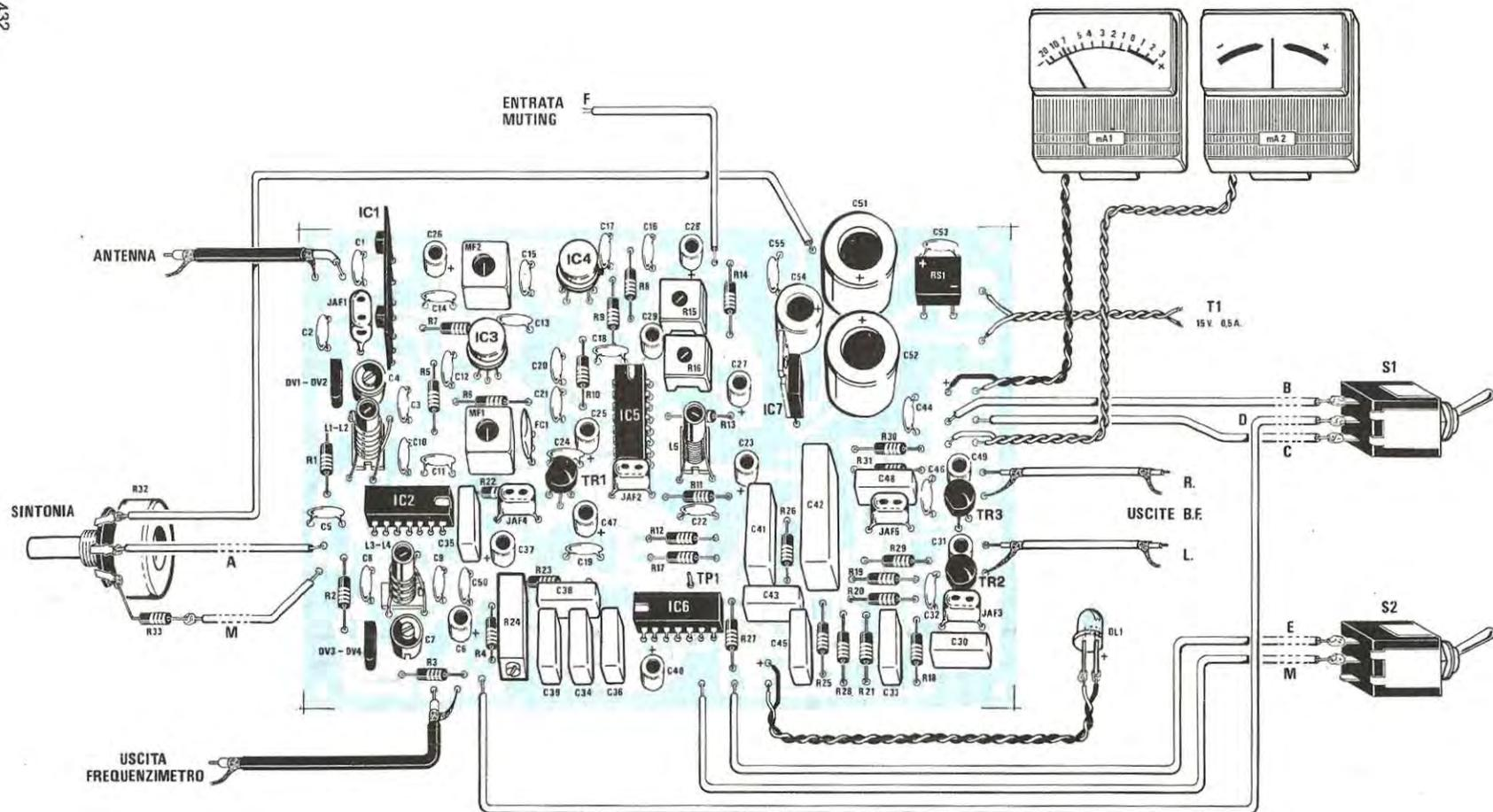
Fig. 6 Schema pratico di montaggio del sintonizzatore FM. Chi ritenesse opportuno abbinare a tale ricevitore la sintonia automatica LX401 completa di preselezione per 8 canali dovrà eliminare da questo circuito il potenziometro R32 e i deviatori S1, S2 e collegare i terminali A-M B-C-D EM e F ai corrispondenti terminali presenti su tale circuito stampato.
