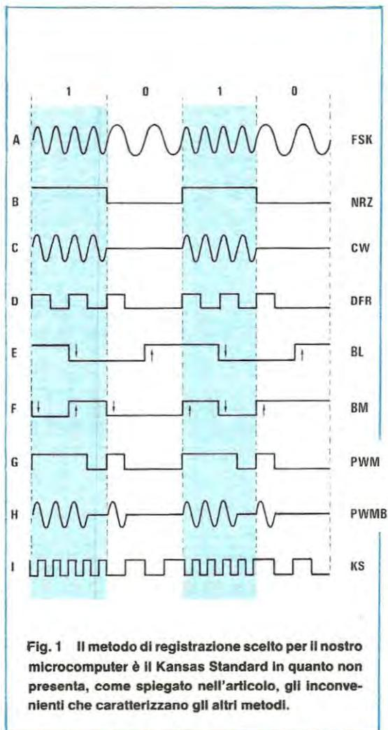
**Fig. 1** Il metodo di registrazione scelto per il nostro microcomputer è il Kansas Standard in quanto non presenta, come spiegato nell'articolo, gli inconvenienti che caratterizzano gli altri metodi.
