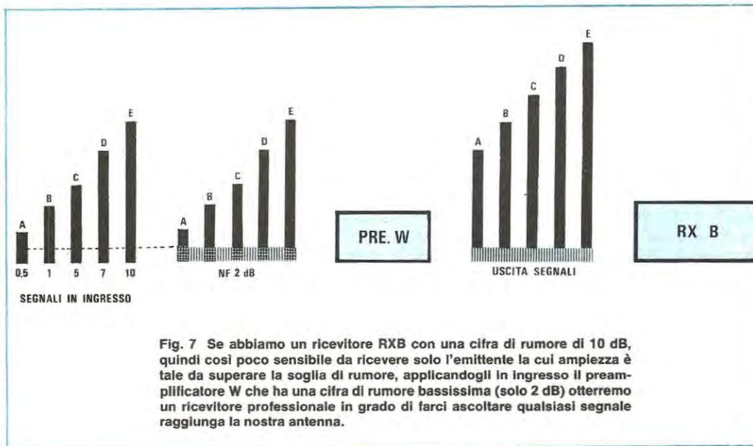
Fig. 7 Se abbiamo un ricevitore RXB con una cifra di rumore di 10 dB, quindi così poco sensibile da ricevere solo l'emittente la cui ampiezza è tale da superare la soglia di rumore, applicandogli in ingresso il preamplificatore W che ha una cifra di rumore bassissima (solo 2 dB) otterremo un ricevitore professionale in grado di farci ascoltare qualsiasi segnale raggiunga la nostra antenna.
