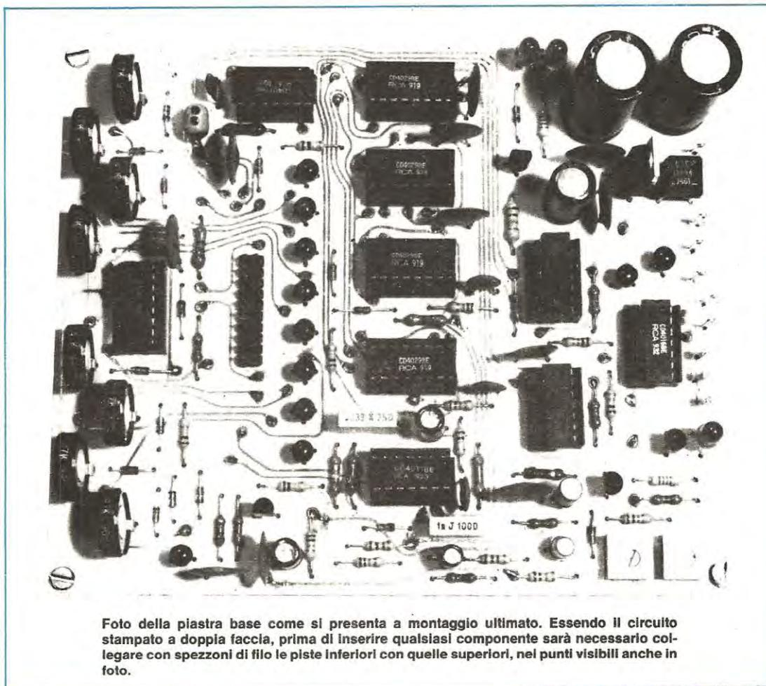
Foto della piastra base come si presenta a montaggio ultimato. Essendo il circuito stampato a doppia faccia, prima di inserire qualsiasi componente sarà necessario collegare con spezzoni di filo le piste inferiori con quelle superiori, nei punti visibili anche in foto.
