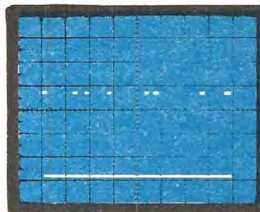
Fig. 7 Ruotando il trimmer da 50.000 ohm dovete cercare di « eliminare » l'onda quadra e quando vedrete solo dei puntini in alto significa che sarete vicinissimi al punto di taratura.
