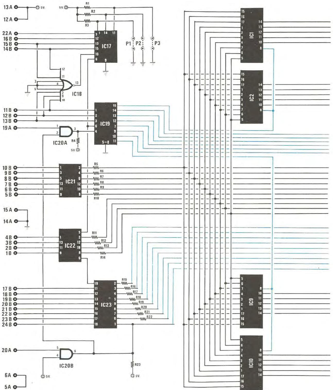
Fig. 1 Schema elettrico espansione memoria da 8 K.
