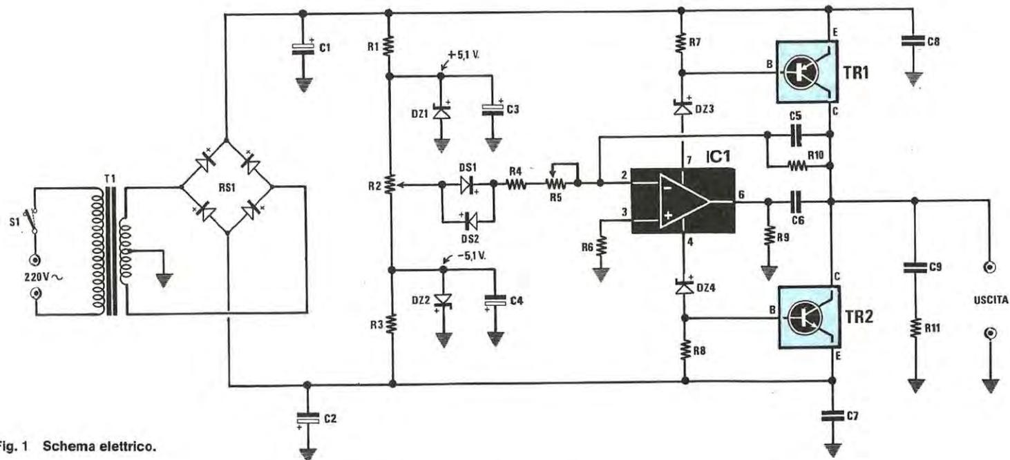
Fig. 1 Schema elettrico.
